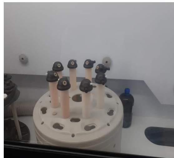
Se colocó en los tubos de teflón del digestor por microondas
