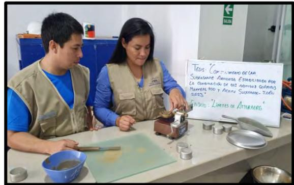
Imagen N° 02: Se pasa el ranurador y procede a realizar los números de golpes. se lleva al horno y se deja por 24 horas, después se deja enfriar y se pesa.
