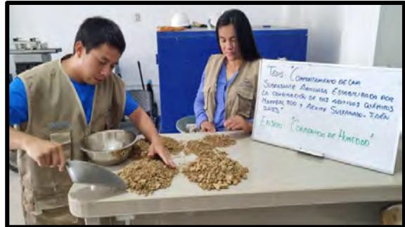
Imagen N° 02: Introducir al horno a 110 °C durante 24 horas.
