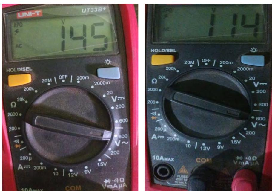
Según lo medido en campo, realizamos en cálculo para obtener la perdida de voltaje y a la vez obtener el porcentaje de caída de tensión que tienen dichas redes eléctricas.
