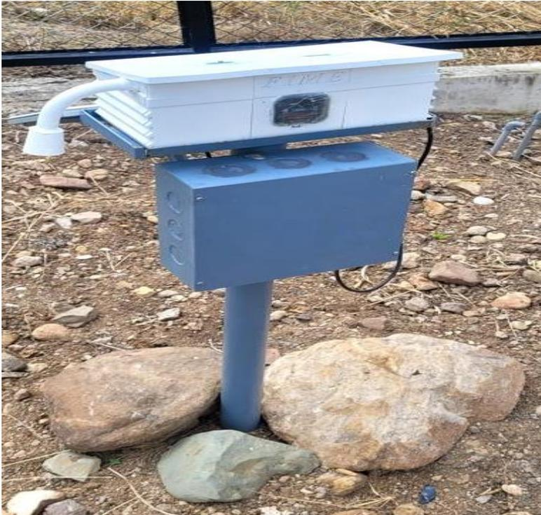
En la Figura 39, se muestra la configuración final del prototipo de estación meteorológica, el cual fue ensamblado sobre una base metálica resistente a la intemperie, considerando la exposición prolongada al sol, la lluvia y el polvo. Esta estructura no solo protege los componentes electrónicos, sino que también garantiza una correcta captación de datos sin interferencias mecánicas o ambientales.
