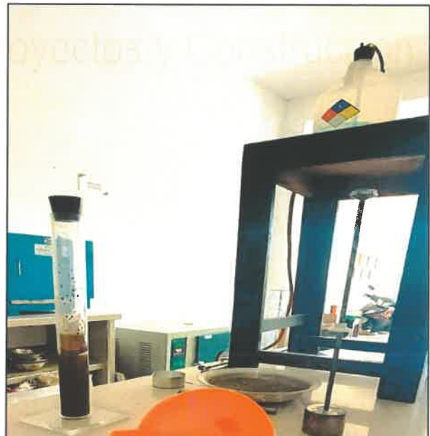
FOTO N° 24: ENSAYO PARA DETERMINAR EL EQUIVALENTE DE ARENA PARA CALICATA 2
