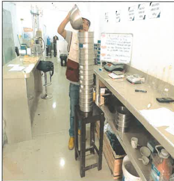
FOTO N° 10: ENSAYO DE ANÁLISIS GRANULOMÉTRICO PARA CALICATA 2 (TAMIZADO DE MUESTRA)
