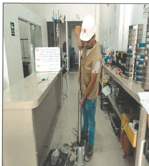
FOTO N° 48: ENSAYO DE CBR - PARA M3 + 8.5% DE C.P.M.P.L. A 150 °C
