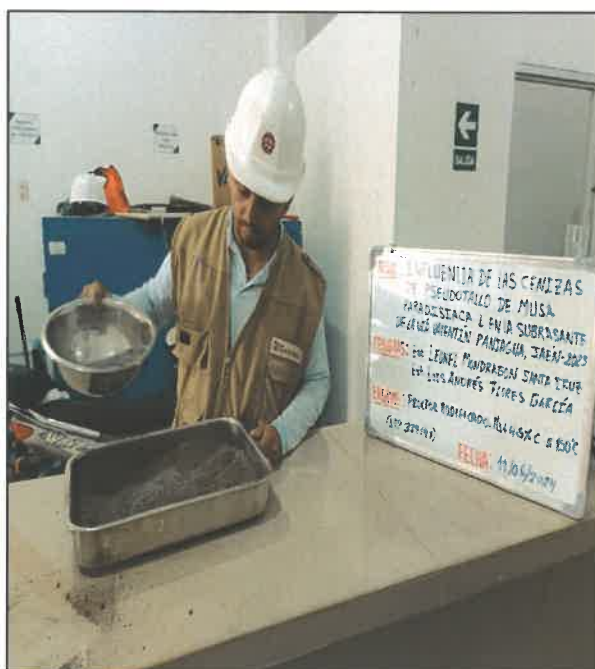
FOTO N° 34: ENSAYO DE PROCTOR MODIFICADO PARA M3 + 4.5% DE C.P.M.P.L. A 150 °C
