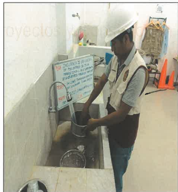
FOTO N° 08: ENSAYO DE ANÁLISIS GRANULOMÉTRICO PARA CALICATA 2 (LAVADO DE MUESTRA)
