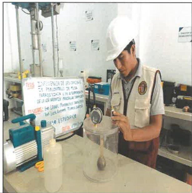
FOTO N° 18: ENSAYO PARA DETERMINAR EL PESO ESPECÍFICO PARA CALICATA 2
