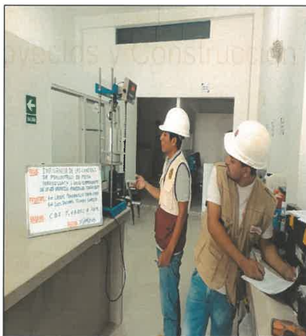
FOTO N° 40: ENSAYO DE CBR - PARA M1 + 8.5% DE C.P.M.P.L. A 100 °C
