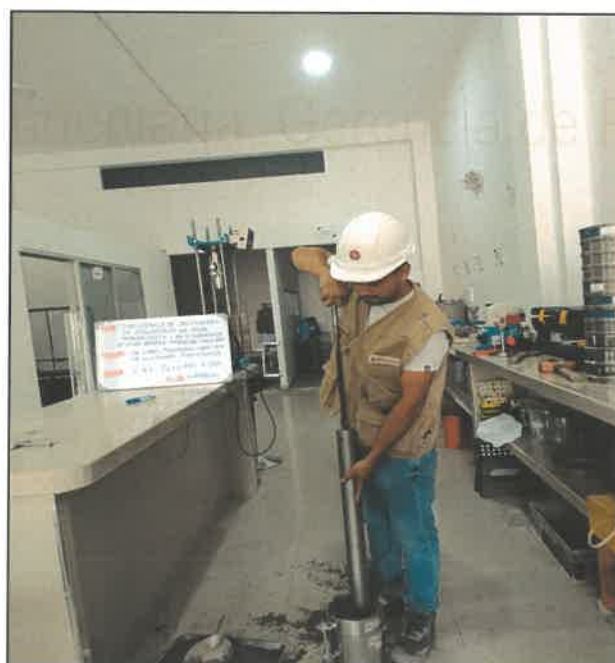
FOTO N° 47: ENSAYO DE CBR - PARA M3 + 6.5% DE C.P.M.P.L. A 150 °C
