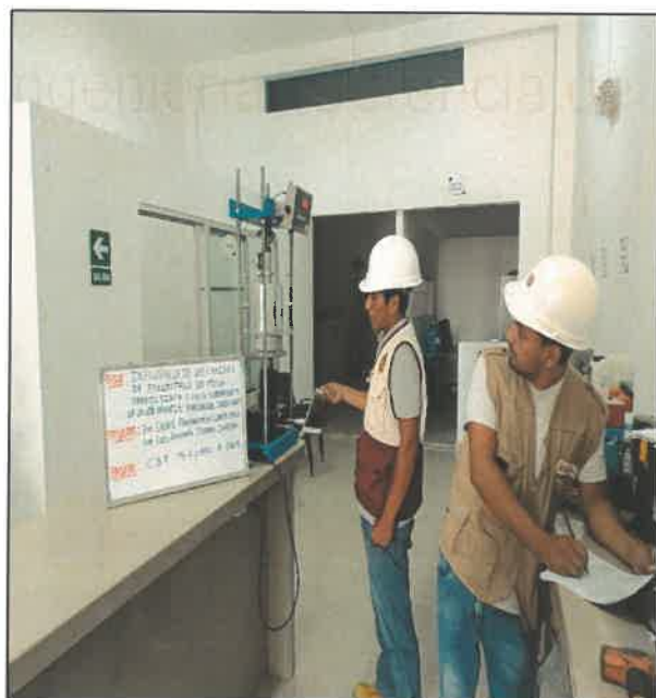
FOTO N° 43: ENSAYO DE CBR – PARA M2 + 6.5% DE C.P.M.P.L. A 120 °C
