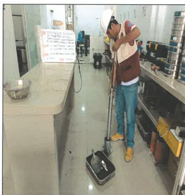
FOTO N° 32: ENSAYO DE PROCTOR MODIFICADO PARA M2 + 8.5% DE C.P.M.P.L. A 120 °C
