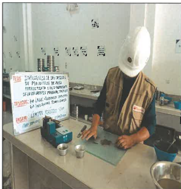
FOTO N° 13: ENSAYO DE LÍMITE PLÁSTICO PARA CALICATA 1
