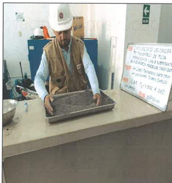
FOTO N° 44: ENSAYO DE CBR – PARA M2 + 8.5% DE C.P.M.P.L. A 120 °C
