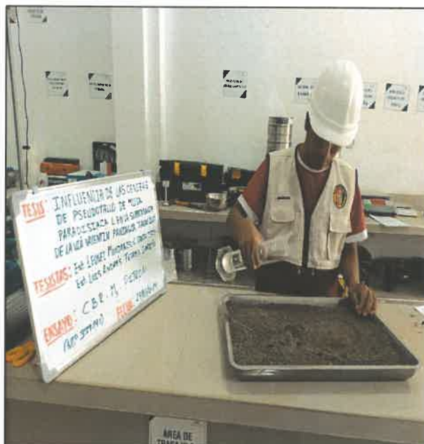
FOTO N° 45: ENSAYO DE CBR - PARA M3 - PATRON
