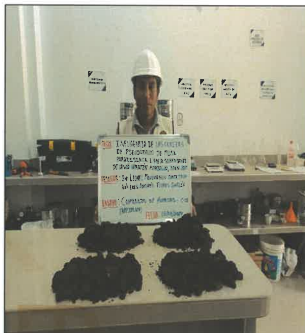
FOTO N° 02: CUARTEO DE MUESTRA PARA CALICATA 2.
