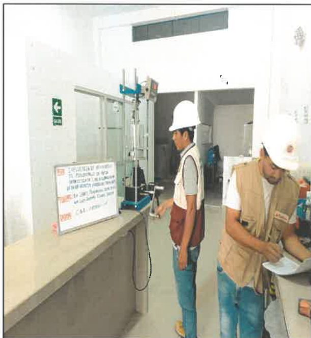
FOTO N° 37: ENSAYO DE CBR - PARA M1 - PATRON
