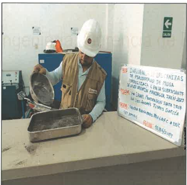
FOTO N° 27: ENSAYO DE PROCTOR MODIFICADO PARA PARA M1 + 6.5% DE C.P.M.P.L. A 100 °C
