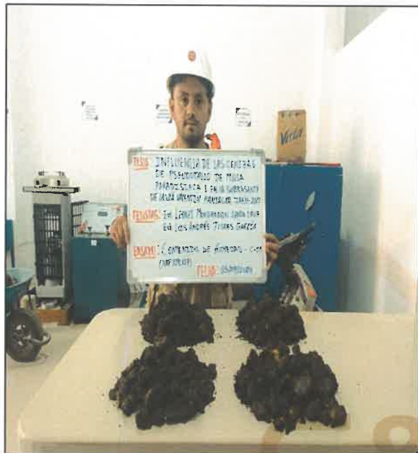
FOTO N° 01: CUARTEO DE MUESTRA PARA CALICATA 1.
