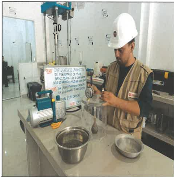
FOTO N° 17: ENSAYO PARA DETERMINAR EL PESO ESPECÍFICO PARA CALICATA 1
