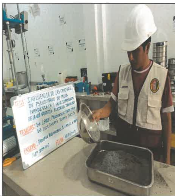
FOTO N° 26: ENSAYO DE PROCTOR MODIFICADO PARA M1 + 4.5% DE C.P.M.P.L. A 100 °C
