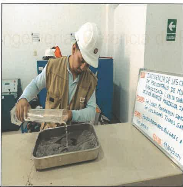
FOTO N° 35: ENSAYO DE PROCTOR MODIFICADO PARA M3 + 6.5% DE C.P.M.P.L. A 150 °C
