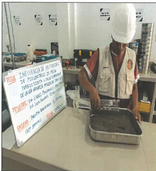
FOTO N° 33: ENSAYO DE PROCTOR MODIFICADO PARA M3 - PATRON
