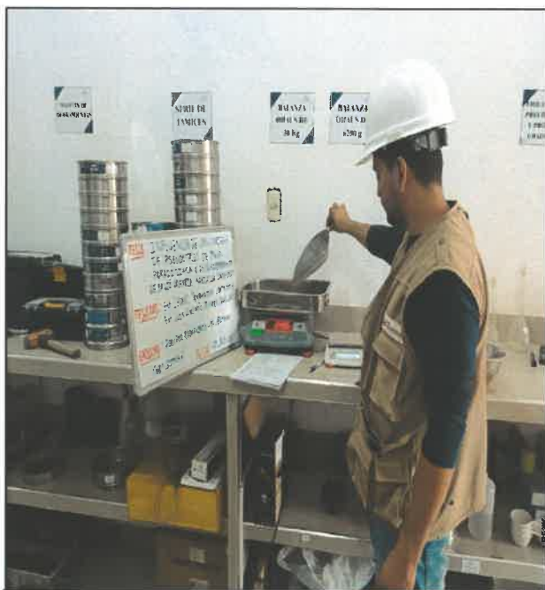
FOTO N° 25: ENSAYO DE PROCTOR MODIFICADO PARA M1 - PATRON
