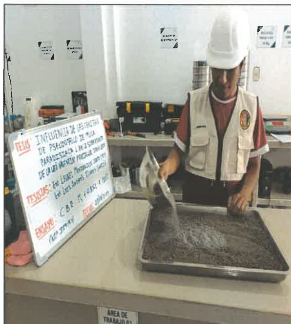
FOTO N° 38: ENSAYO DE CBR - PARA M1 + 4.5% DE C.P.M.P.L. A 100 °C
