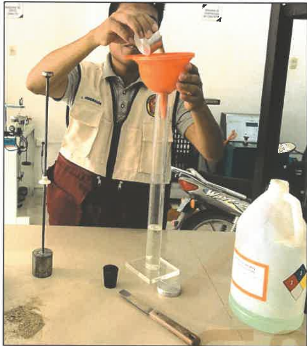
FOTO N° 21: ENSAYO PARA DETERMINAR EL EQUIVALENTE DE ARENA PARA CALICATA 2
