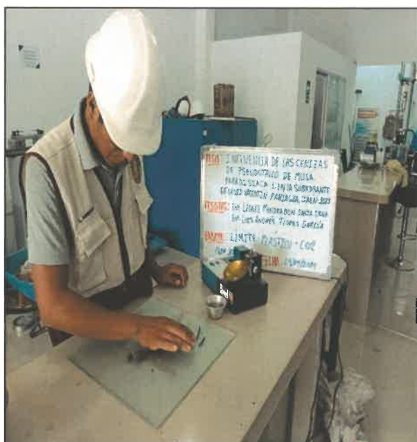
FOTO N° 14: ENSAYO DE LÍMITE PLÁSTICO PARA CALICATA 2
