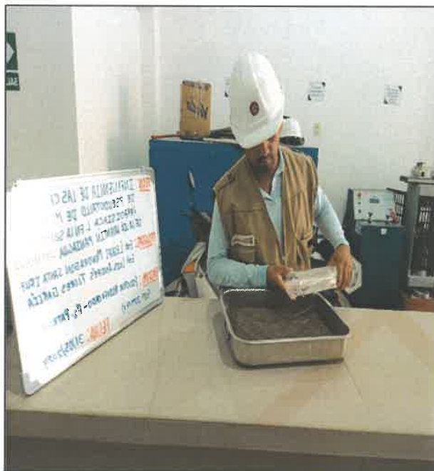
FOTO N° 29: ENSAYO DE PROCTOR MODIFICADO PARA PARA M2 - PATRON
