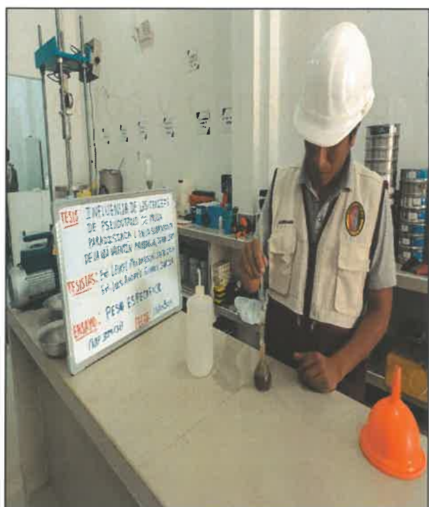
FOTO N° 20: ENSAYO PARA DETERMINAR EL PESO ESPECÍFICO PARA CALICATA 2
