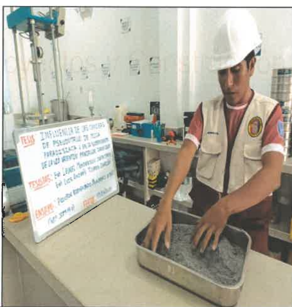
FOTO N° 36: ENSAYO DE PROCTOR MODIFICADO PARA M3 + 8.5% DE C.P.M.P.L. A 150 °C
