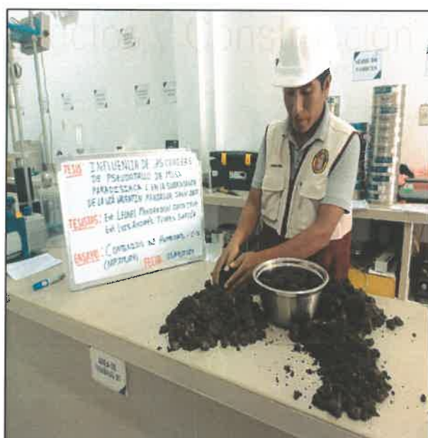
FOTO N° 04: ENSAYO DE CONTENIDO DE HUMEDAD PARA CALICATA 2
