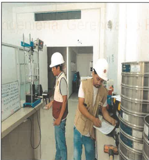
FOTO N° 39: ENSAYO DE CBR - PARA M1 + 6.5% DE C.P.M.P.L. A 100 °C
