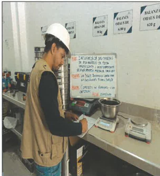
FOTO N° 05: ENSAYO DE CONTENIDO DE HUMEDAD PARA CALICATA 1 (PESADO)
