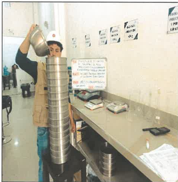
FOTO N° 09: ENSAYO DE ANÁLISIS GRANULOMÉTRICO PARA CALICATA 1 (TAMIZADO DE MUESTRA)
