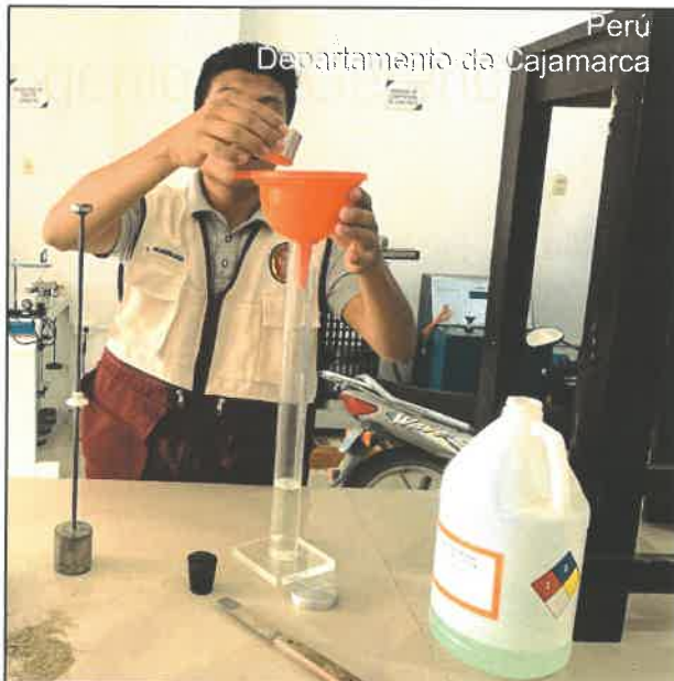
FOTO N° 23: ENSAYO PARA DETERMINAR EL EQUIVALENTE DE ARENA PARA CALICATA 2
