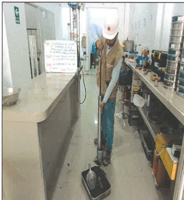
FOTO N° 30: ENSAYO DE PROCTOR MODIFICADO PARA M2 + 4.5% DE C.P.M.P.L. A 120 °C
