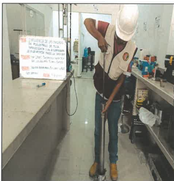
FOTO N° 31: ENSAYO DE PROCTOR MODIFICADO PARA M2 + 6.5% DE C.P.M.P.L. A 120 °C
