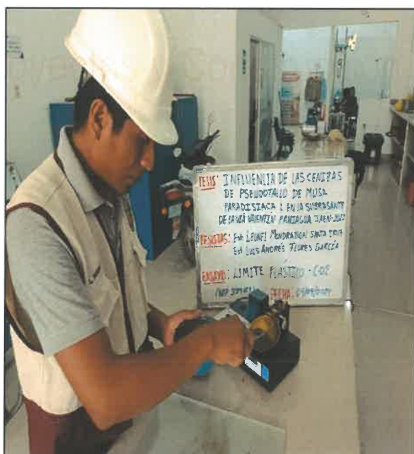
FOTO N° 12: ENSAYO DE LÍMITE LÍQUIDO PARA CALICATA 2
