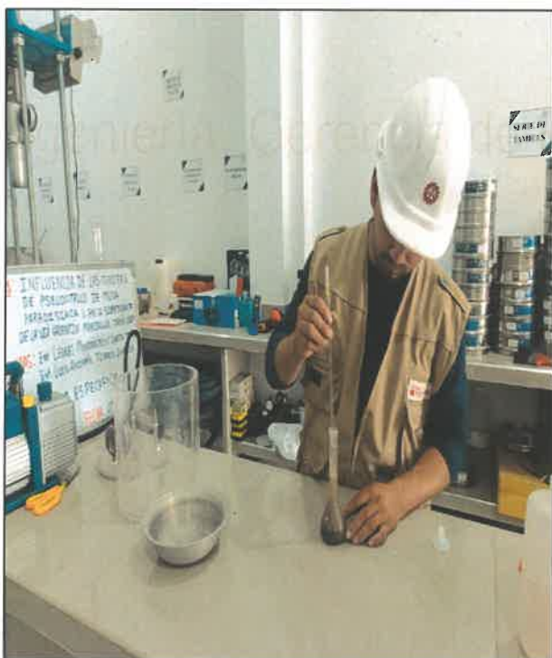
FOTO N° 19: ENSAYO PARA DETERMINAR EL PESO ESPECÍFICO PARA CALICATA 1
