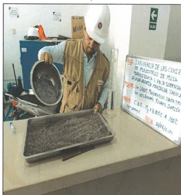
FOTO N° 46: ENSAYO DE CBR - PARA M3 + 4.5% DE C.P.M.P.L. A 150 °C
