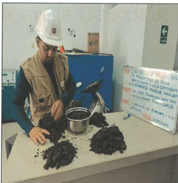
FOTO N° 03: ENSAYO DE CONTENIDO DE HUMEDAD PARA CALICATA 1
