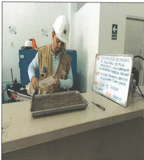
FOTO N° 41: ENSAYO DE CBR – PARA M2 - PATRON
