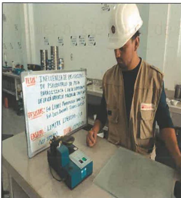
FOTO N° 11: ENSAYO DE LÍMITE LÍQUIDO PARA CALICATA 1
