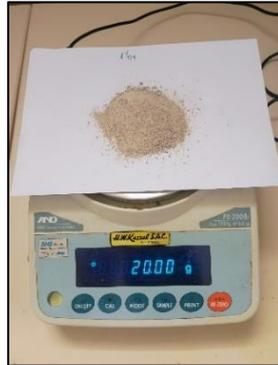
Entre los materiales utilizados fueron similares al caso anterior, esto es un pH-metro digital, soluciones buffer de calibración (pH 4.0, 7.0 y 10.0), agua destilada, vasos de precipitación de 100 mL y suelo seco tamizado a 2 mm.
