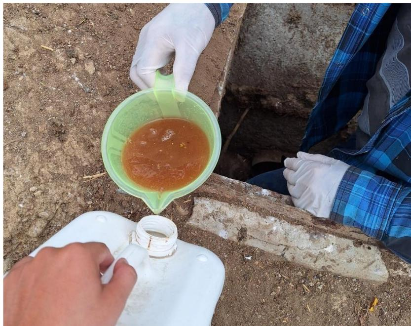
**Figura 6** *Control del pH en el estado natural del agua residual*
