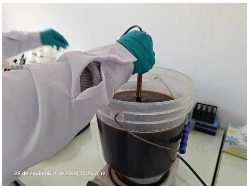
**Figura 7** Ajuste de pH con Hidróxido de Sodio (NaOH)
