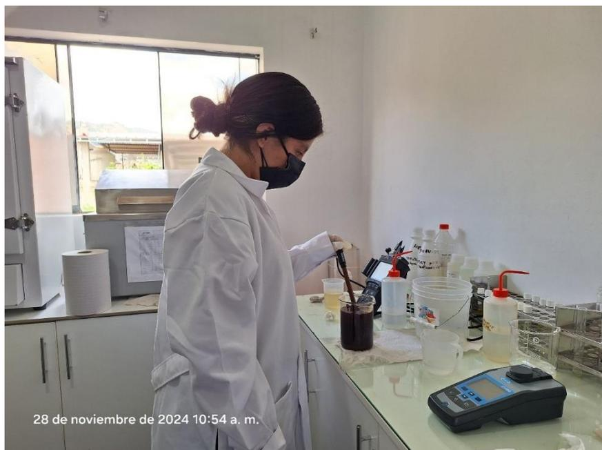
**Figura 8** Inyección del PAC a diferentes concentraciones para evaluar su eficacia
