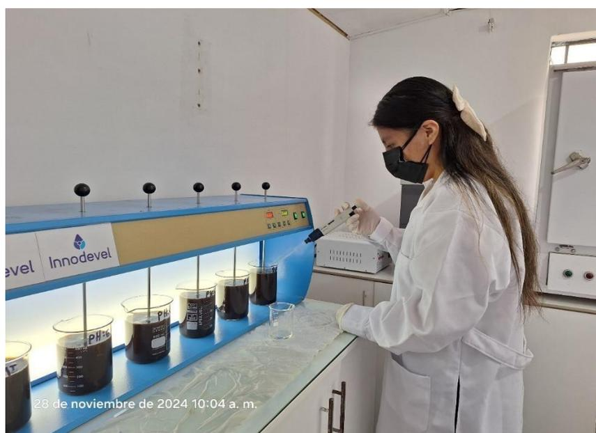
**Figura 9** Agitación de las muestras a 200 rpm por 3 minutos
