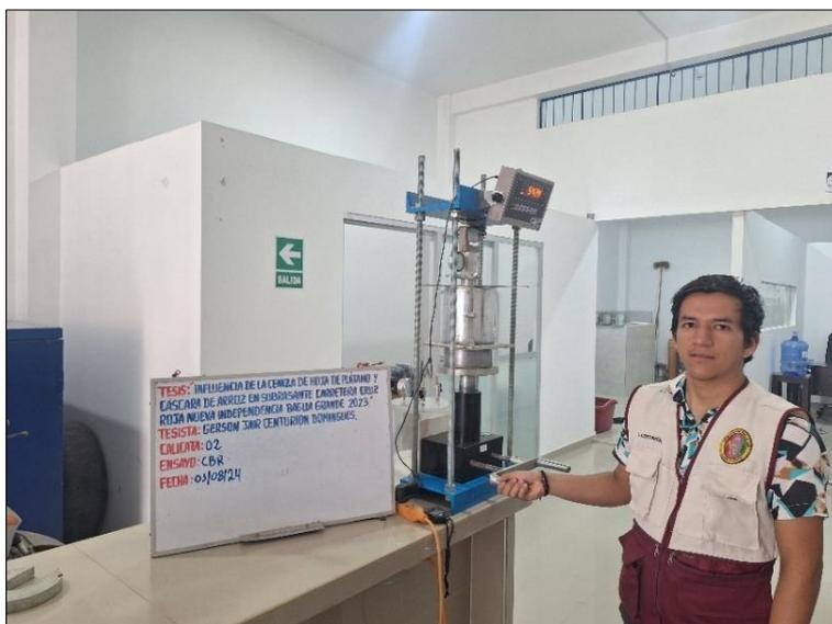
*Nota:* En la figura 10, se muestra el procedimiento del ensayo de penetración de la muestra de CBR, la cual consiste en aplicar un punzonamiento sobre la superficie del molde mediante un pistón normalizado, todos estos pasos se realizan siguiendo las pautas de la norma MTC E 132.
