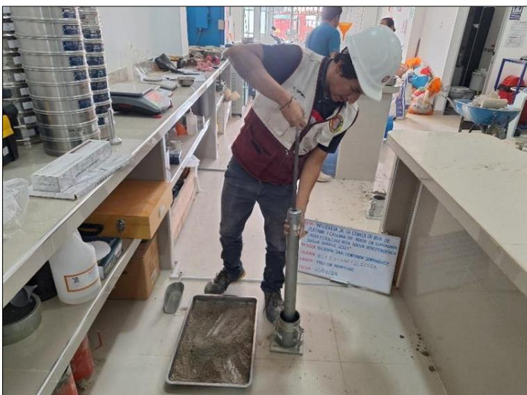
*Nota:* En la figura 15, se muestra el procedimiento del ensayo de Proctor modificado con adición de 3.5% CHP +11.5% CCA para la tercera calicata, en este caso se evidencia la compactación con un pisón en capas diferentes, esto se realizó teniendo en cuenta la norma MTC E 115.
