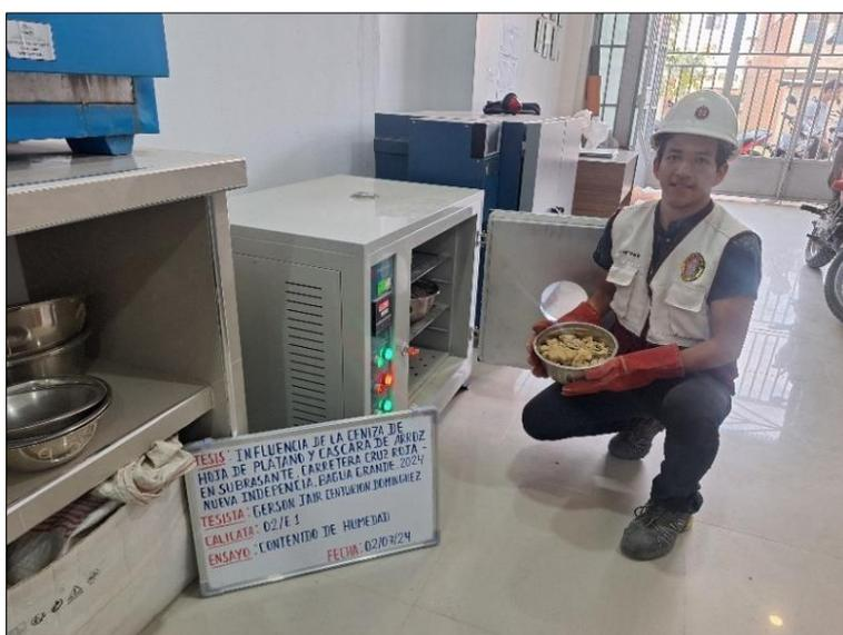
*Nota:* En la figura 5, se muestra el procedimiento para determinar el contenido de humedad del suelo, el cual se coloca la muestra pesada al horno y se lo saca durante las 24 horas, luego se pesa la muestra seca y se obtiene el contenido de humedad de acuerdo a lo establecido en la norma MTC E 108.
