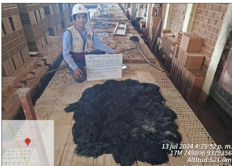
*Nota:* En la figura 4, se muestra las cenizas de cáscara de arroz obtenidas luego del proceso de quemado de la cáscara de arroz en el horno industrial a una temperatura de 750 a 800 C°, de la empresa Cerámicos Pakamuros – Ladrillos GREQ,
