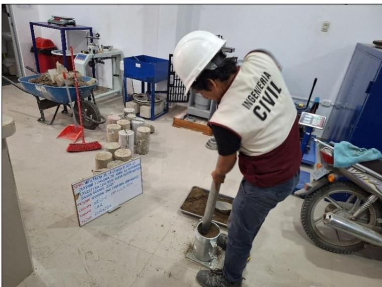
*Nota:* En la figura 16, se muestra el procedimiento del ensayo de CBR con adición de 3.5% CHP +11.5% CCA para la segunda calicata, en este caso se evidencia la compactación con un pisón en capas diferentes, esto se realizó teniendo en cuenta la norma MTC E 132.
