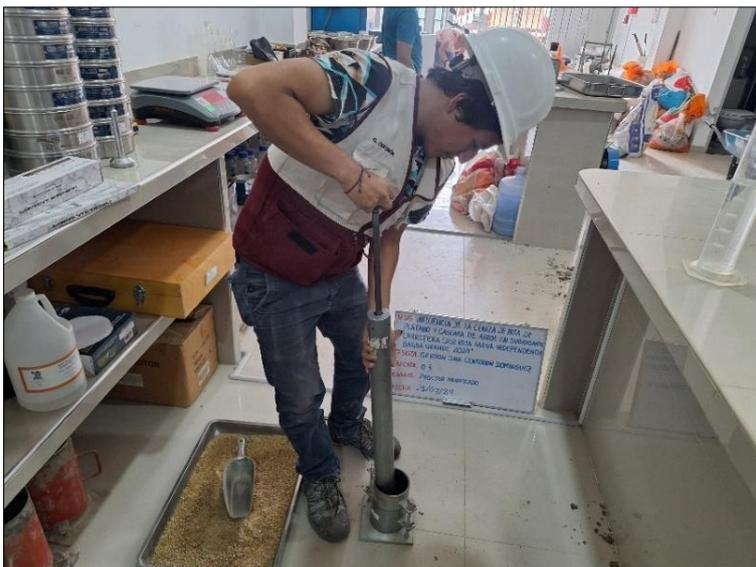
*Nota:* En la figura 8, se muestra el procedimiento del ensayo de Proctor modificado, en este caso se evidencia la compactación con un pisón en capas diferentes, esto se realizó teniendo en cuenta la norma MTC E 115.
