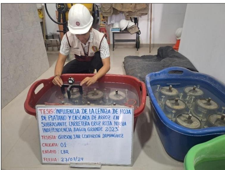
*Nota:* En la figura 9, se muestra el procedimiento del ensayo de CBR, se evidencia la colocación del trípode con el dial para posteriormente sumergirlo al agua y tomar una lectura del dial cada 24 horas por cuatro días consecutivos, de acuerdo a lo establecido en la norma MTC E 132.
