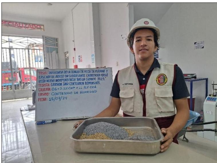
*Nota:* En la figura 11, se muestra el procedimiento que se ha realizado para obtener la muestra del suelo patrón con adición, el cual consiste en pesar una cantidad de muestra del suelo natural y luego con respecto al 15% de su peso posteriormente adicionarle el peso de las cenizas según la combinación que corresponda.
