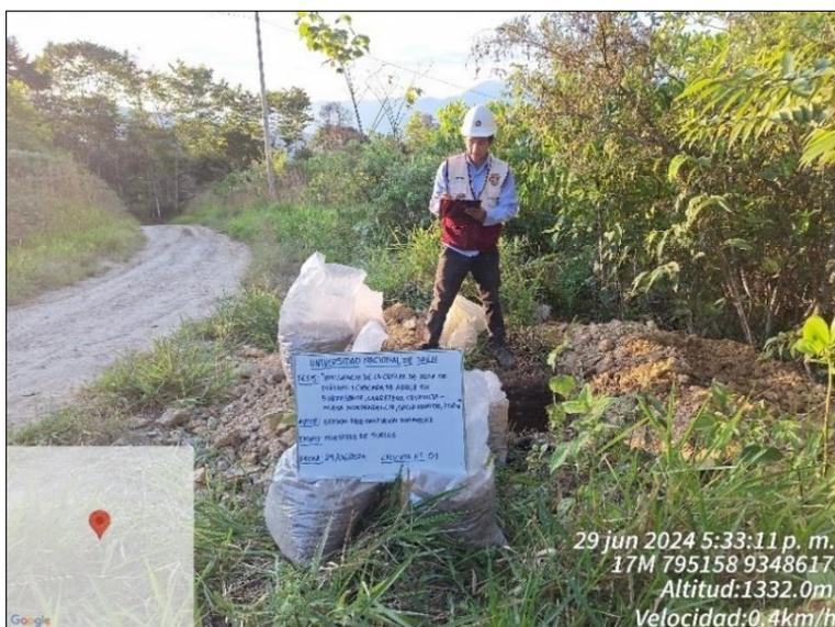
*Nota:* En la figura 2, se muestra el proceso de identificación de estratos en la primera calicata, se registró también las coordenadas topográficas, altitud y progresiva en el que se realizó esta calicata.
