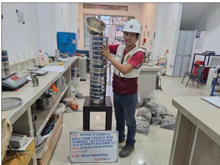
*Nota:* En la figura 6, se muestra el procedimiento de manera manual del tamizado del suelo seco en el horno, el cual se ha obtenido del lavado; los tamices usados fueron los establecidos en la Norma MTC E 107.
