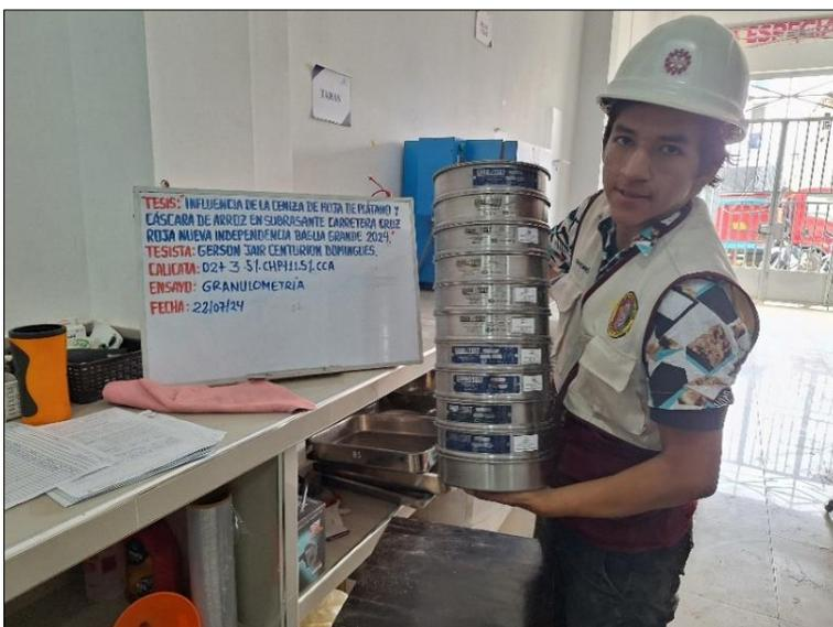
*Nota:* En la figura 13, se muestra el procedimiento de forma manual del tamizado de la muestra obtenida secada al horno de la muestra con adición de 3.5% CHP +11.5% CCA para la segunda calicata; los tamices usados fueron los establecidos en la Norma MTC E 107.
