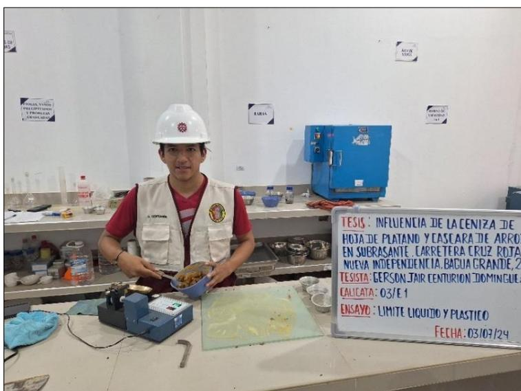
*Nota:* En la figura 7, se muestra el procedimiento del ensayo de límite líquido, en donde se utilizó el instrumento de Casagrande con contador automático, este ensayo fue realizado siguiendo los procedimientos establecidos en la norma MTC E 110.
