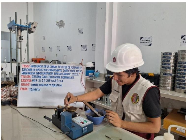
*Nota:* En la figura 14, se muestra el procedimiento del ensayo de límite líquido para la muestra con adición de 3.5% CHP +11.5% CCA para la segunda calicata y se siguió los pasos de la Norma MTC E 110.
