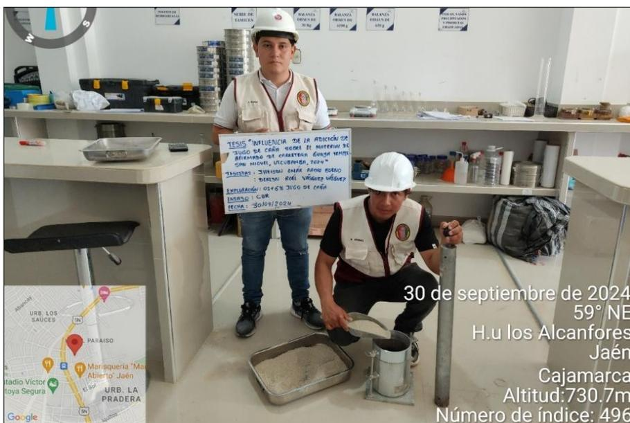
En la figura 69, se muestra el proceso del ensayo de CBR de la exploración 01 con adición del 6% de jugo de caña, en este caso se evidencia el llenado en capas en el molde, esto se realiza con la ayuda del cucharón.
