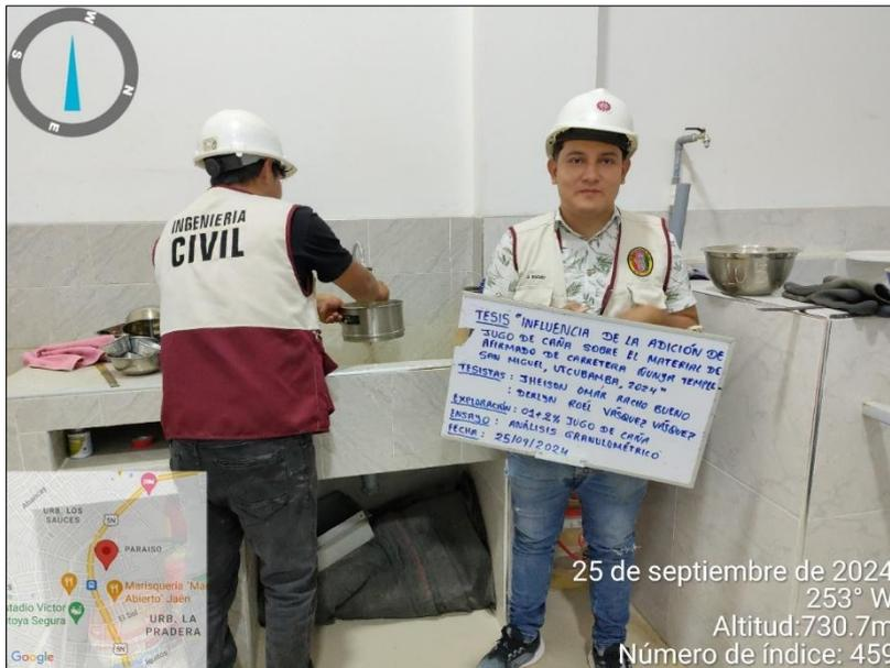
En la figura 63, se muestra el proceso del lavado de la muestra representativa con el 2% de jugo de caña, este con el objetivo de eliminar los finos que pasan por el tamiz N° 200 para después realizar el ensayo de la granulometría.
