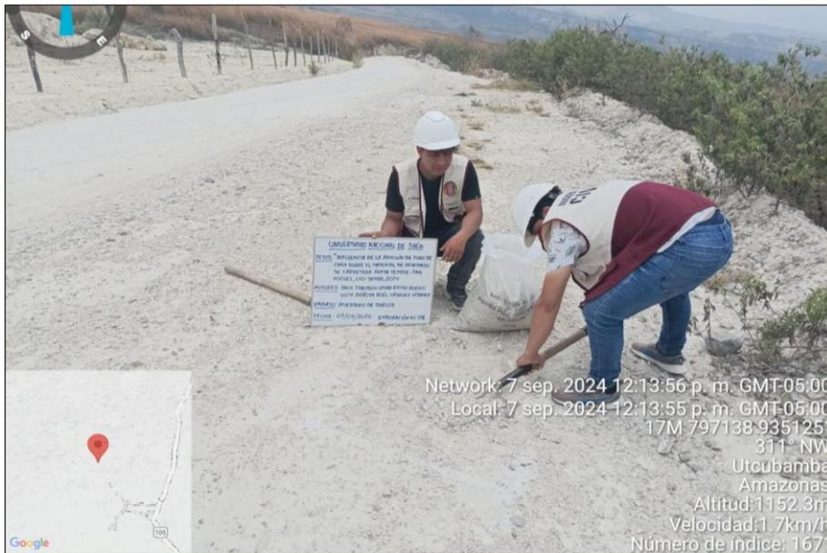
En la figura 45, se observa el proceso de extracción de la muestra de afirmado para la exploración N° 06 de 1.0m de ancho x 1.0m de largo x 0.20m de profundidad.
