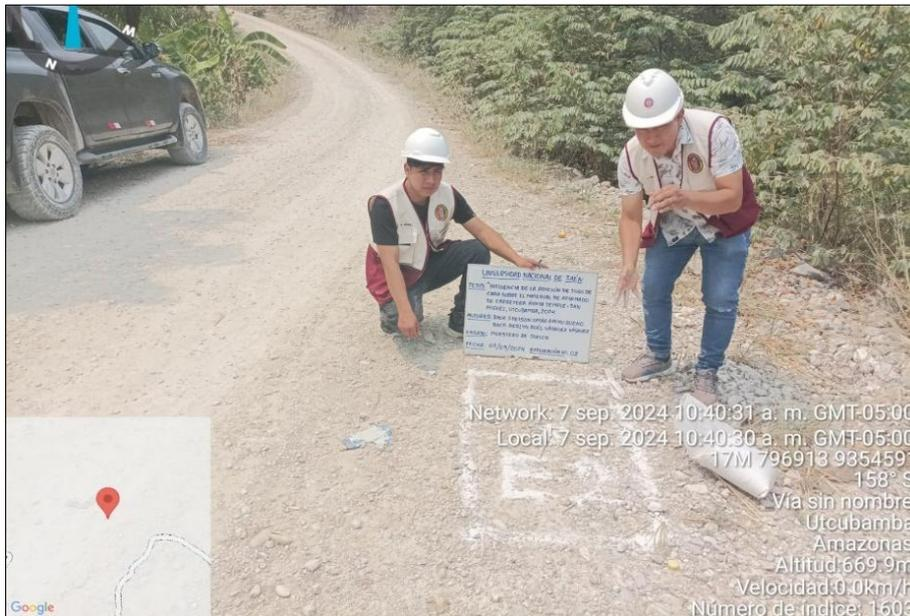
En la figura 41, se observa el proceso de extracción de la muestra de afirmado para la exploración N° 02 de 1.0m de ancho x 1.0m de largo x 0.20m de profundidad.
