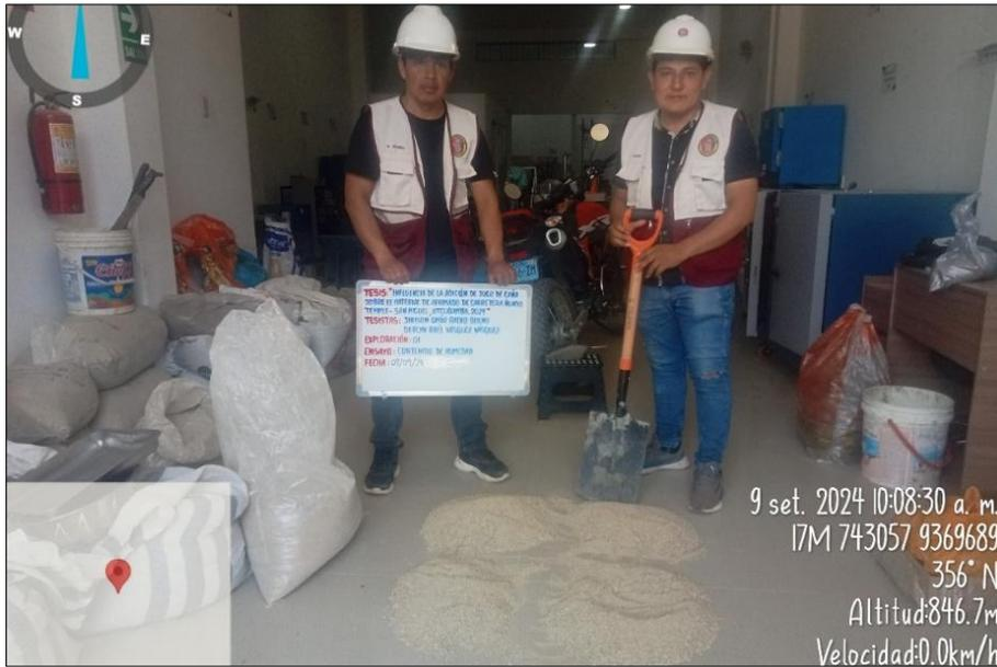
En la figura 48, se muestra el proceso del cuarteo esto con el objetivo de obtener proporciones representativas de tamaño adecuado para efectuar las pruebas del ensayo de granulometría, siguiendo las pautas de la Normativa MTC E 105.
