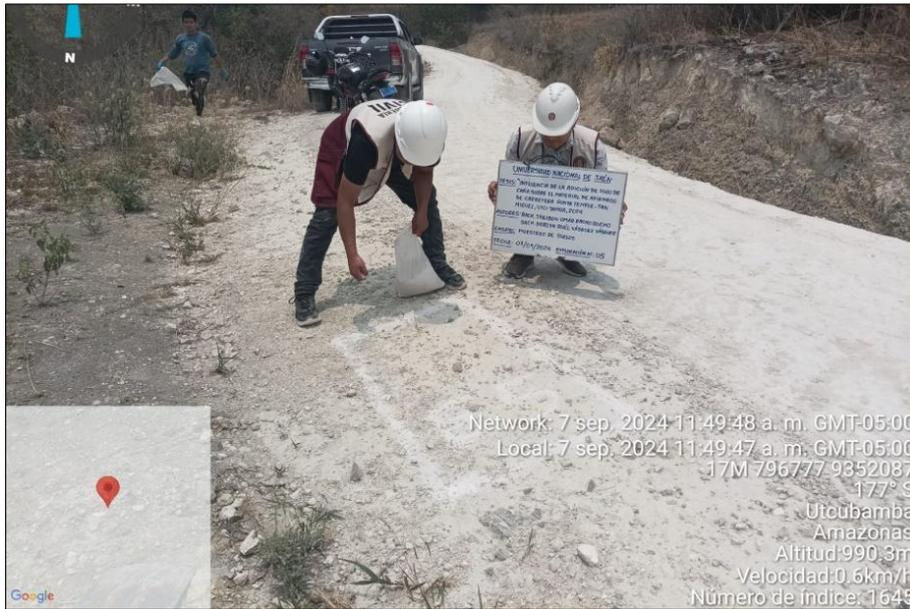
En la figura 44, se observa el proceso de extracción de la muestra de afirmado para la exploración N° 06 de 1.0m de ancho x 1.0m de largo x 0.20m de profundidad.
