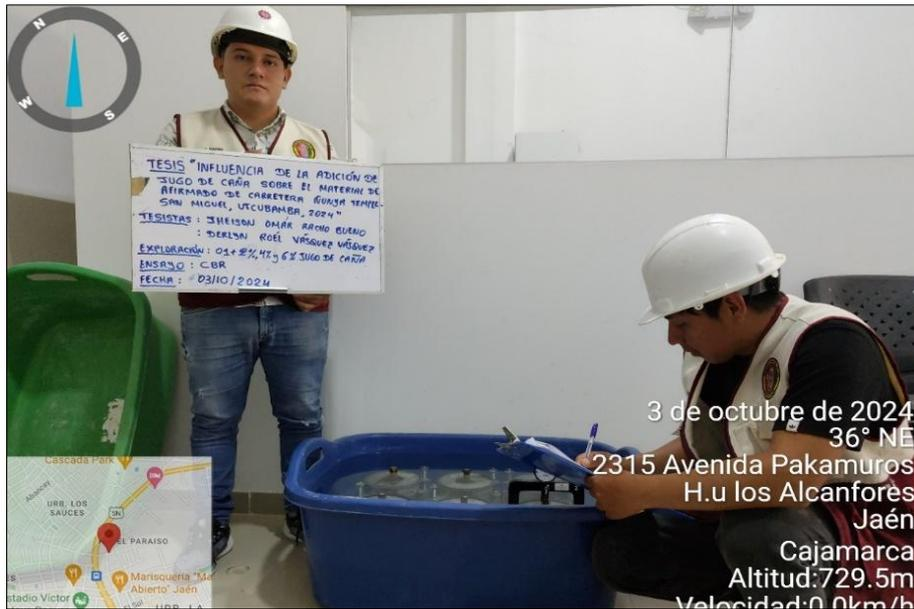
En la figura 70, se evidencia el ensayo de saturación de las muestras de CBR de la exploración 01 con adiciones de 2, 4 y 6% de jugo de caña, el cual consiste en sumergir los moldes en agua y aplicar un punzonamiento.
