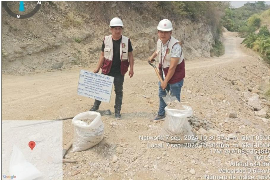
En la figura 40, se observa el proceso de extracción de la muestra de afirmado para la exploración N° 01 de 1.0m de ancho x 1.0m de largo x 0.20m de profundidad.
