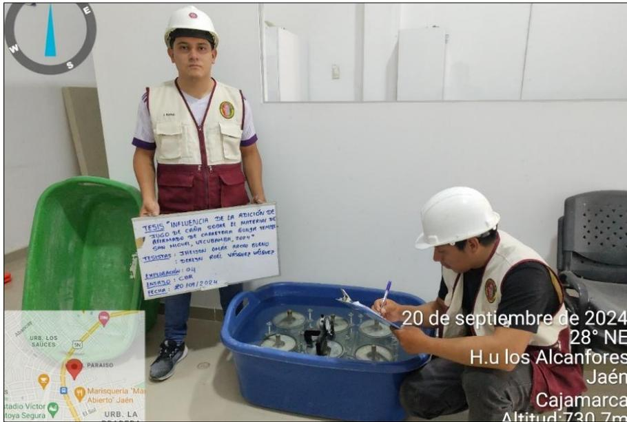
En la figura 60, se evidencia el proceso del ensayo de saturación de las muestras de CBR, el cual consiste en sumergir los moldes en agua y aplicar un punzonamiento esto se realiza por un periodo de cuatro días consecutivos.
