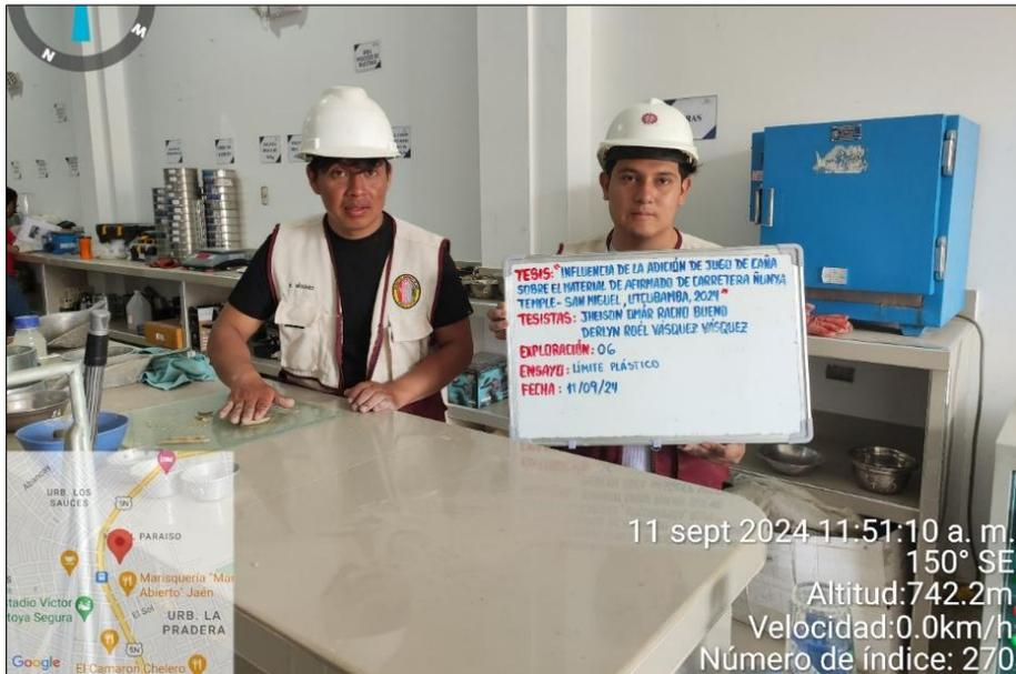
En la figura 55, se muestra el proceso del ensayo del límite plástico, el cual consiste en amasar cilindros de 3mm de diámetro, todos estos pasos se realizaron siguiendo las pautas de la Normativa MTC E 111.
