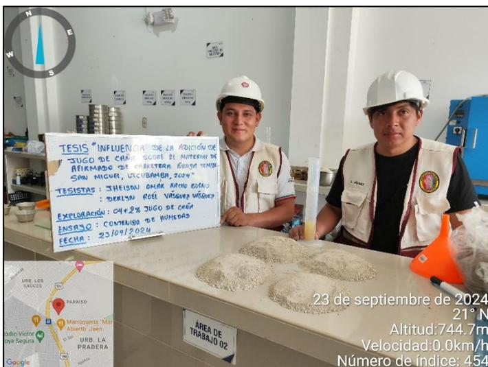
En la figura 10, se muestra el proceso de realización del ensayo de análisis granulométrico empleando tamices, con la muestra de material de afirmado a la que se le adicionó el 4% de jugo de caña.
