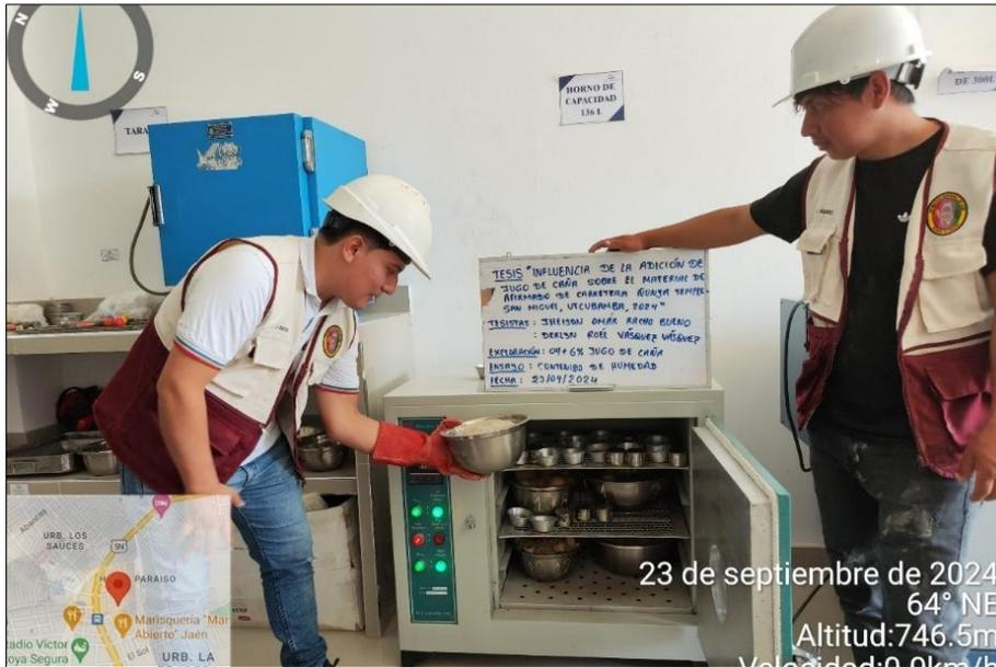
En la figura 62, se evidencia el proceso de ingreso de la muestra de material de afirmado en el horno con adición del 6% de jugo de caña para determinar su contenido de humedad después de 24 horas.
