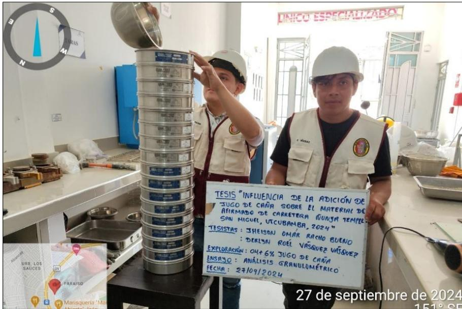
En la figura 64, se evidencia el proceso de tamizado de la muestra de material de afirmado con el 6% de jugo de caña de los cuales tiene que pasar por cada uno de los tamices correspondientes, todo ello siguiendo las pautas de la Normativa MTC E 107.
