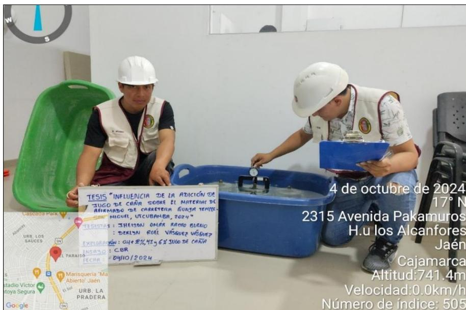
En la figura 71, se evidencia el ensayo de saturación de las muestras de CBR de la exploración 02 con adiciones de 2, 4 y 6% de jugo de caña, el cual consiste en sumergir los moldes en agua y aplicar un punzonamiento.
