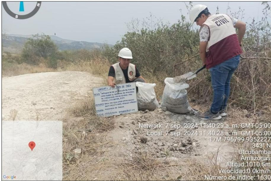
En la figura 43, se observa el proceso de extracción de la muestra de afirmado para la exploración N° 04 de 1.0m de ancho x 1.0m de largo x 0.20m de profundidad.
