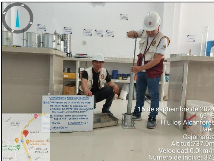
En la figura 7, se aprecia el proceso del ensayo de CBR de la muestra patrón, en este caso se evidencia la compactación en capas con la ayuda del pisón, todos estos pasos se realizaron siguiendo las pautas de la Normativa MTC E 132.
