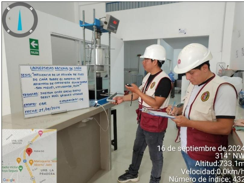
En la figura 61, se evidencia el proceso del ensayo de penetración de la muestra patrón de CBR, la cual consiste en aplicar un punzonamiento sobre la superficie del molde mediante un pistón normalizado.
