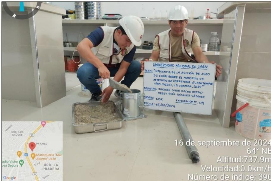
En la figura 59, se muestra el proceso del ensayo de CBR de la muestra patrón, en este caso se evidencia el llenado en capas en el molde, esto se realiza con la ayuda del cucharón.
