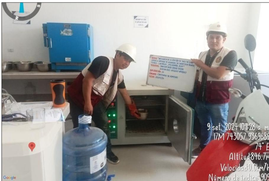
En la figura 49, se evidencia el proceso de ingreso de la muestra de material de afirmado en el horno para determinar su contenido de humedad después de 24 horas.
