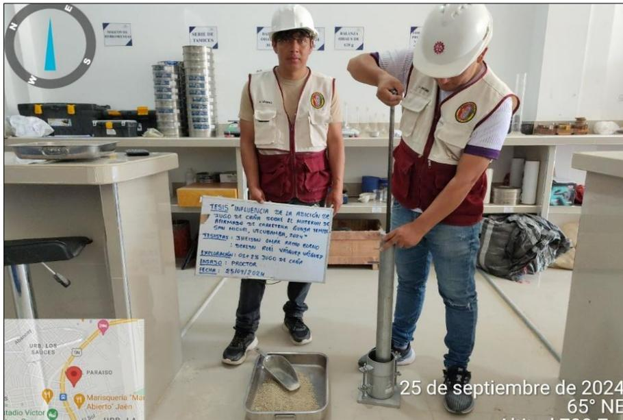
En la figura 68, se muestra el proceso del ensayo de Proctor modificado de la exploración 01 con adición del 2% de jugo de caña, en este caso se evidencia la compactación en capas en el molde, esto se realiza con la ayuda del pisón.
