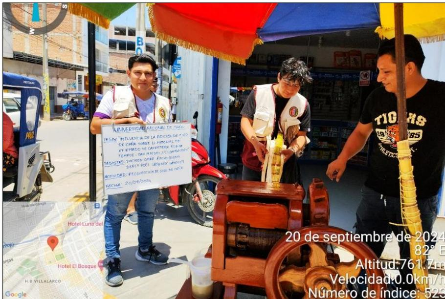
En la figura 47, muestra el proceso de extracción y recolección de jugo de caña a través de la molienda de manera artesanal en la maquina llamada trapiche.
