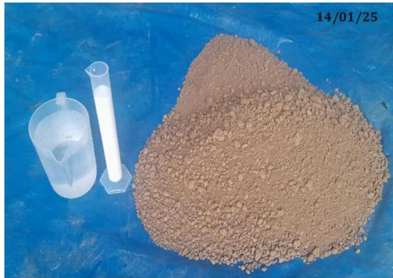
**Paso 3:** Se mezcla de manera uniforme el suelo, aditivo Maxx-Seal 200 y agua.
