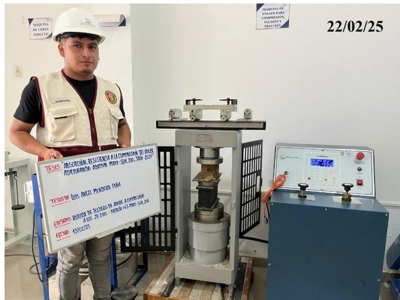
*Nota.* Se colocó las muestras en la máquina de compresión, donde se aplicó la carga hasta provocar su rotura
