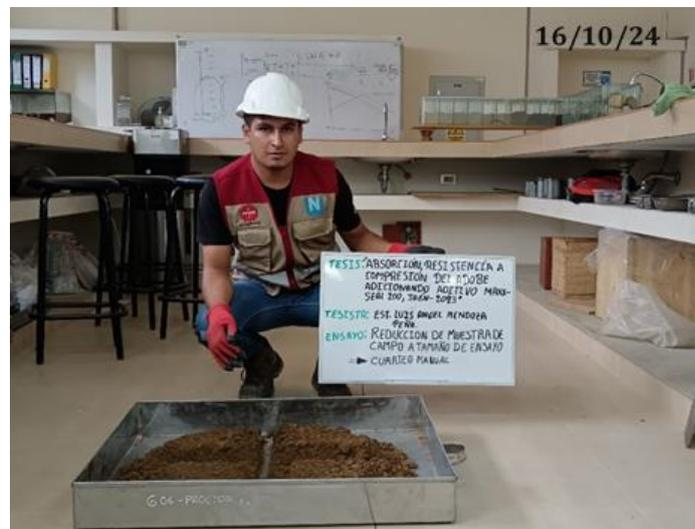
*Nota.* En la figura se ha realizado el cuarteo de muestra manual para obtener la muestra representativa para cada ensayo respectivamente Fuente. Norma Técnica Peruana 339.126 (2019). *Suelos. Métodos para la Reducción de Muestras A tamaño de Muestras de Ensayo*
