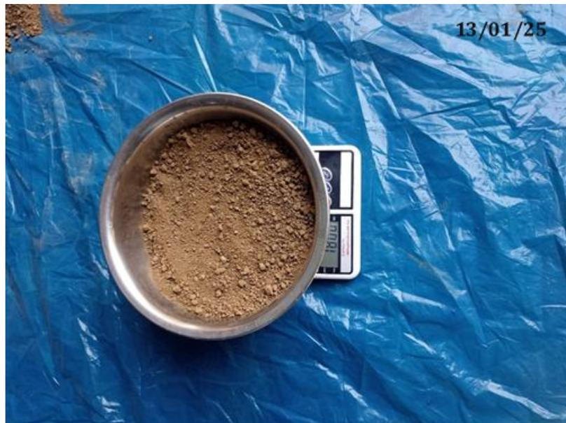
**Paso 2:** Suelo seco, aditivo Maxx-Seal 200 y agua.
