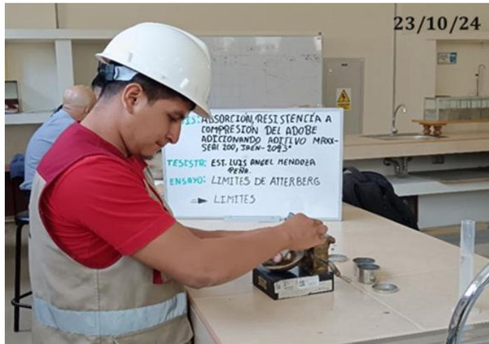
*Nota.* Se utilizó el material que pasa el tamiz N°40. Fuente. Norma Técnica Peruana 339.129 (2019) *Suelos. Método de ensayo para determinar el límite líquido, límite plástico, e índice de plasticidad de suelos*
