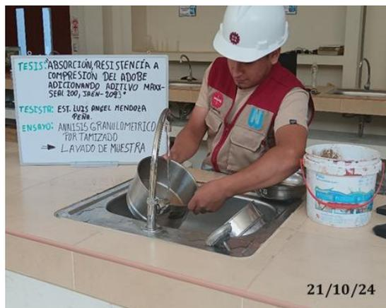
*Nota.* Después de secar la muestra hasta peso constante, se realiza el lavado de la muestra en el tamiz N°200, para luego volver a secar hasta peso constante. Fuente. Norma Técnica Peruana 339.128 (2019) *Suelos. Método de ensayo para el análisis granulométrico*
