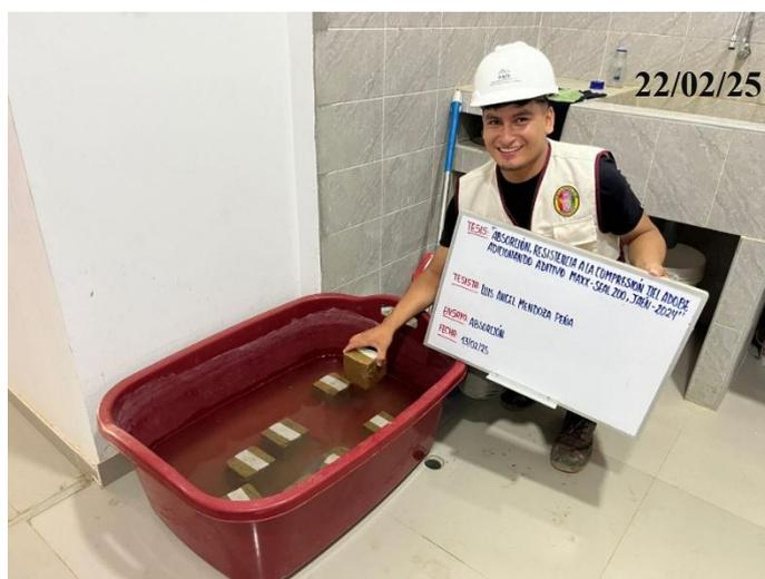
*Nota.* Se colocó las muestras a un recipiente con agua sumergidos completamente por un tiempo de 24 horas, luego se procedió a pesar nuevamente para determinar la absorción de cada espécimen
