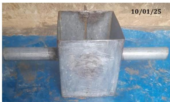
*Nota.* En la siguiente figura se aprecia el molde, cuyas medidas fueron de 10 cm de largo, 10 cm de ancho y 10 cm de alto, de acuerdo a la Norma Técnica E.080 (2020). *Diseño y Construcción Con Tierra Reforzada*
