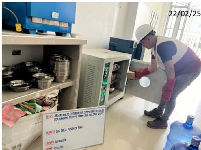
*Nota.* Se colocó las muestras al horno, hasta obtener un peso constante para proceder a realizar el ensayo de absorción
