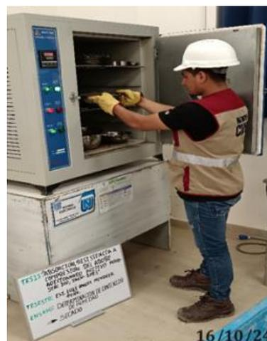
*Nota.* En la figura se aprecia la colocación de la muestra al horno a una temperatura de  $110 \pm 5$  °C para su respectivo secado. Fuente. Norma
