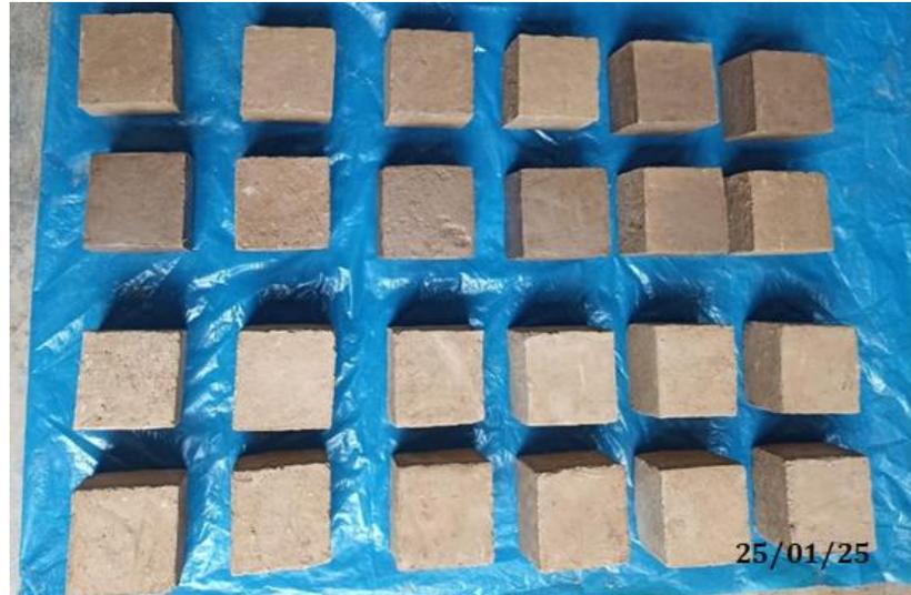
**Paso 8:** cumplidos los 28 días, los adobes se almacenan bajo techo para realizar ensayos correspondientes según manda Norma Técnica E.080 (2020). *Diseño y Construcción Con Tierra Reforzada.*
