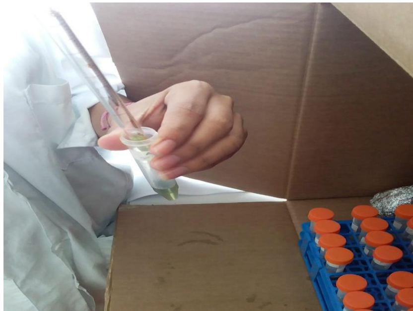
Figura 26. Adición de la solución del Folin-Ciocalteu para determinar fenoles totales
