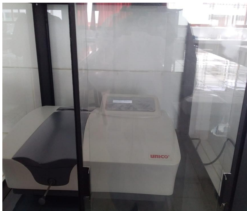
Figura 31. Determinación de fenoles totales en las muestras mediante espectrofotometría
