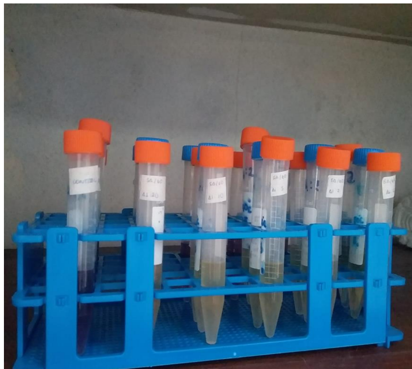
Figura 27. Muestras para determinar la capacidad antioxidante con DPPH
