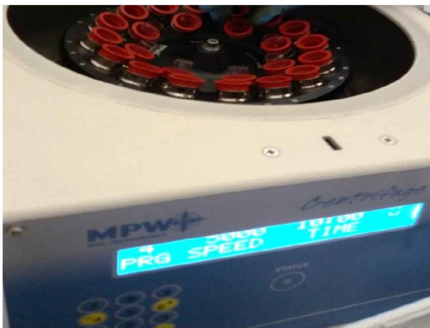
Figura 24. Emplazamiento de los tubos de ensayo en la centrifuga por 30 minutos
