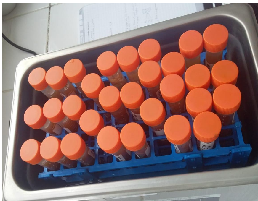
Figura 23. Instalación de los tubos de ensayo al ultrasonido por 10 minutos
