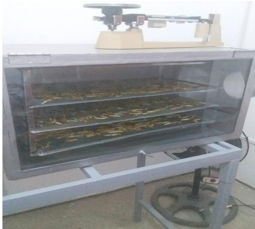
Figura 13. Deshidratación de la flor de plátano en el secador de bandejas del Laboratorio de Refrigeración y Congelación de la Escuela Profesional de Ingeniería de Industrias Alimentarias
