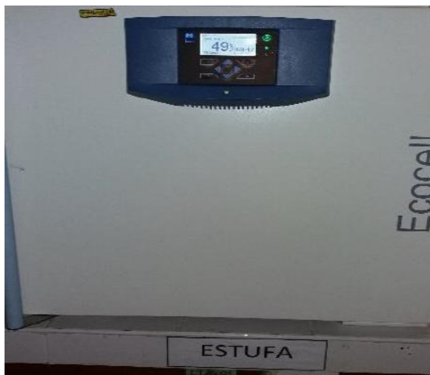
Figura 29. Acomodo de muestras en la estufa por 5 minutos a una temperatura de 50°C
