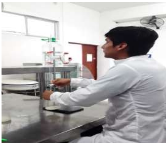
Figura 31. Determinación de acidez titulable de las láminas de coco.
