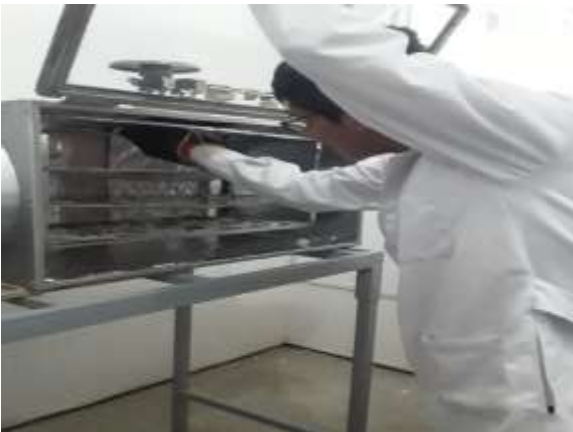
Figura 23. Colocando las bandejas a la cabina del secador. Para el deshidratado de coco
