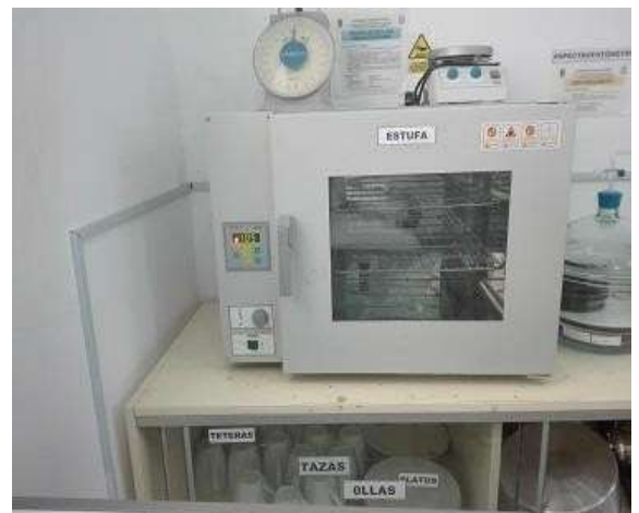
Figura 32. Determinación de la humedad por el método de estufa.
