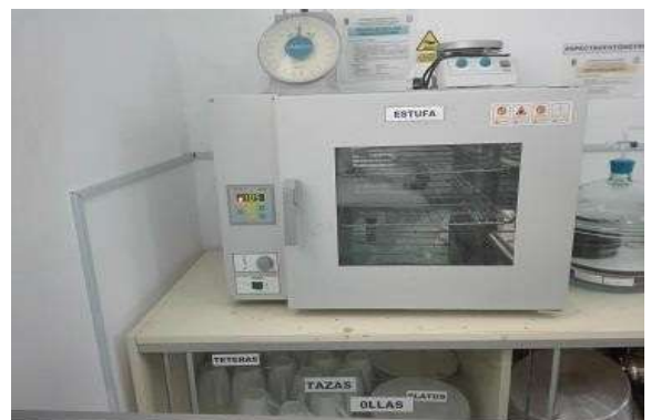
Figura 26. Secado de las láminas de coco hasta su peso constante.
