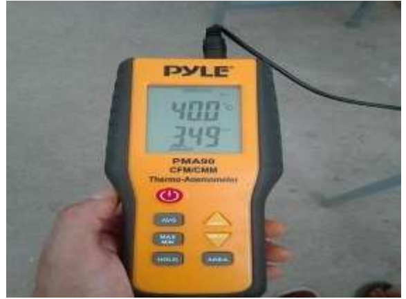
Figura 28. Anemómetro digital regulador de velocidad de aire.
