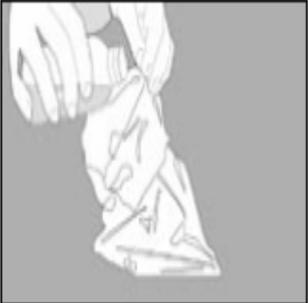
**5** Adicione la cantidad apropiada de uno de los siguientes diluyentes estériles: tampón Butterfield (tampón IDF fosfato, 0.0425 g/L de  $\text{KH}_2\text{PO}_4$  y con pH ajustado a 7.2); agua de peptonas al 0.1%; diluyente de sal peptonada (método ISO 6887); buffer de agua peptonada (método ISO 6579); solución salina (0.85 a 0.90%); caldo lotheen libre de bisulfato o agua destilada.
