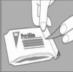
**2** Para cerrar un paquete abierto, doble el extremo y séllelo con cinta adhesiva para evitar el ingreso de humedad y, por lo tanto, la alteración de las placas.
