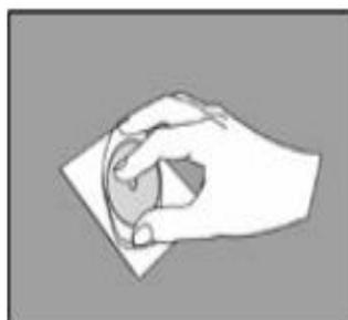
11 Presione **suavemente** el dispersor para distribuir el inóculo sobre el área circular. No gire Ni deslice el dispersor.
