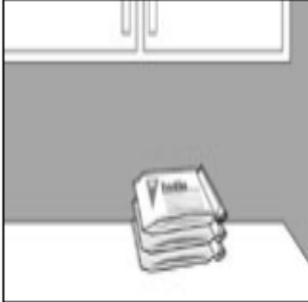
**3** Mantenga los paquetes cerrados (según se indica en el punto 2) a temperatura 25°C (77°F) y una humedad relativa <math>\leq 50\%</math>. **No refrigere** los paquetes que ya hayan sido abiertos. Utilice las Placas Petrifilm máximo un mes después de abierto el paquete.
