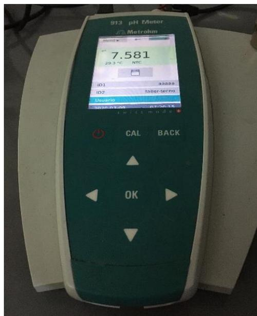
**Figura 33.** Peachímetro digital calibrado, para análisis de muestras.
