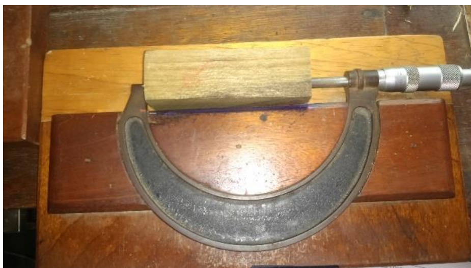
Figura 12: Probeta de madera de Cordia alliodora (R. y P.) Oken siendo medida longitudinalmente con el micrómetro.
