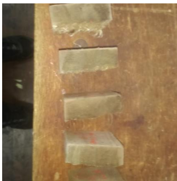
Figura 21: Probeta al término de ensayo de cizallamiento.
