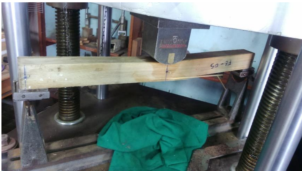
Figura 18: Ruptura de la probeta al finalizar ensayo de flexión estática.
