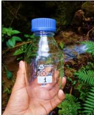
Figura 8. Recipiente esterilizado para el traslado de la muestra de agua.
