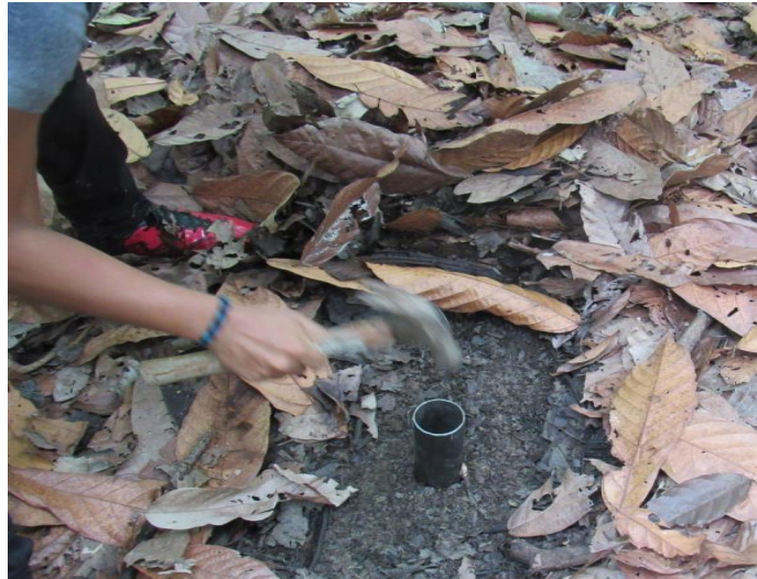
Figura 13: Introducción de tubo metálico para la toma de la muestra de suelo a una profundidad de 20 cm.
