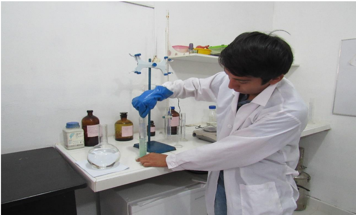
Foto 4: Aplicación del Método de Walkley y Black.
