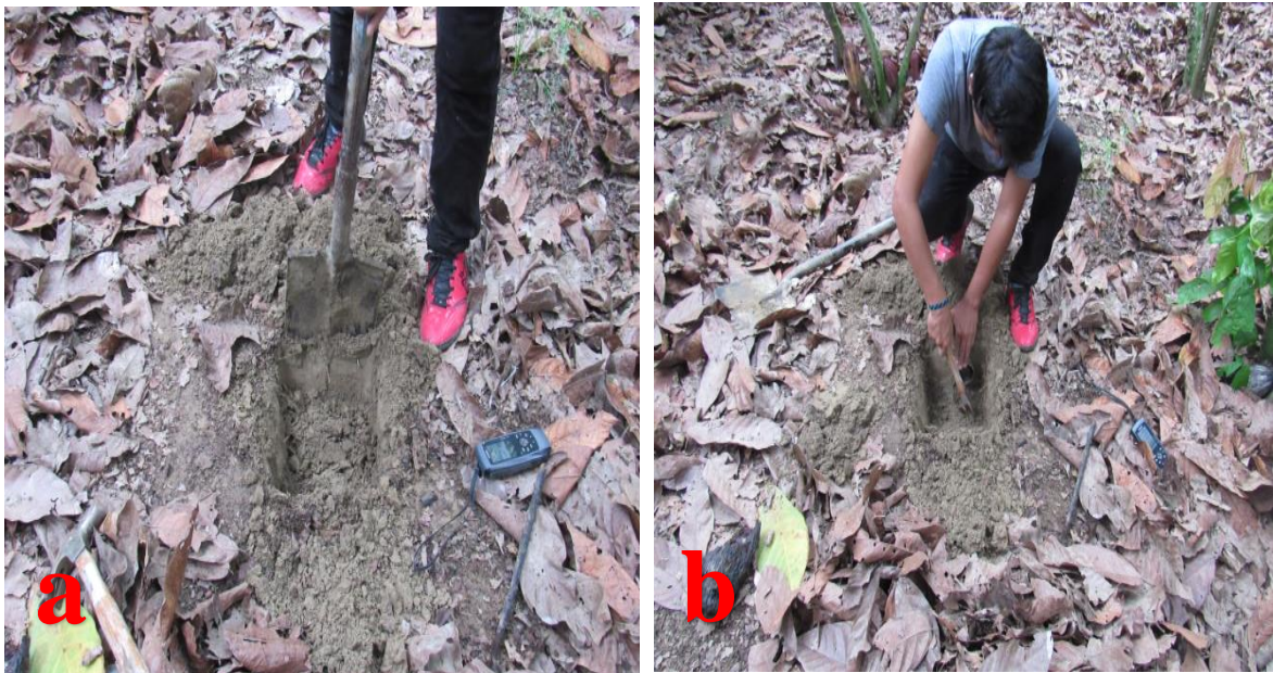
Figura 10: Obtención de la muestra de suelo para calcular la densidad aparente. a) Calicata para la toma de la muestra de suelo, b) introducción del cilindro de volumen conocido para obtener la muestra de suelo.
