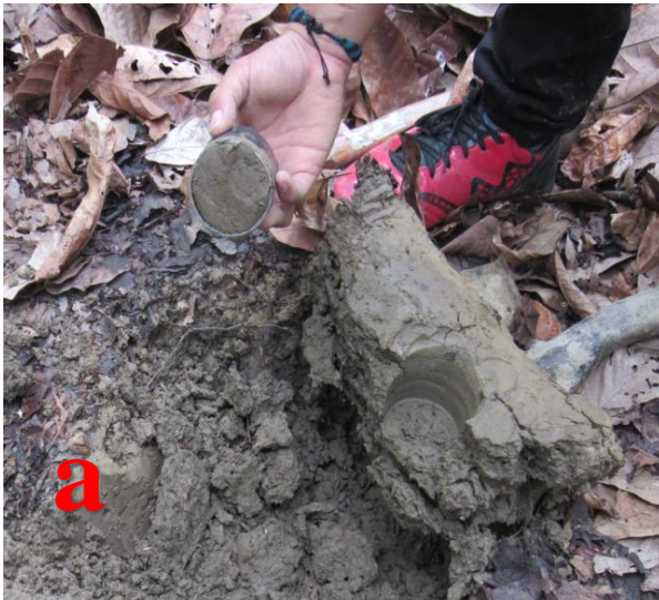
Figura 11: Obtención de la muestra de suelo para calcular la densidad aparente. a) Extracción de la muestra de suelo, b) recolección de la muestra de suelo.
