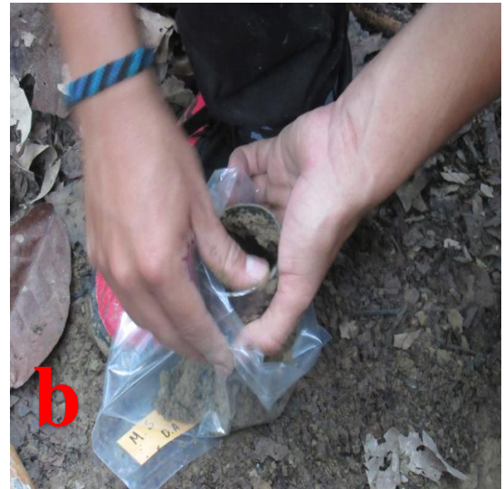
Figura 11: Obtención de la muestra de suelo para calcular la densidad aparente. a) Extracción de la muestra de suelo, b) recolección de la muestra de suelo.
