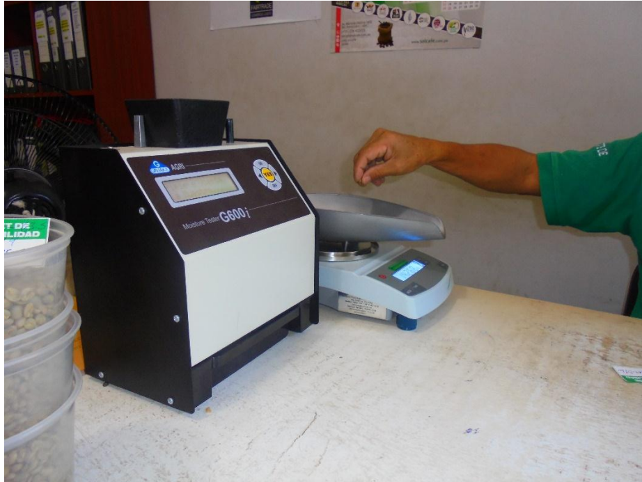
Foto 7. Medida de humedad del café con el humidímetro
