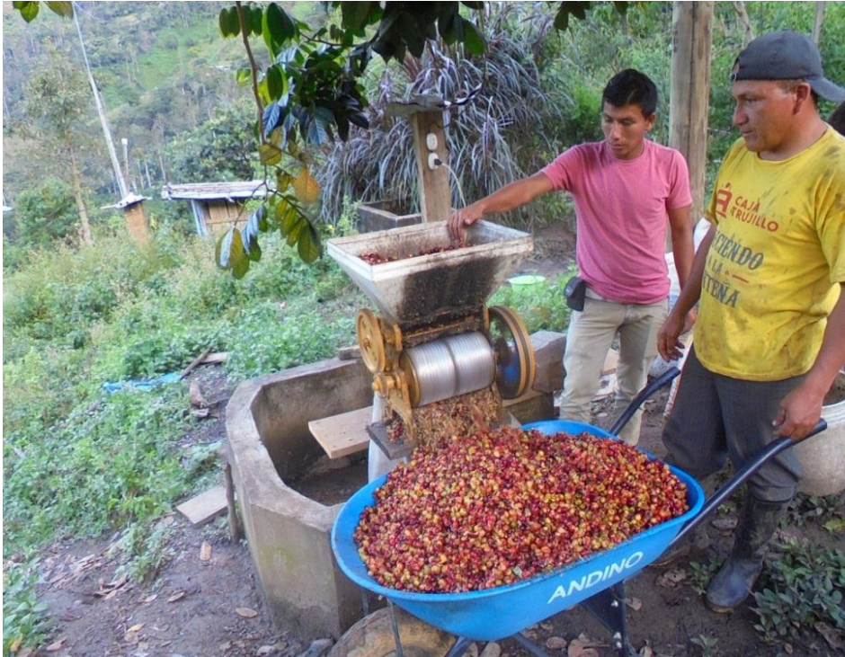
Foto 3. Despulpado del café en la máquina despulpadora
