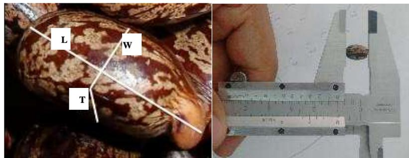
Figura 4. Dimensiones axiales características de las semilla de *R. communis* (L: longitud mayor o largo, W: longitud menor o ancho y T: altura o grosor).
