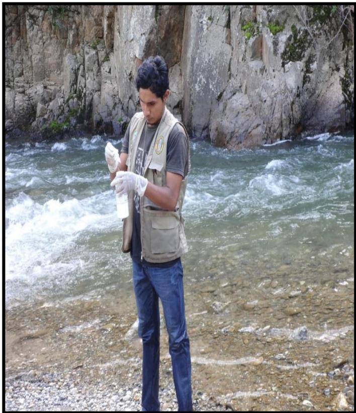
*Foto 6:* Añadiendo preservante ácido nítrico ( $\text{HNO}_3$ ).
