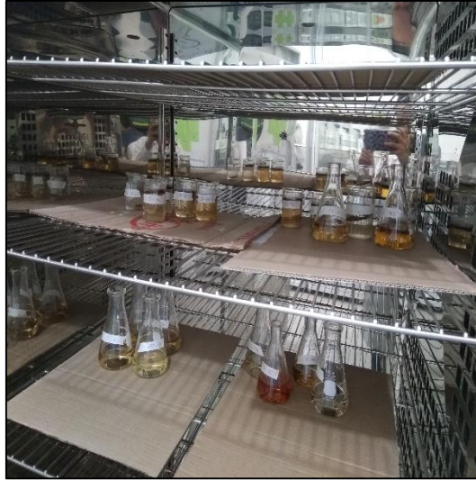
Foto 16: Muestras en la estufa listas para ser retiradas luego de pasar 1 hora a 80°C
