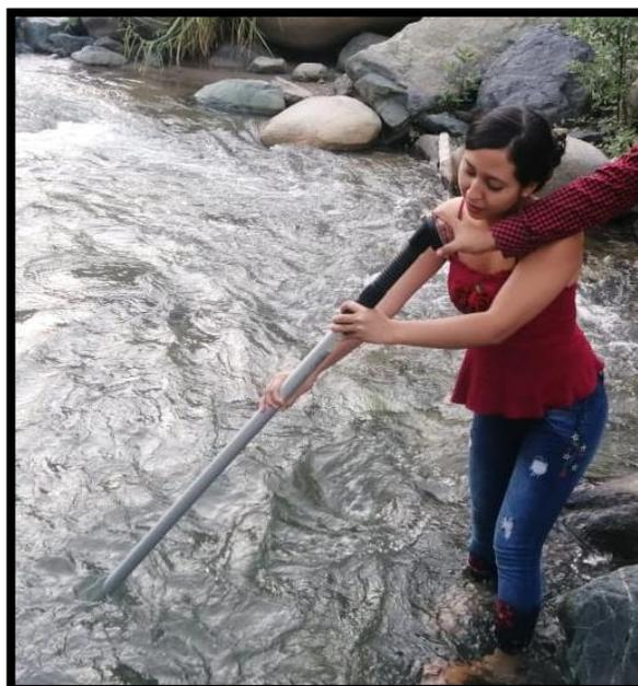
*Fotografía 9. Medición de la velocidad del agua con correntómetro.*
