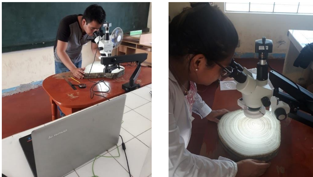
Figura 4. Medición de los anillos de crecimiento usando Estereoscopio.
