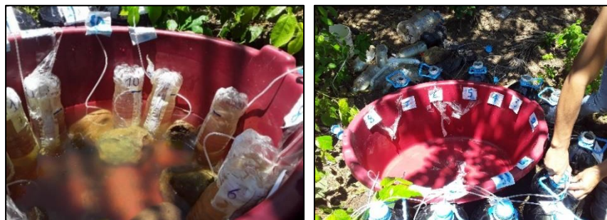
Figura 14. Marcado de la línea de agua desalojada en botellas de 1 litro: Biogás.
