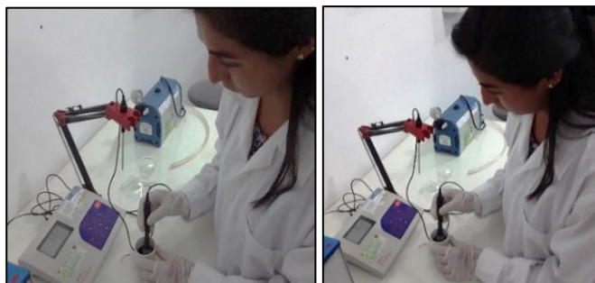
Figura 6. Evaluación del pH y sólidos suspendidos del agua residual porcina.
