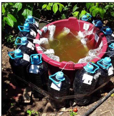
Figura 18. Piloto instalado de biodigestores para agua residual porcina.
