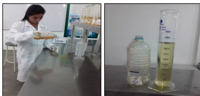
Figura 15. Medida del volumen de biogás formado.
