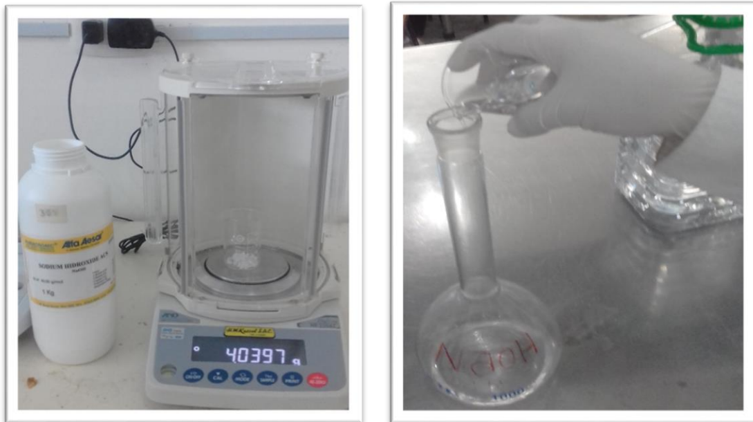
Figura 12. Preparación de la solución de hidróxido sodio (NaOH).
