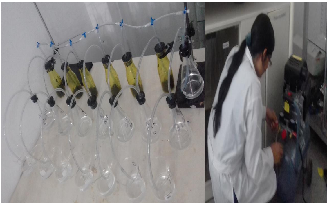
Figura 16. Sistema experimental instalado para la evaluación de la reactividad del compost.
