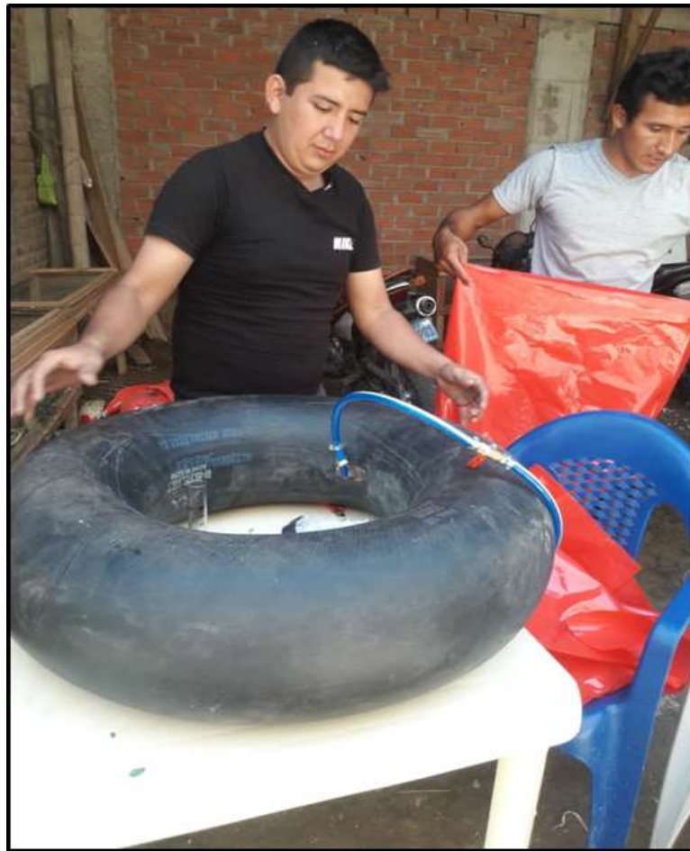
Imagen 9: Almacenamiento de biogás
