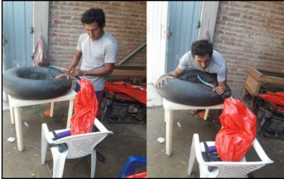
Imagen 14: Traslado de biogás de cámaras de recolección a gasómetro tubular
