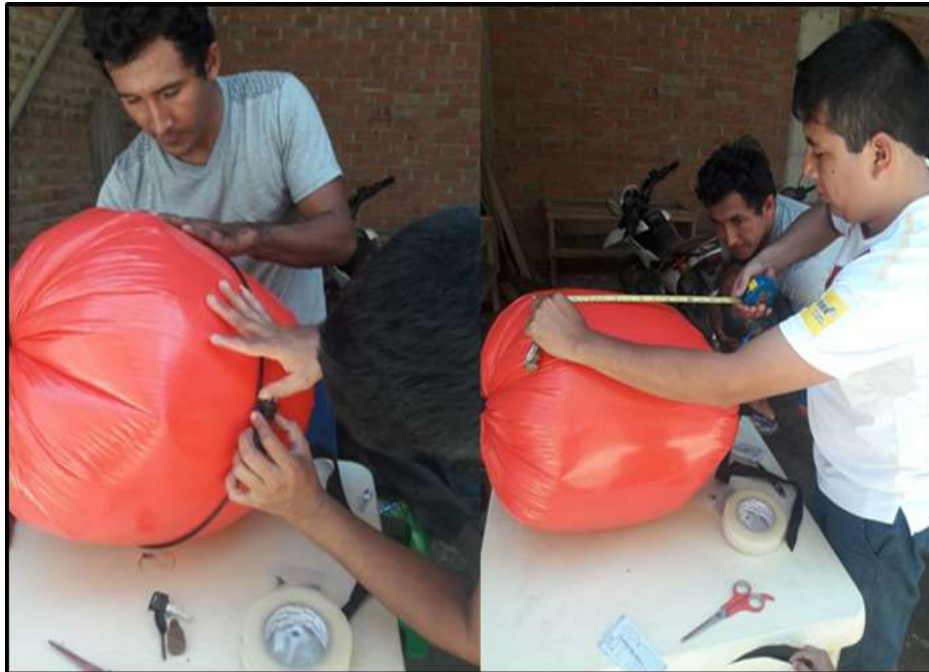
Imagen 15: Medición de gasómetro
