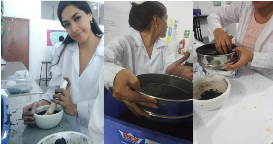
Figura 27. Molienda y tamizado del biochar.
