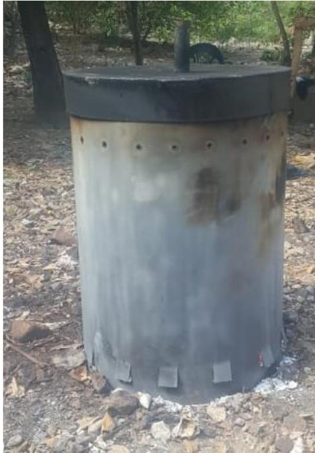
*Figura 25. Inicio del proceso de pirólisis.*
