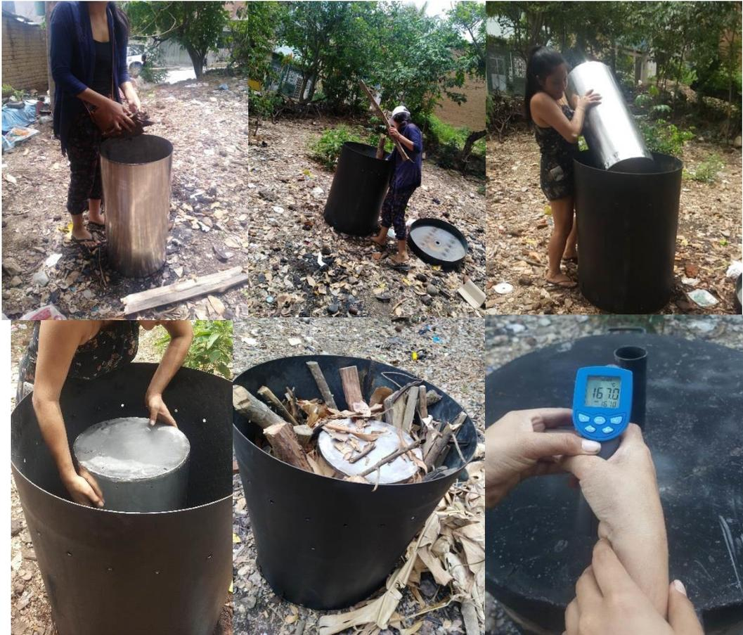
*Figura 23. Procesos para la producción de biochar.*
