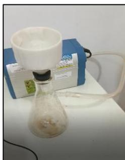
**Figura 10. Instalación de una unidad de vacío para el agua miel.**
