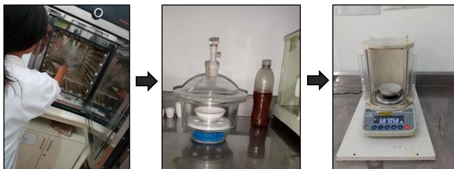
**Figura 8. Secado, tara y desecado de cápsulas de evaporación.**
