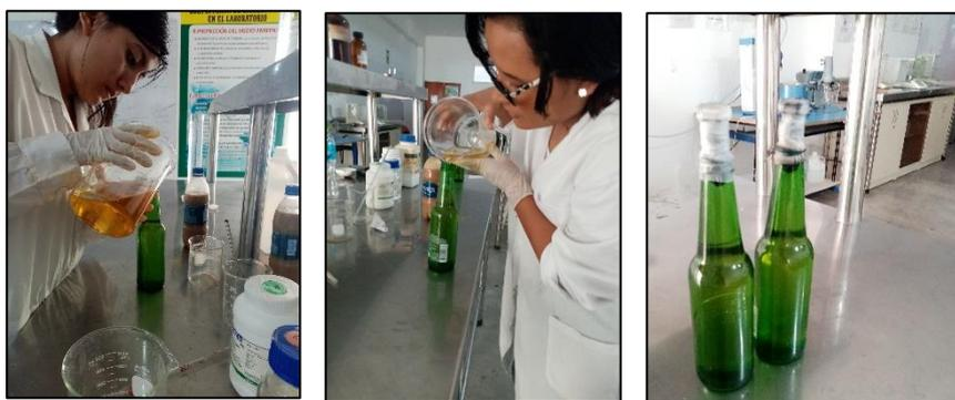
**Figura 14. Sellado de dos botellas (adaptadas a winkler)**
