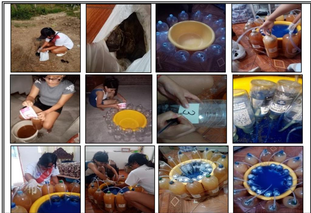
**Figura 17. Construcción de un piloto para anaerobiosis de agua miel de café.**
