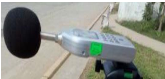
Figura N° 1. Sonómetro para la evaluación Sonora
