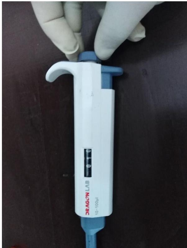
Fotografía N° 22 Calibración de la micro pipeta con la que se agregara el peróxido de hidrogeno.
