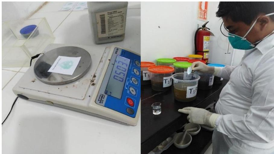
Figura 7: Pesado y agregado de sulfato ferroso granular a las nueve muestras
