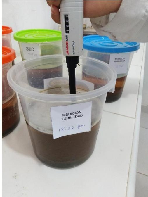
Figura 11: Extracción de la muestra para su análisis
