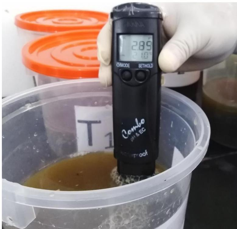
Fotografía N° 17 Caracterización del efluente, medición del pH.
