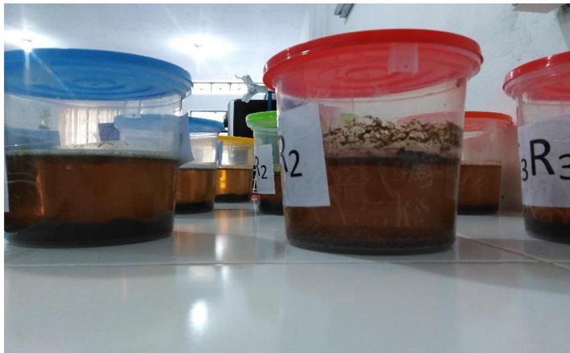
Figura 10: Reposo de la mezcla por 30 minutos posterior a la agitación
