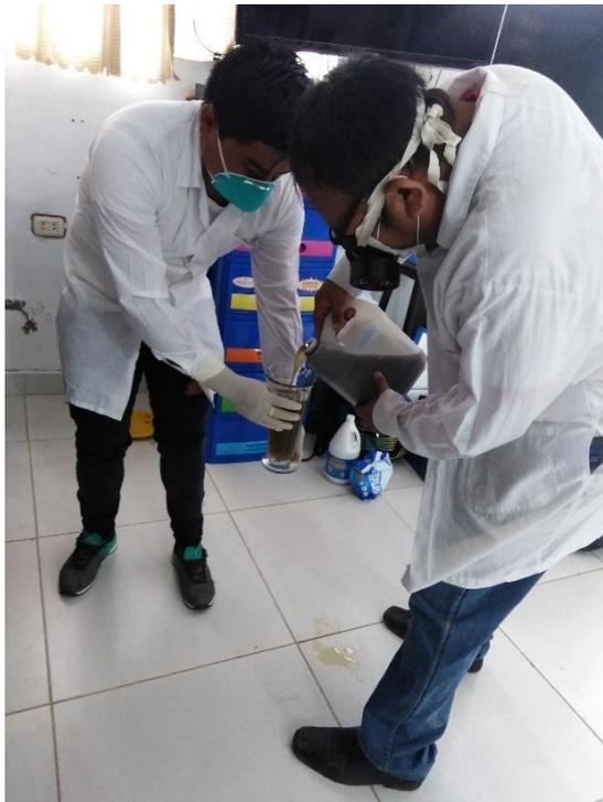
Fotografía N° 16 Medición del efluente con la cantidad de 1L para cada tratamiento y sus repeticiones respectivas.
