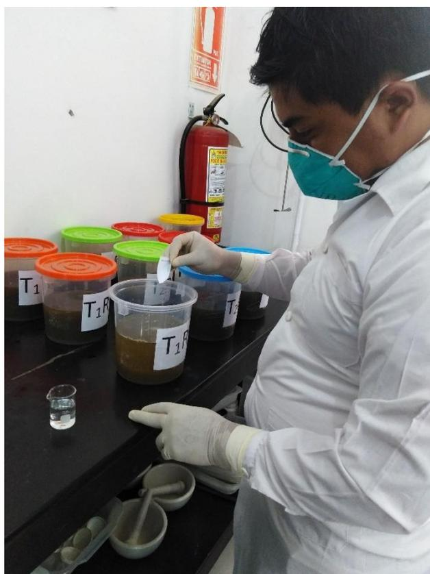
Fotografía N° 28 Agregación el sulfato ferroso a las 9 repeticiones
