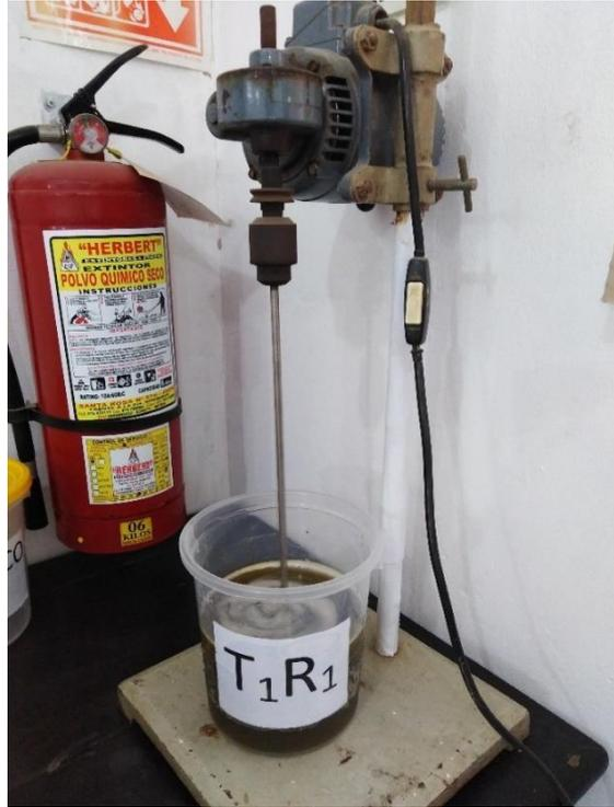
Figura 9: Agitación de la mezcla a 150 rpm por 45 minutos
