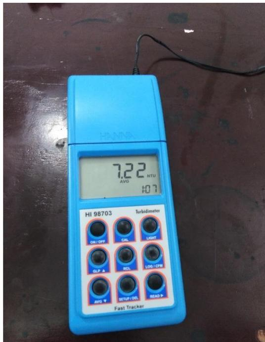
Figura 12: Medición de turbiedad posterior al proseo Fenton
