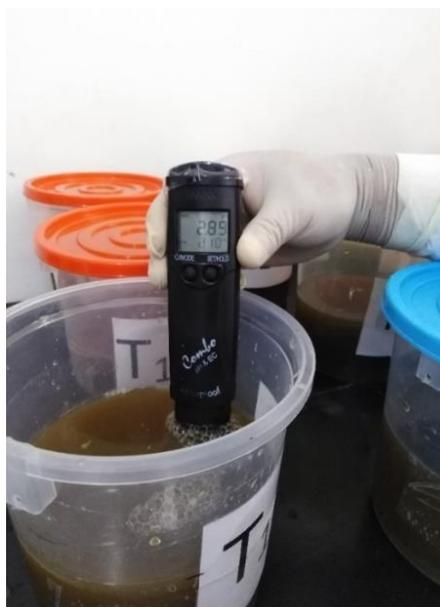
Figura 6: medición del pH de acondicionado
