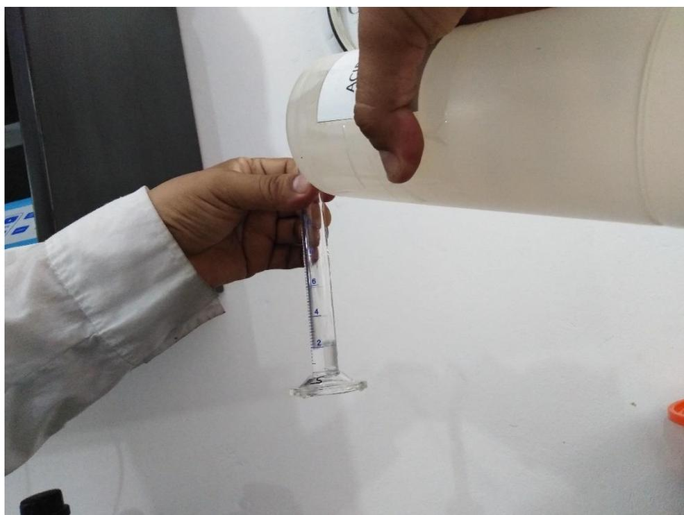
Fotografía N°26 Agregamos el ácido acético para reducir el pH a un rango de 2-3 en las 9 repeticiones.
