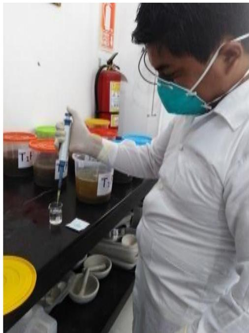
Figura 8: Adición a las muestras peróxido de hidrógeno al 30%
