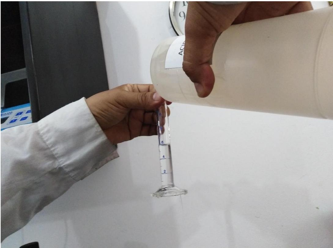
Fotografía N° 24 Medición del ácido acético para acidificar el efluente (6 ml para las 9 repeticiones).
