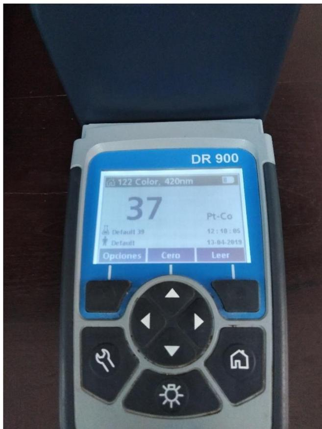
Fotografía N° 19 Caracterización del efluente, medición de color.
