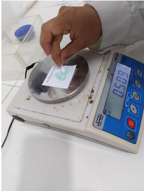
Fotografía N° 23 Pesado del sulfato ferroso (0.5g para las 9 repeticiones).
