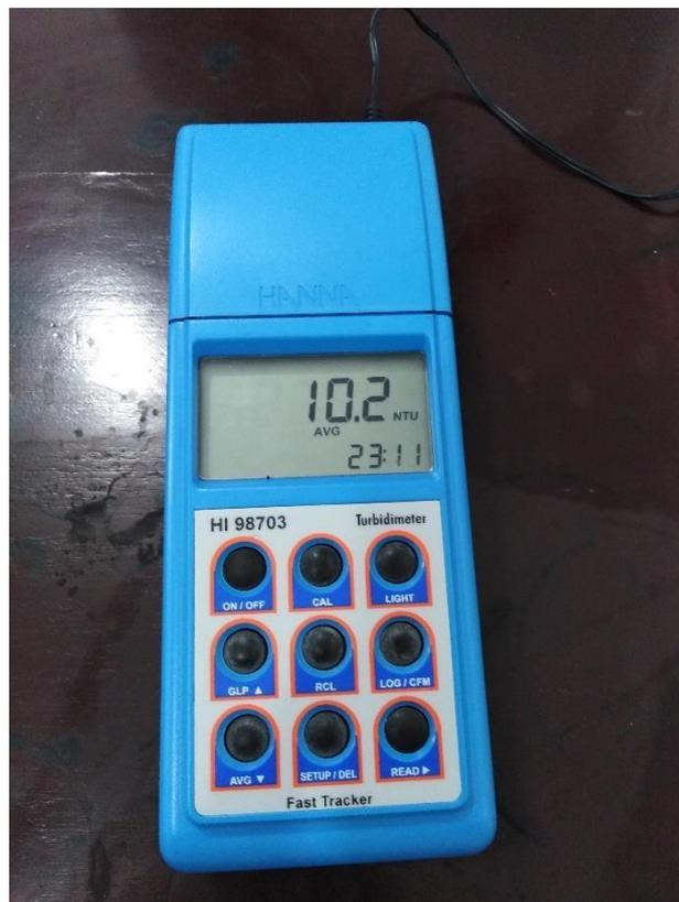
Fotografía N° 18 Caracterización del efluente; medición de turbiedad.
