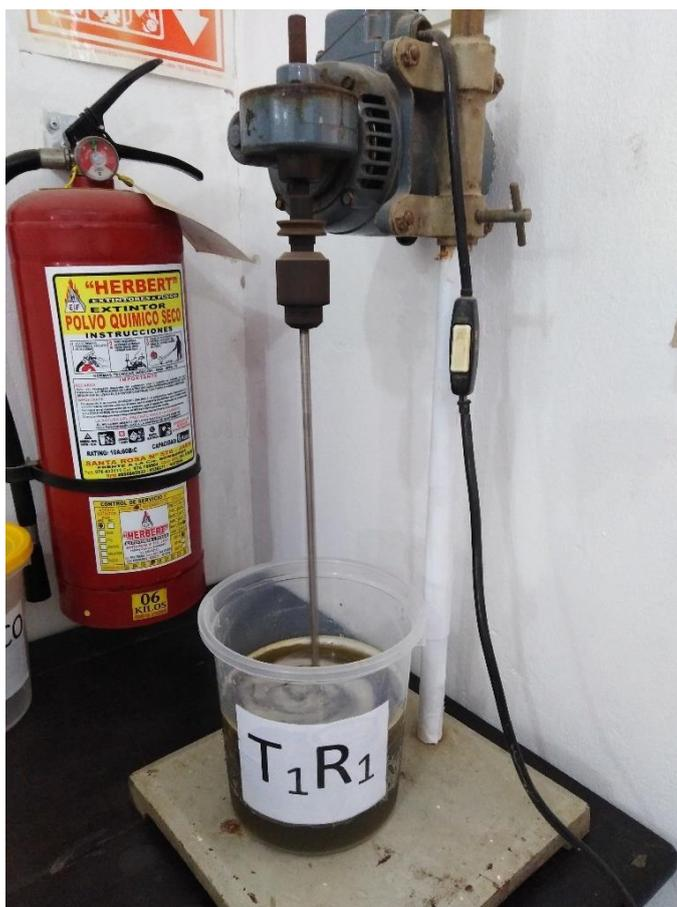
Fotografía N° 29 Agitación de la mezcla a 150 rpm por 45 minutos
