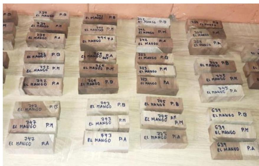
Según la NTP 251.011 (2019), la densidad básica es el cociente entre el peso de la probeta anhidra y el volumen en estado saturado que se expresa en  $\text{g/cm}^3$  (Ecu. 4). Este parámetro se calculó utilizando las probetas de cada una de las tres secciones del fuste (basal, media y apical).
