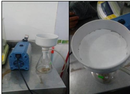
**Figura 7. Succión de la muestra y peso del papel filtro más el residuo seco.**
