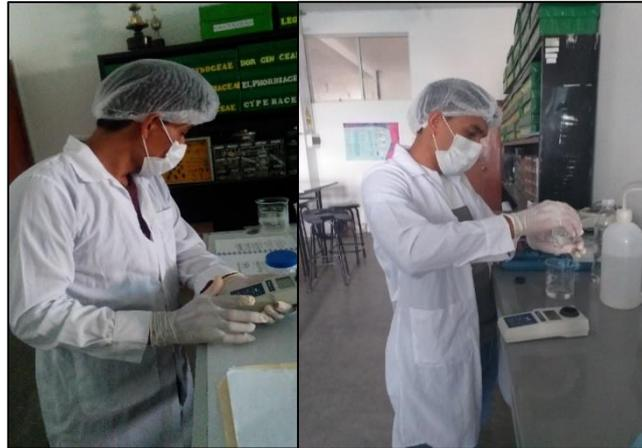
**Figura 10. Determinación de la turbidez de los cinco puntos de monitoreo.**
