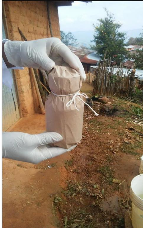
**Figura 06. Preservación de las muestras en termos con hielo para transportarlos al laboratorio para su inmediato análisis.**
