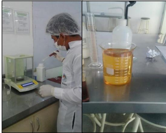
**Figura 14. Llenado de las botellas Winkler con la dilución y medición del O<sub>2</sub> inicial.**
