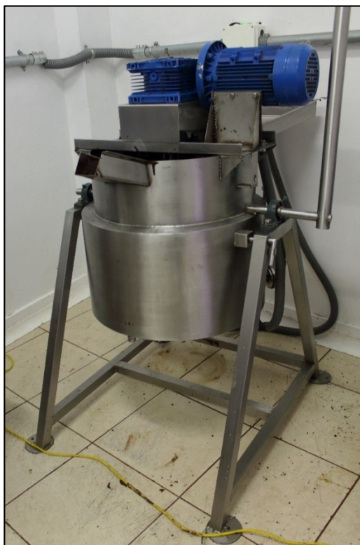
Fotografía 9 Conchadora rotativa vertical donde se implementó el prototipo. Fuente : Elaboración propia.
