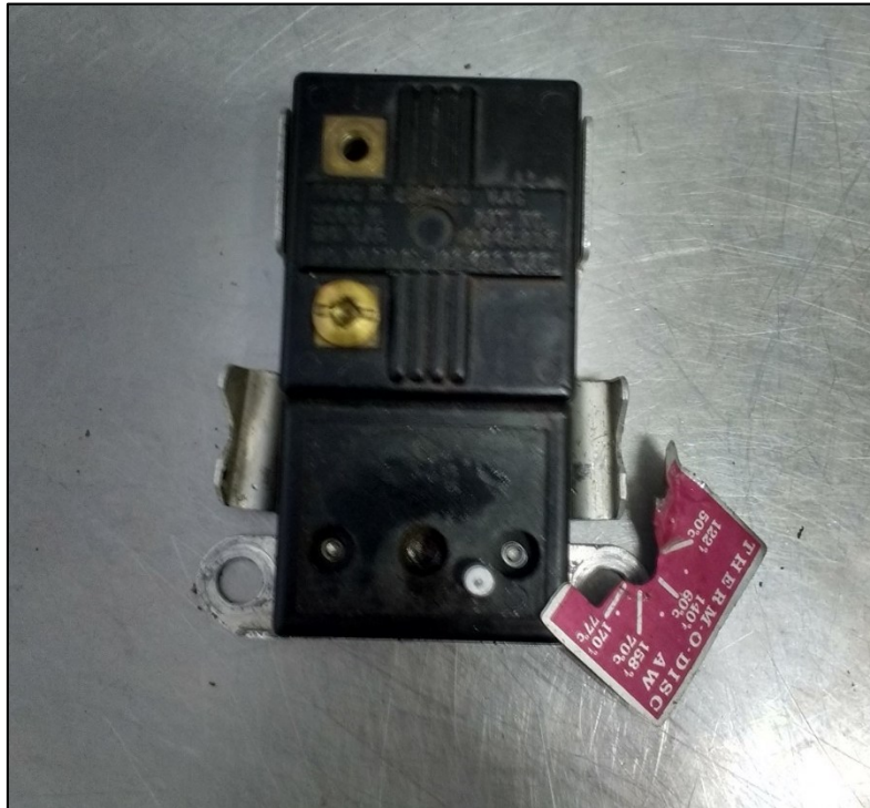
Fotografía 10 Termostato THERMO – DISC en mal estado.
