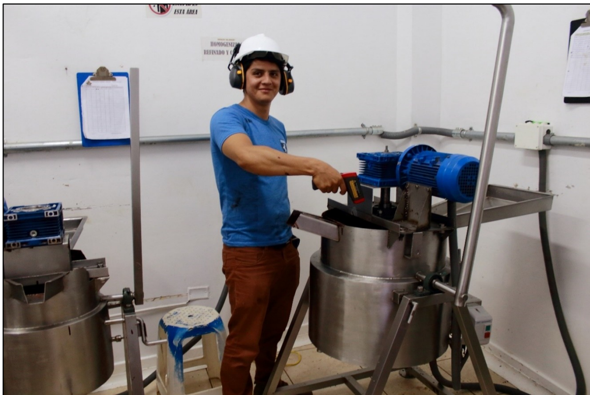
Fotografía 7 Medición de temperatura con termómetro láser. Fuente : Elaboración propia.
