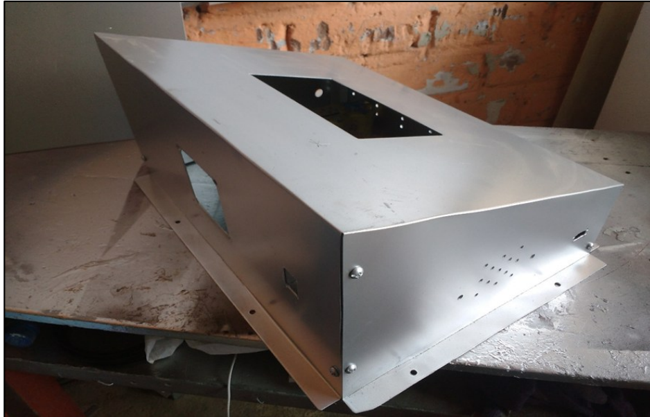
Figura 52 Cortado de tablero para el anclaje de los dispositivos. Fuente : Elaboración propia.
