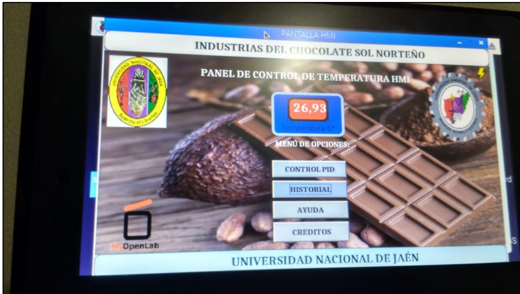
Figura 61 Menú HMI en funcionamiento durante un proceso real.
