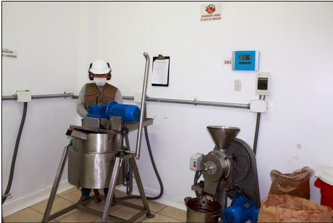
Fotografía 6 Mediciones de temperatura en el proceso de conchado. Fuente : Elaboración propia.
