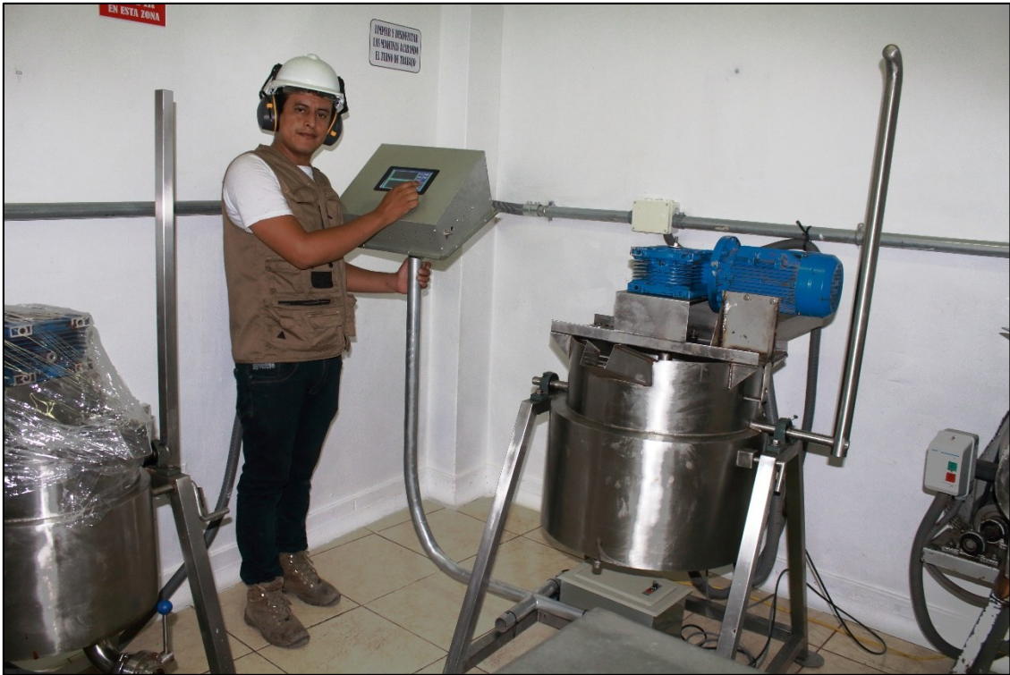
Fotografía 22 Pruebas finales de prototipo automatizado para el control y monitoreo de temperatura.
