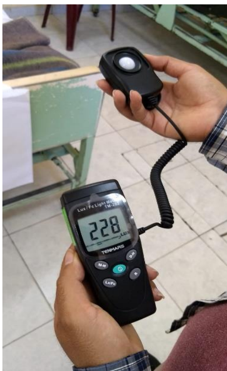
Figura 26: Toma de datos del luxómetro en el área de pediatría.
