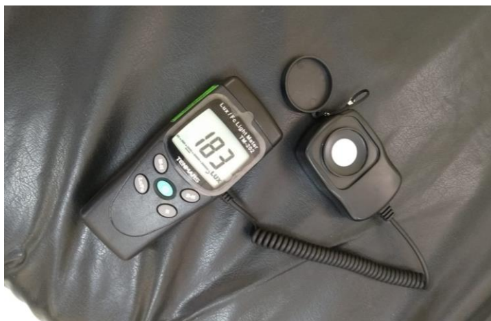
Figura 25: Toma de datos del luxómetro del área de emergencia.
