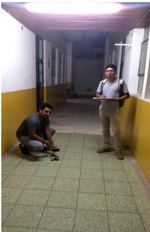
Figura 32: Toma de datos del luxómetro en el pasillo del área de cirugía.
