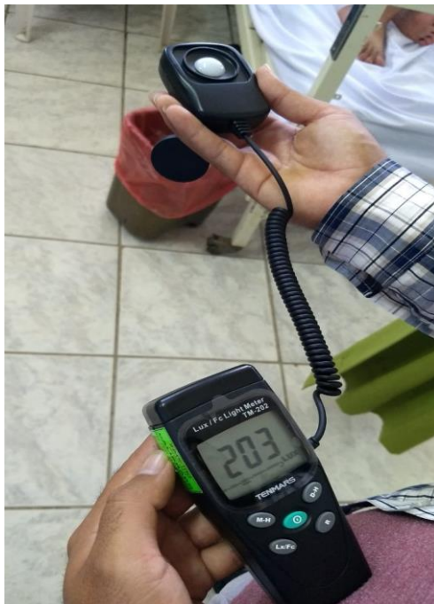
Figura 35: Toma de datos del luxómetro en el área de Pediatría
