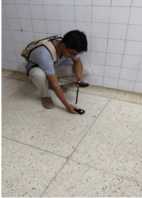
Figura 36: Toma de datos del luxómetro en el pasadizo del área de pediatría.
