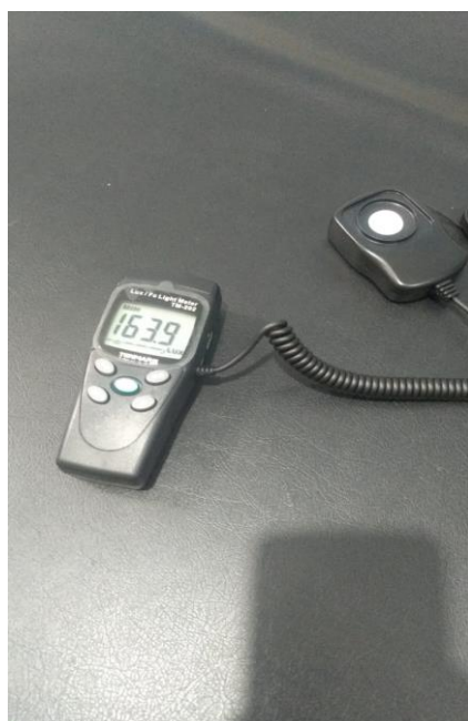
Figura 33: Toma de datos del luxómetro en el área de cirugía
