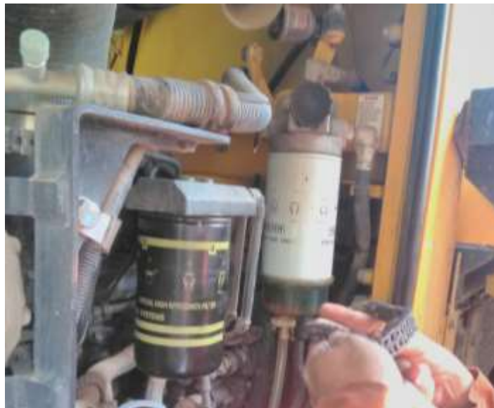
Figura 8. Mantenimiento preventivo cambio de filtros – Cargador frontal Komatsú WA-180
