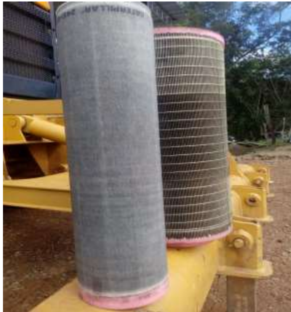
Figura 9. Mantenimiento Preventivo cambio de filtro de aire - Motoniveladora Caterpillar 120K
