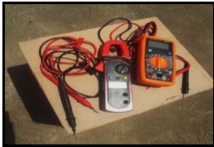
Figura 38. Pinza amperimétrica y multímetro.
