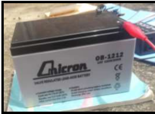
Figura 16. Batería 12 V 12 Ah Fuente: Autosolar.pe
