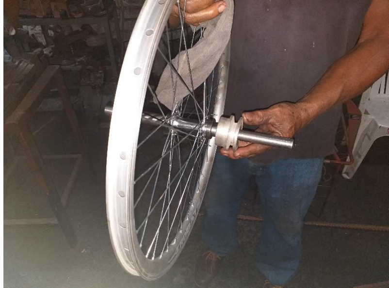
Figura 27. Ensamble de la polea de 2 ½” y el aro de llanta para bicicleta de 24” en el eje de transmisión.
