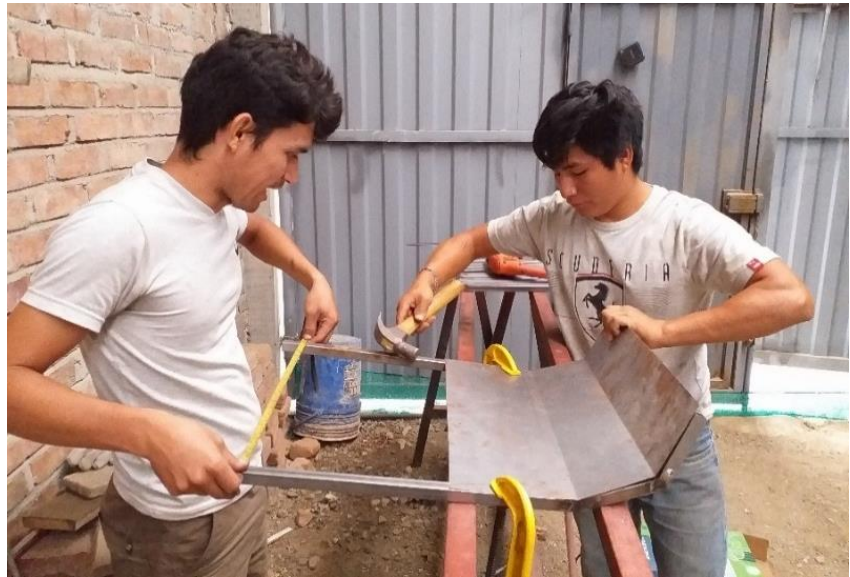
Figura 21. Marcación de los puntos a perforar en álabes y soportes. Fuente: Elaboración propia
