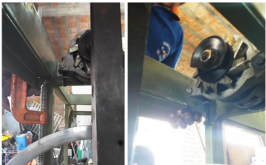
Figura 28. Instalación del alternador eléctrico.
