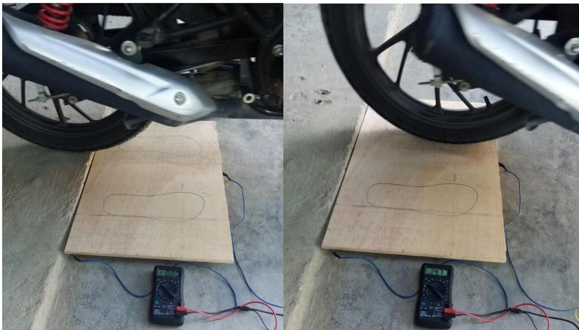
Figura 20: Pruebas de laboratorio con vehículo (moto lineal) y registro del voltaje generado: (Izquierda) Antes y (Derecha) Durante el paso del vehículo.
