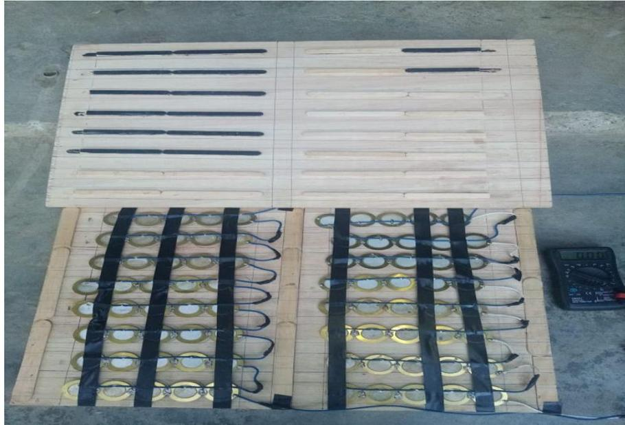
Figura 16: Agrupación del sistema piezoeléctrico 0.52 m x 0.52 m.
