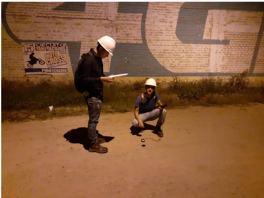
Figura 25. Medición del nivel de iluminación actual. Fuente: Elaboración Propia.
