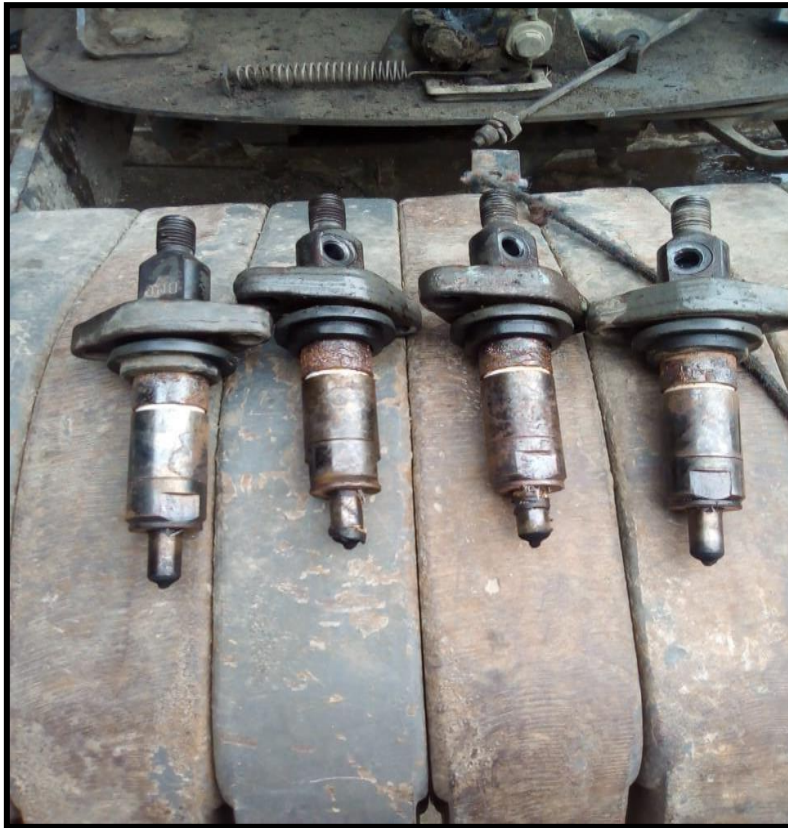
Figura N° 3. Mantenimiento correctivo cambio de toberas-Tractor Massey Ferguson 4290 Fuente: Agronegocios Arteaga S.A.C
