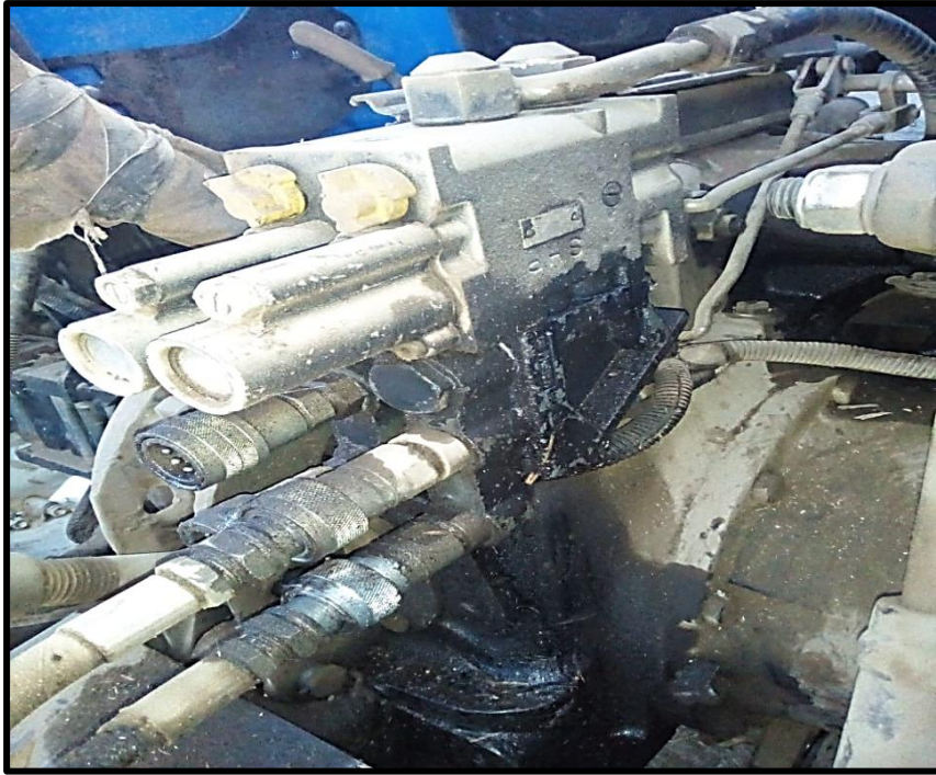
Figura N° 22. Fugas de aceite por la reversible del sistema hidráulico en el tractor New Holland TB110 Fuente: Autoría propia
