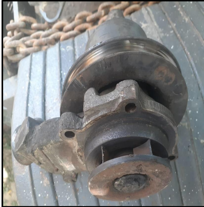
Figura N° 5. Mantenimiento correctivo cambio de rodaje y sello-Tractor Massey Ferguson 4290 Fuente: Agronegocios Arteaga S.A.C
