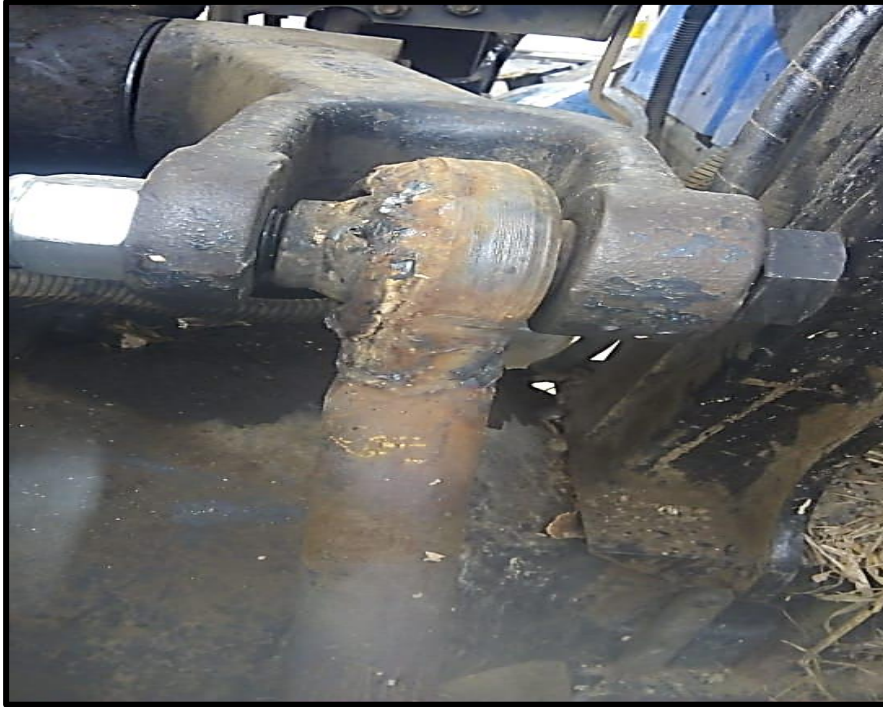
Figura N° 24. Brazo nivelador soldado del tractor New Holland TB110 Fuente: Autoría propia
