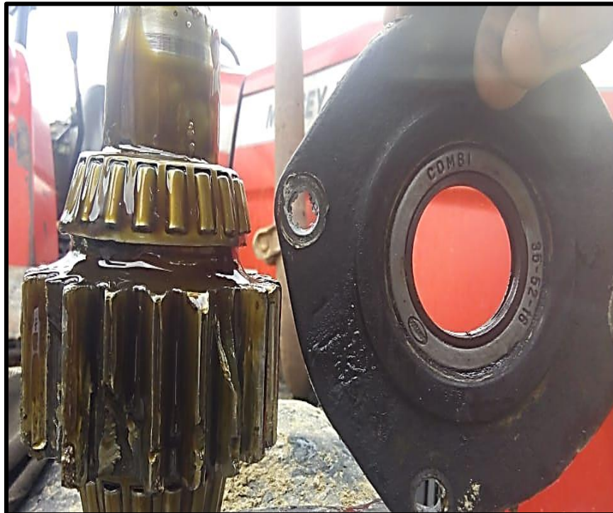
Figura N° 21. Dientes del piñón solar rotos del cardán de la transmisión delantera en el tractor Massey Ferguson 4290 Fuente: Autoría propia
