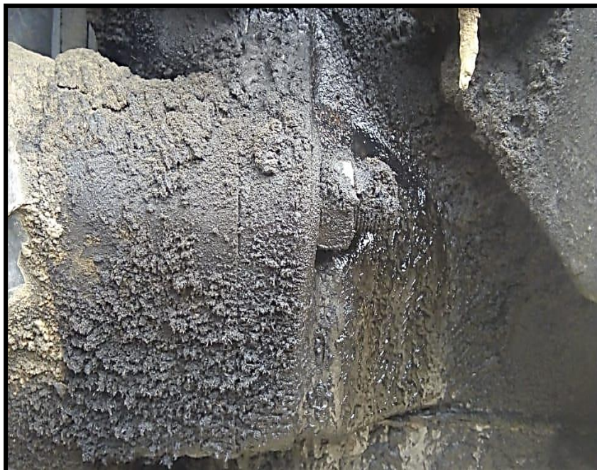
Figura N° 19. Fugas de aceite por el bloque motor en el tractor Massey Ferguson 4290 Fuente: Autoría propia
