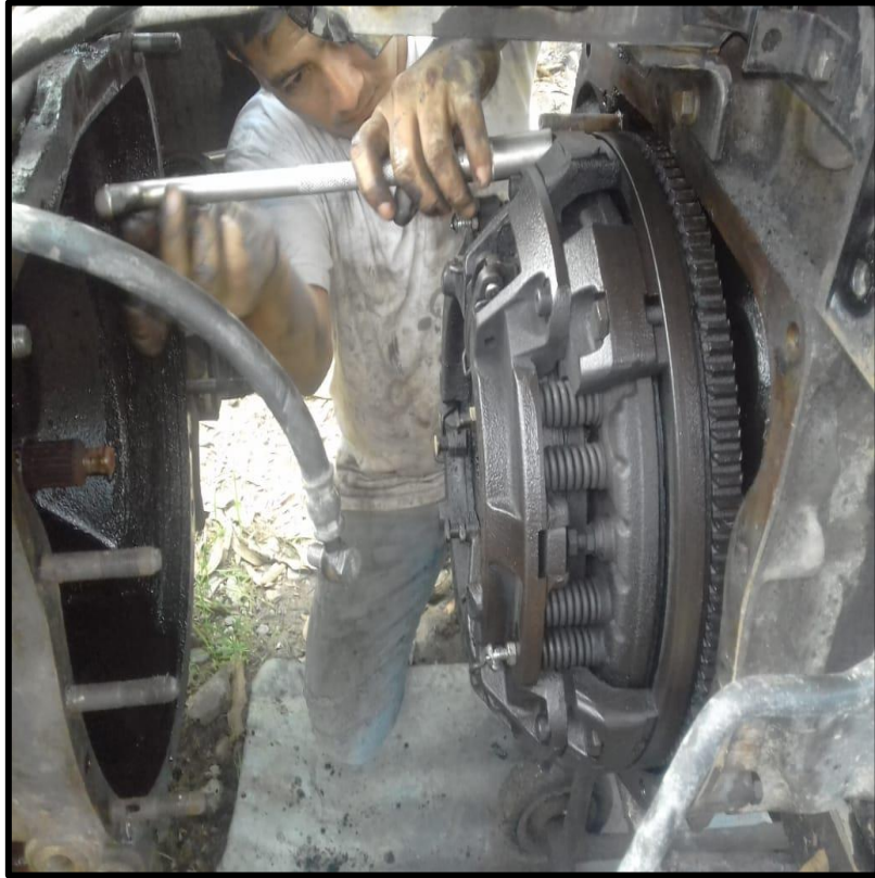
Figura N° 4. Mantenimiento correctivo cambio del disco de embrague-Tractor Massey Ferguson 4290 Fuente: Agronegocios Arteaga S.A.C
