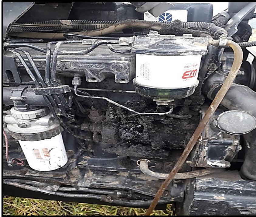
Figura N| 26. Fugas de petróleo por la bomba de inyección en el tractor New TB110 Fuente: Autoría propia
