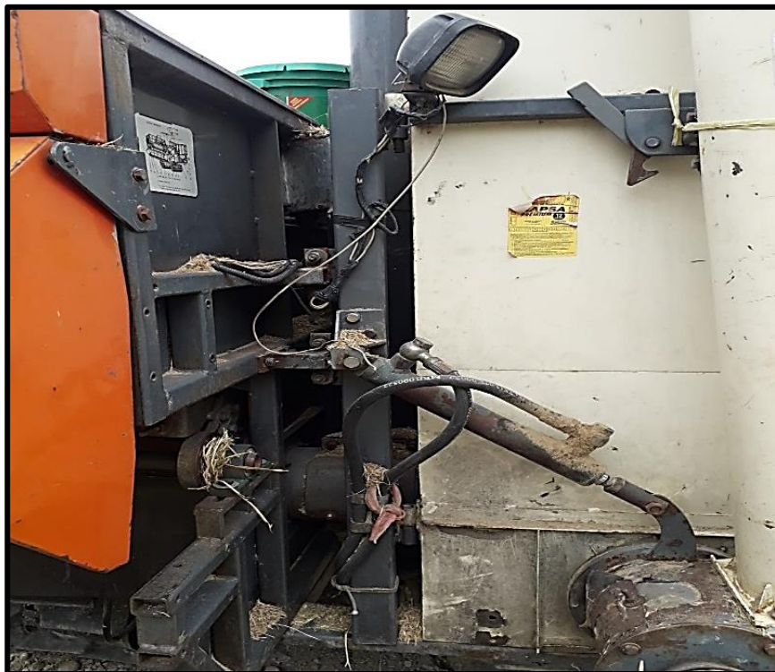
Figura N° 29. Foco del faro delantero sin funcionar en la cosechadora Zukai 4LZ-350
