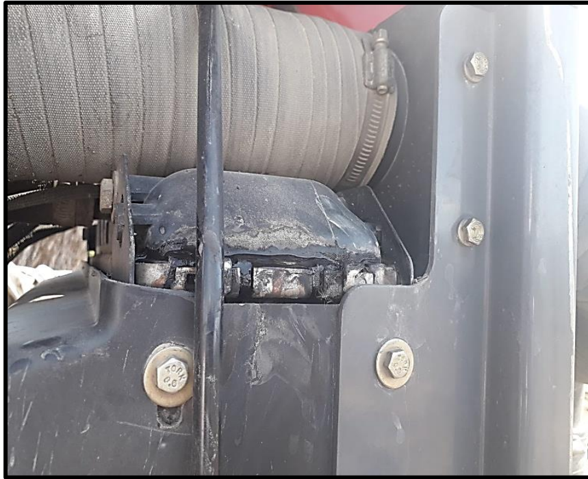
Figura N° 20. Fugas de agua por el radiador del tractor Massey Ferguson 4290 Fuente: Autoría propia
