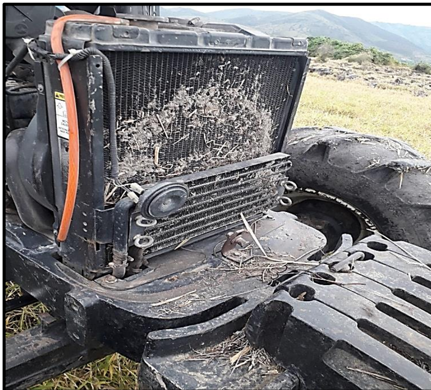
Figura N° 27. Falta de limpieza del radiador en el tractor New Holland TB110 Fuente: Autoría propia
