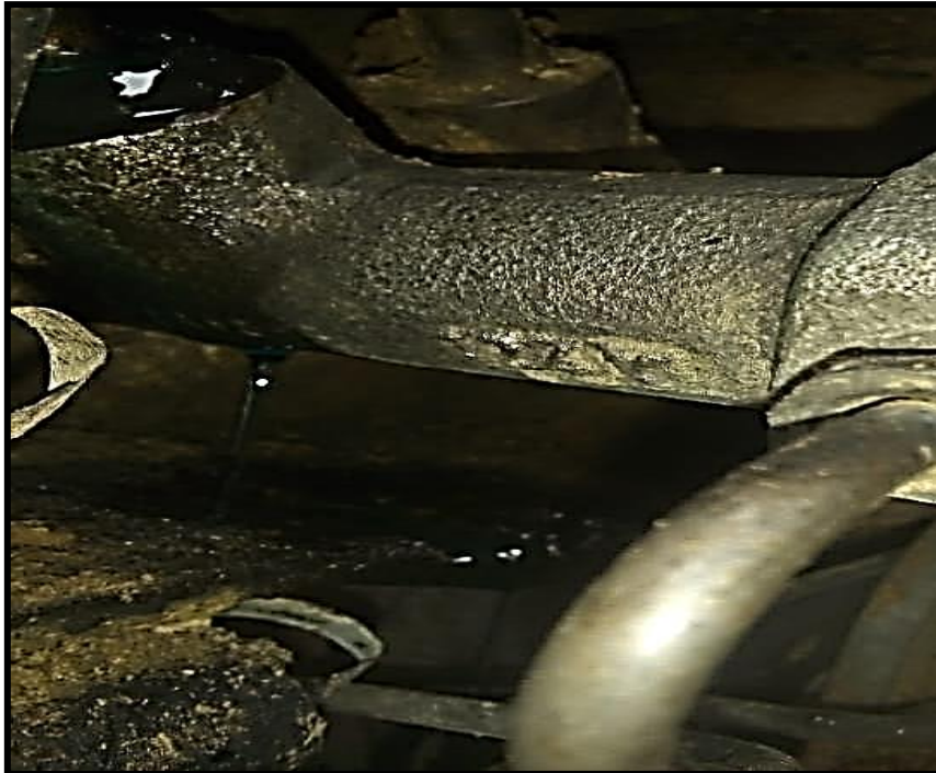
Figura N° 18. Fugas de líquido de freno en el tractor Massey Ferguson 4290 Fuente: Autoría propia
