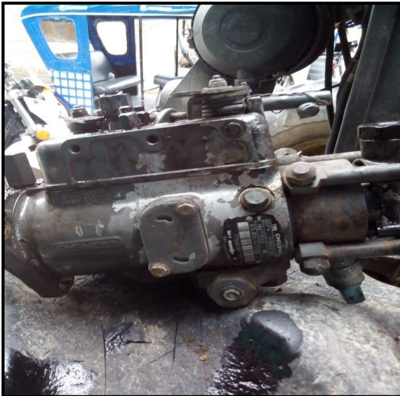
Figura N° 2. Mantenimiento correctivo cambio de cabezal-Tractor Massey Ferguson 4290 Fuente: Agronegocios Arteaga S.A.C
