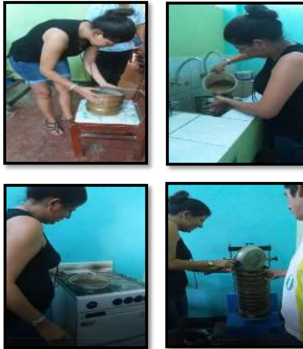
Figura 154. Figura 155. Figura 156. Figura 157. Figura 158. Figura 159. Segunda prueba de análisis granulométrico por tamizado de Santa Rosa - Shanango
