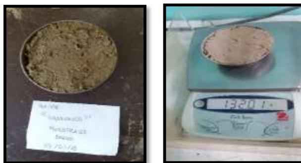
Figura 147. Figura 148. Segunda prueba del Control de Humedad - S.R.Shanango
