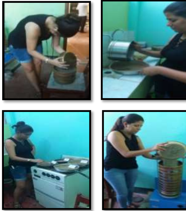
Figura 172. Figura 173. Figura 174. Figura 175. Figura 176. Figura 177. Segunda prueba de análisis granulométrico por tamizado - Shanango
