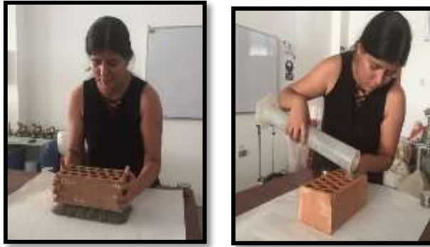
Figura 347. Figura 348. Figura 349. Figura 350. Tercera prueba de Porcentaje de vacíos.
