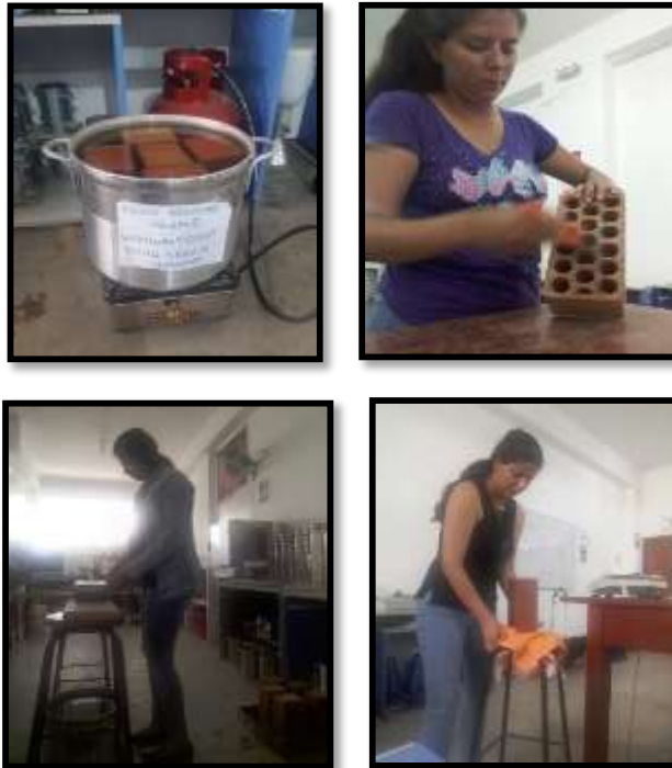
Figura 343. Figura 344. Figura 345. Figura 346. Tercera prueba de Densidad - Shanango
