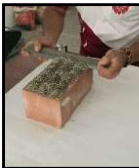
Figura 144. Eliminamos arena para ensayo de porcentaje de vacíos
