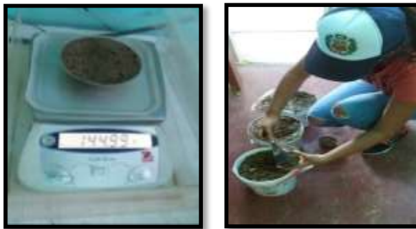
Figura 255. Figura 256. Tercera prueba del Control de Humedad - S.R. de Shanango
