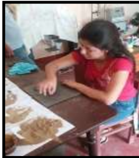
Figura 197. Segunda prueba de Limite Plástico - Nuevo Morero.
