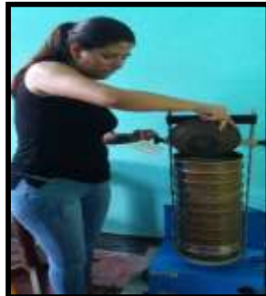
Figura 58. Figura 59. Figura 60. Figura 61. Figura 62. Figura 63. Primera prueba de análisis granulométrico por tamizado - Nuevo Morero
