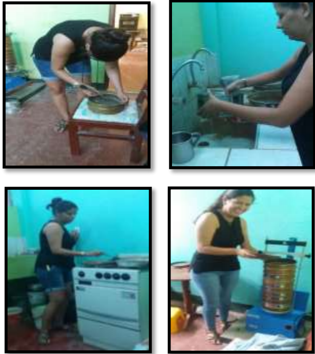
Figura 166. Figura 167. Figura 168. Figura 169. Figura 170. Figura 171. Segunda prueba de análisis granulométrico por tamizado - Nuevo Morero
