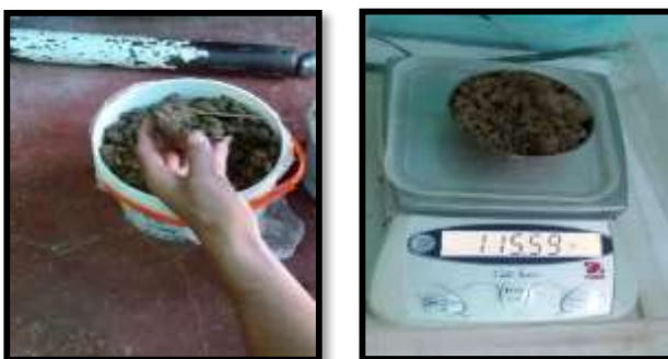
Figura 261. Figura 262. Tercera prueba del Control de Humedad - S.R.Shanango.
