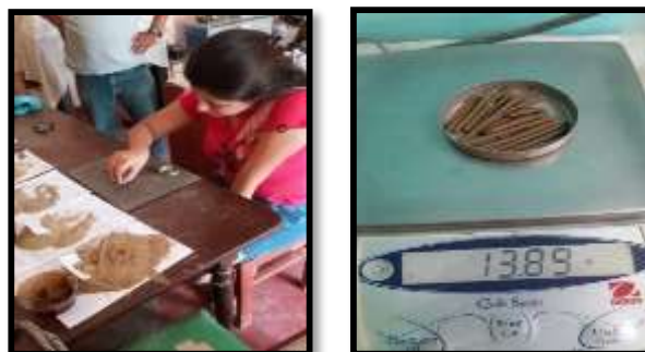
Figura 90. Figura 91. Primera prueba del límite plástico – Shanango
