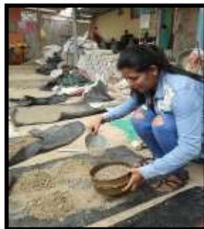
Figura 70. Zarandeo de muestra para primera prueba de límite líquido
