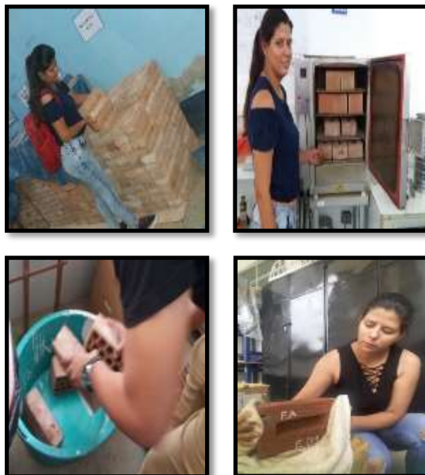
Figura 97. Figura 98. Figura 99. Figura 100. Primera prueba del ensayo de Absorción - Fila Alta.
