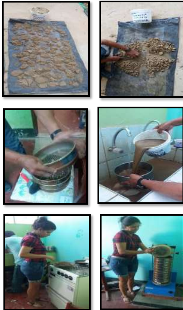
Figura 263. Figura 264. Figura 265. Figura 266. Figura 267. Figura 268. Tercera prueba de análisis granulométrico por tamizado - Santa Rosa de Shanango
