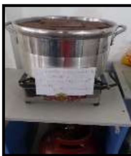
Figura 124. Hirviendo especímenes para ensayo de Densidad
