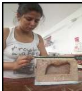
Figura 111. Medición del ladrillo con vernier
