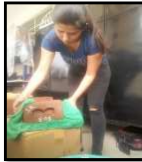
Figura 96. Secado superficial de la UA para ensayo de Absorción
