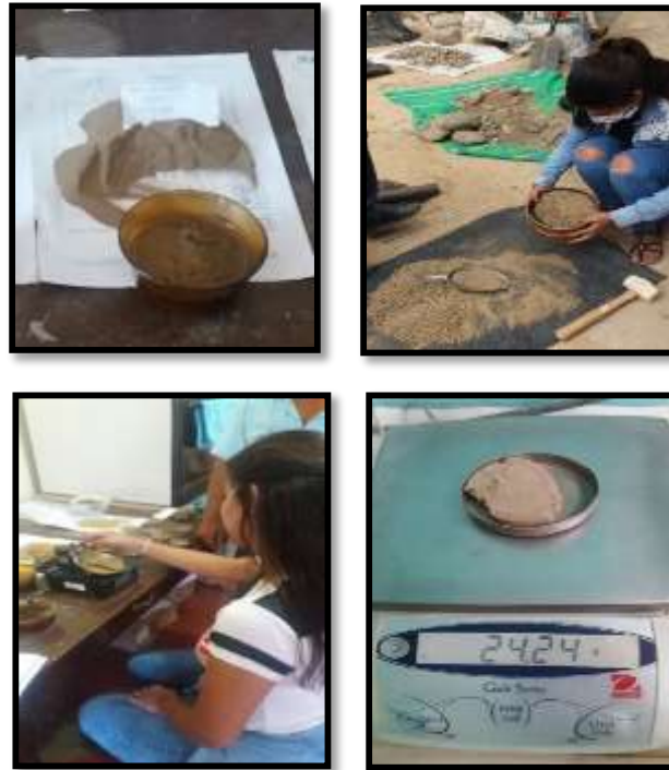
Figura 73. Figura 74. Figura 75. Figura 76. Primera prueba del ensayo Limite Liquido - Fila Alta
