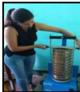
Figura 52. Figura 53. Figura 54. Figura 55. Figura 56. Figura 57. Primera prueba de análisis granulométrico por tamizado - Fila Alta
