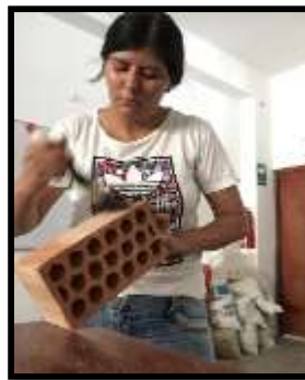
Figura 141. Eliminando partículas para ensayo de porcentaje de vacíos
