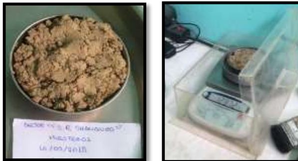
Figura 43. Figura 44. Primera prueba para el contenido de humedad - Shanango
