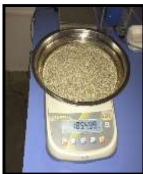
Figura 146. Peso de arena para ensayo de porcentaje de vacíos
