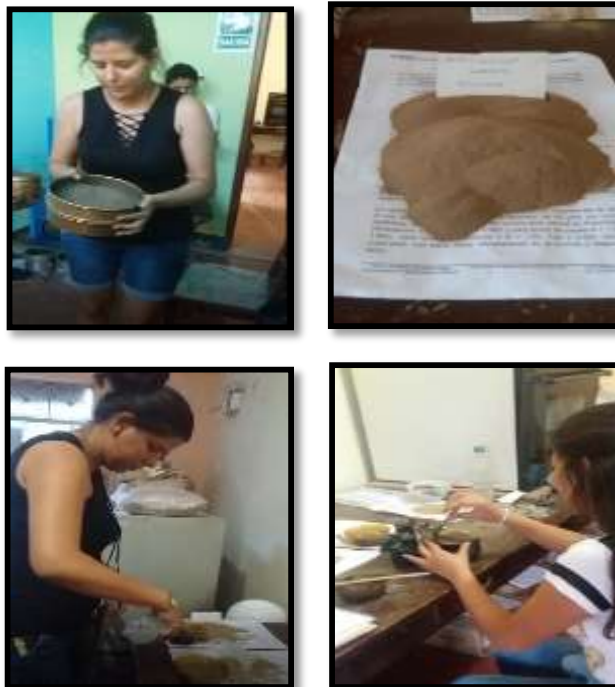
Figura 182. Figura 183. Figura 184. Figura 185. Segunda prueba de Limite Líquido - Fila Alta
