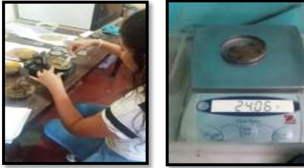
Figura 77. Figura 78. Figura 79. Figura 80. Primera prueba del ensayo Limite Liquido - Nuevo Morero
