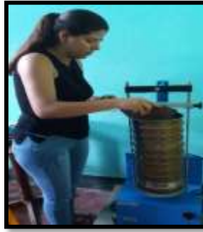
Figura 51. Tamizado eléctrico para análisis granulométrico
