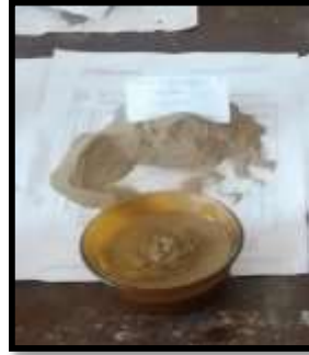
Figura 71. Muestra saturada para primera prueba de límite líquido
