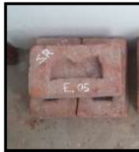
Figura 94. Enfriado de la UA para ensayo de Absorción
