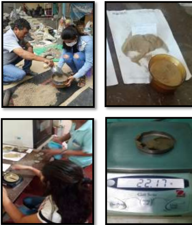
Figura 81. Figura 82. Figura 83. Figura 84. Primera prueba del ensayo Limite Líquido - Shanango
