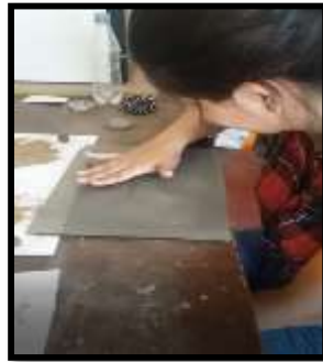
Figura 295. Tercera prueba de Limite Plástico -Santa Rosa Shanango
