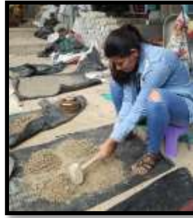
Figura 46. Muestra chancada para análisis granulométrico
