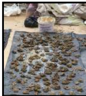
Figura 45. Muestra esparcida para análisis granulométrico
