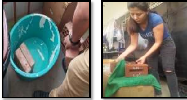
Figura 101. Figura 102. Figura 103. Figura 104. Primera prueba del ensayo de Absorción - Nuevo Morero
