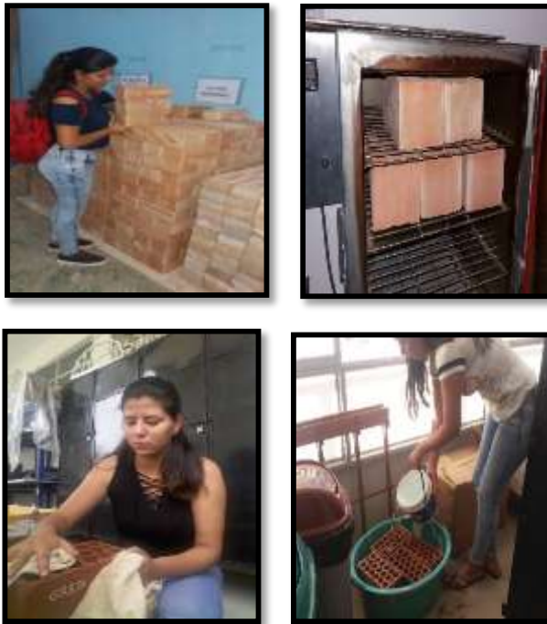
Figura 105. Figura 106. Figura 107. Figura 108. Primera prueba del ensayo de Absorción - Shanango
