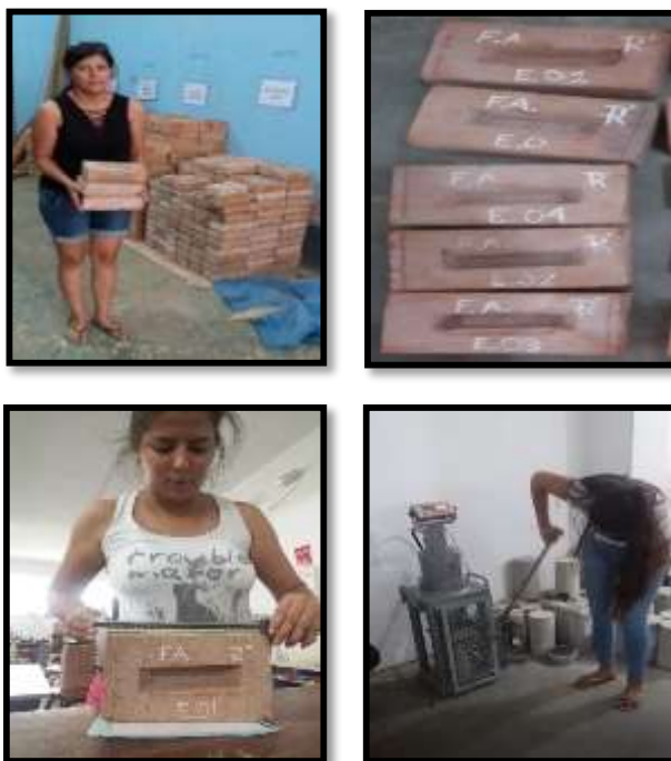
Figura 112. Figura 113. Figura 114. Figura 115. Primera prueba del ensayo de Resistencia - Fila Alta
