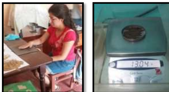
Figura 88. Figura 89. Primera prueba del límite plástico - Nuevo Morero
