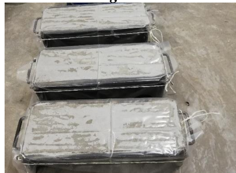
Figura 61. Testigos prismáticos terminados
