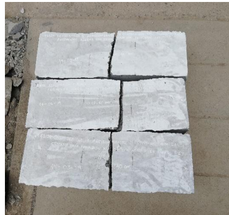
Figura 72. Testigos prismáticos ensayados
