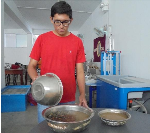
Figura 20. Inmersión del AG en agua
