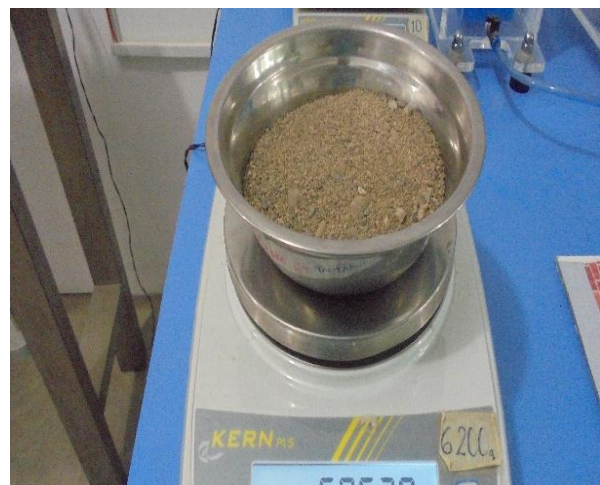
Figura 34. Secar en el horno y pesar la muestra.
