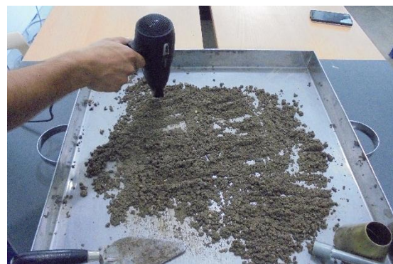
Figura 28. Secado del A.F. con secadora
