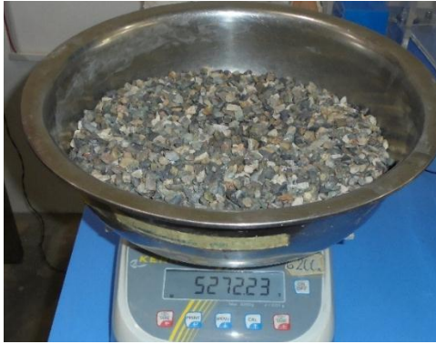
Figura 17. Pesado inicial de muestra seca
