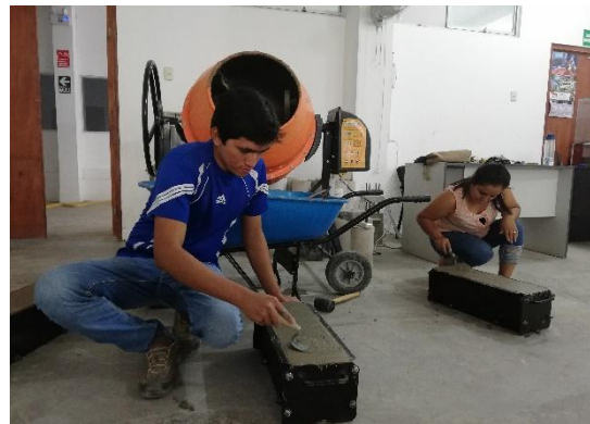
Figura 59. Enrasado de la superficie de testigos
