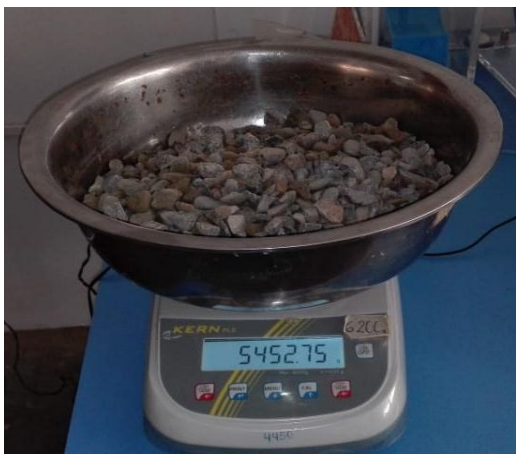
Figura 15. Muestra húmeda para determinar contenido de humedad
