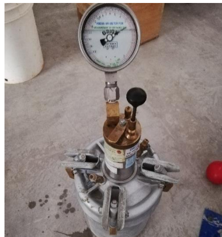
Figura 55. Medición del contenido de aire
