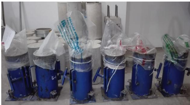
Figura 60. Testigos cilíndricos terminados
