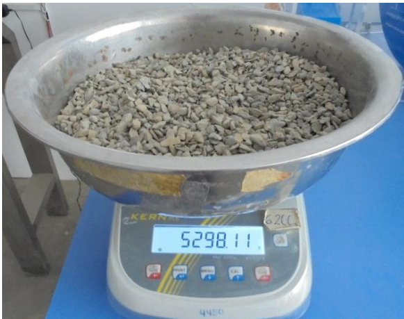
Figura 22. Pesado de la muestra en condición de saturación con superficie seca
