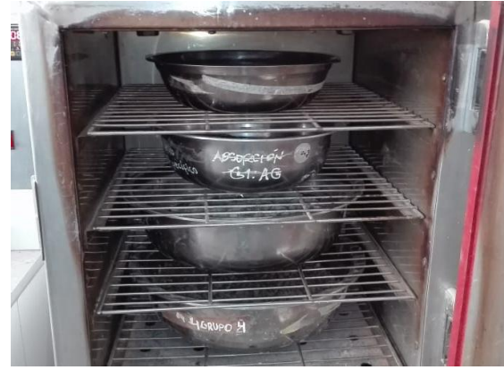
Figura 13. Secado de la muestra al horno
