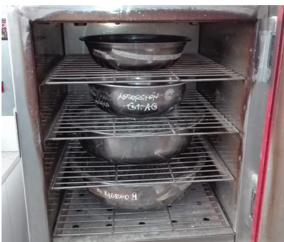
Figura 24. Secado de la muestra en horno
