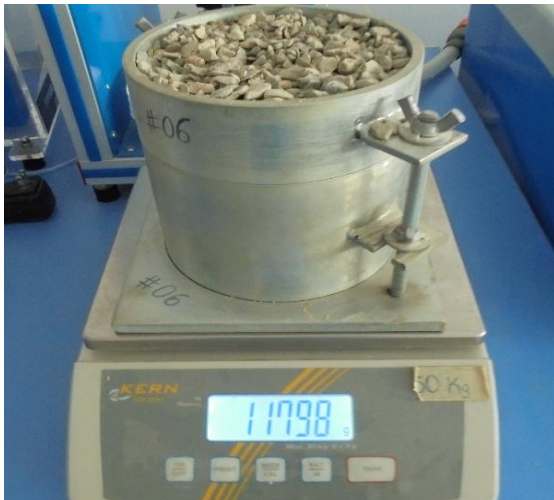
Figura 43. Determinar el peso del recipiente con su contenido y luego vacío
