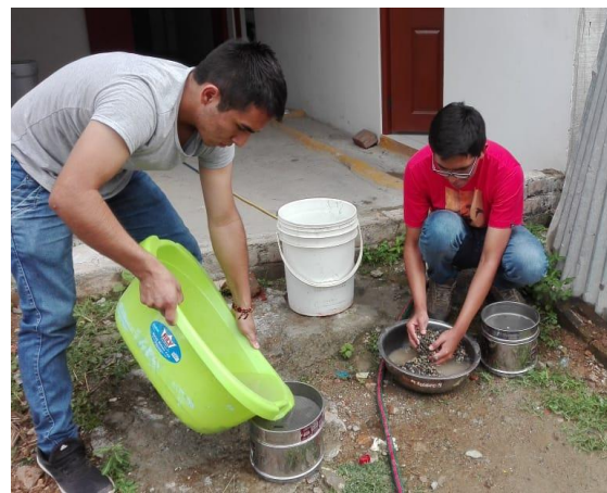
Figura 16. Lavado de material en el tamiz N° 200
