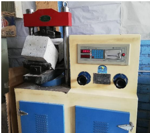
Figura 71. Rotura de testigos prismáticos
