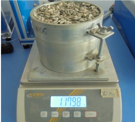
Figura 38. Determinar el peso del recipiente con su contenido y luego vacío
