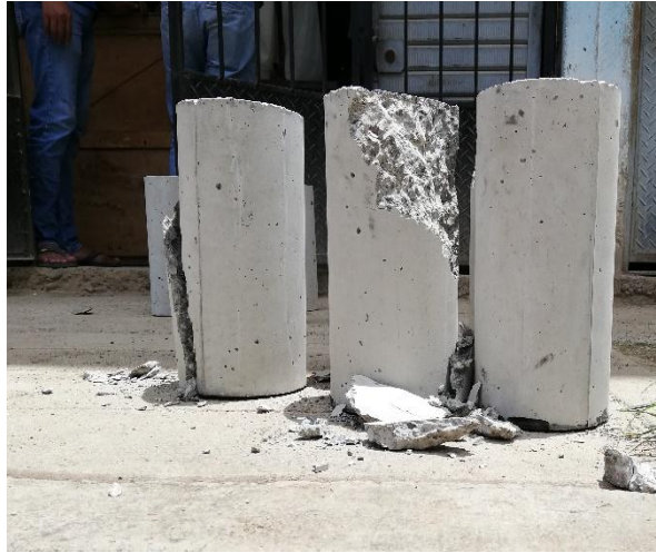
Figura 68. Testigos cilíndricos ensayados
