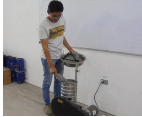
Figura 18. Tamizado mecánico de agregados
