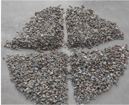
Figura 9. Material dividido en cuatro partes iguales
