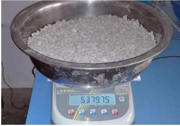
Figura 12. Determinación de la masa del Agregado
