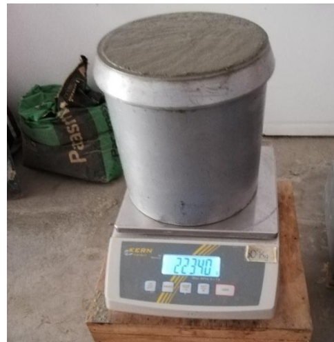
Figura 52. Peso del recipiente más concreto
