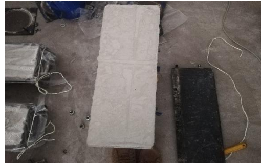
Figura 63. Desmoldado de testigos prismáticos
