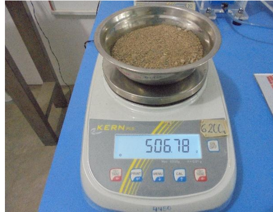
Figura 30. Pesado de la muestra SSS
