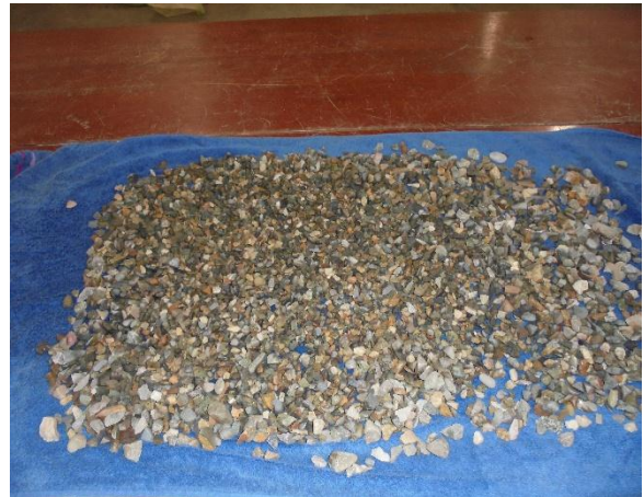
Figura 21. Eliminación del agua superficial
