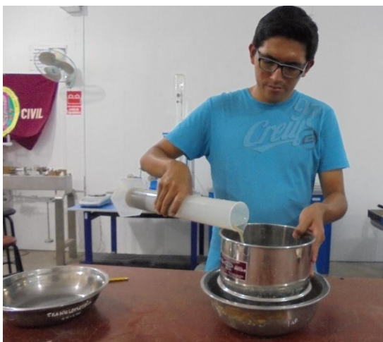
Figura 33. Decantar el exceso de agua
