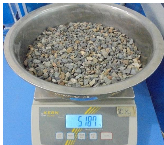
Figura 25. Determinación del peso seco
