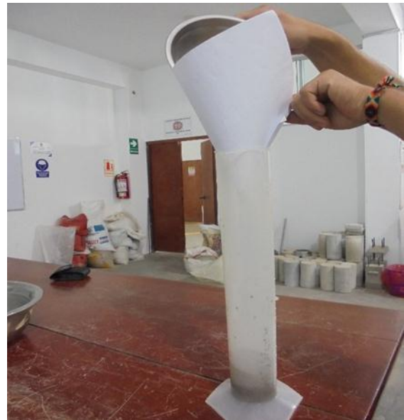
Figura 32. Añadir la muestra SSS en el frasco
