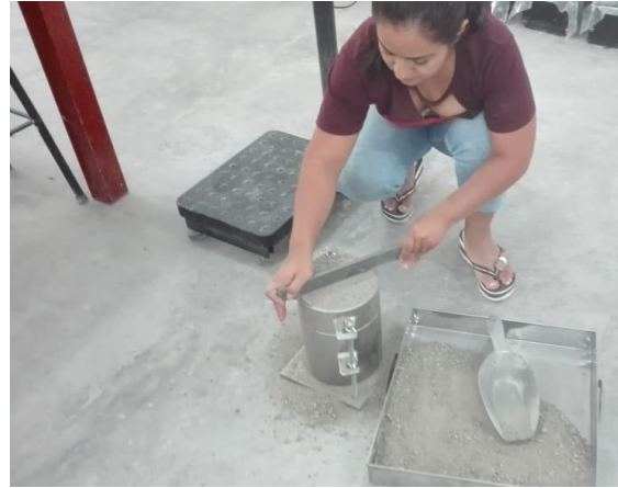
Figura 42. Eliminación de material excedente
