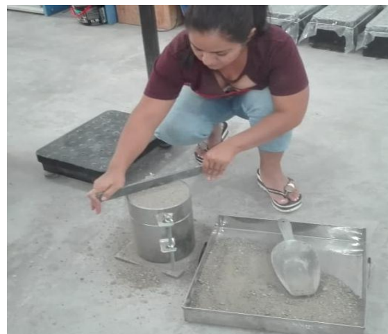
Figura 37. Eliminación de material excedente
