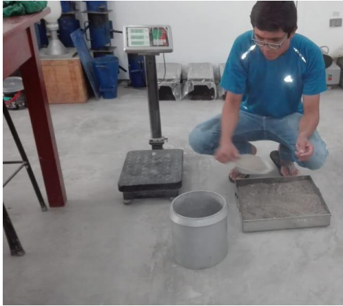
Figura 41. Llenado del recipiente con agregado
