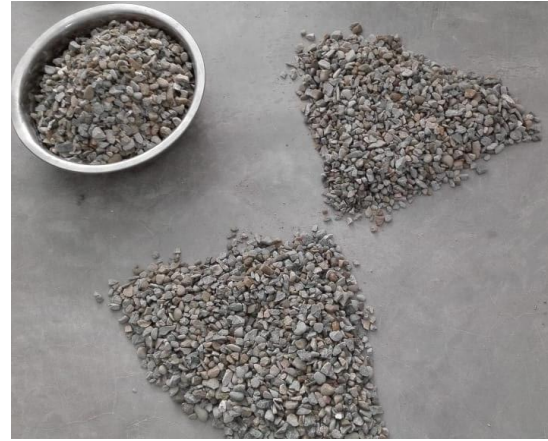
Figura 10. Eliminación de muestras diametralmente opuestas
