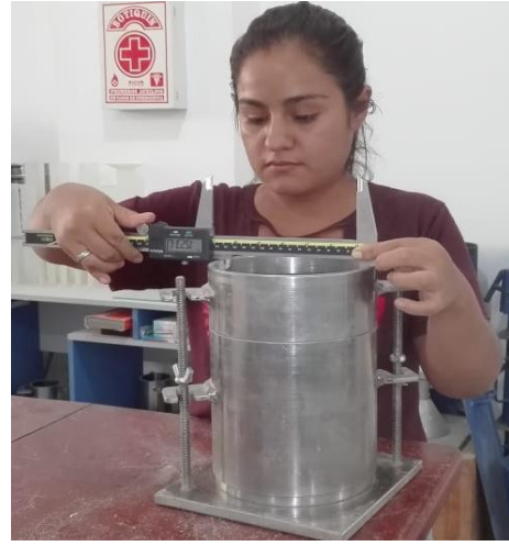
Figura 39. Determinar las dimensiones del recipiente
