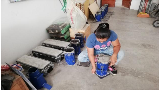
Figura 62. Desmoldado de testigos cilíndricos
