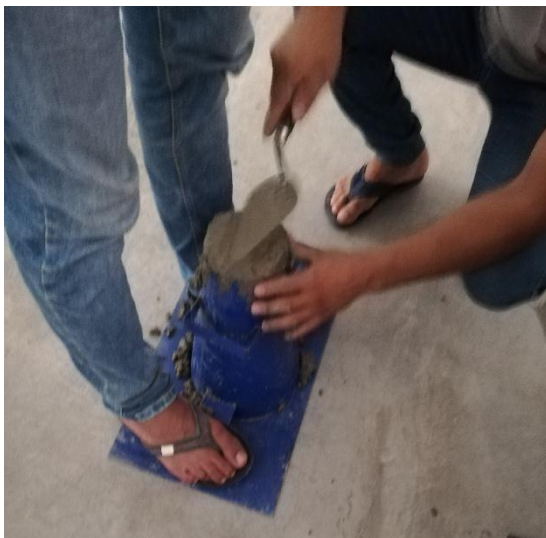
Figura 48. Llenado del cono de Abrams
