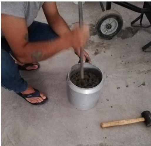
Figura 51. Llenado y varillado del recipiente
