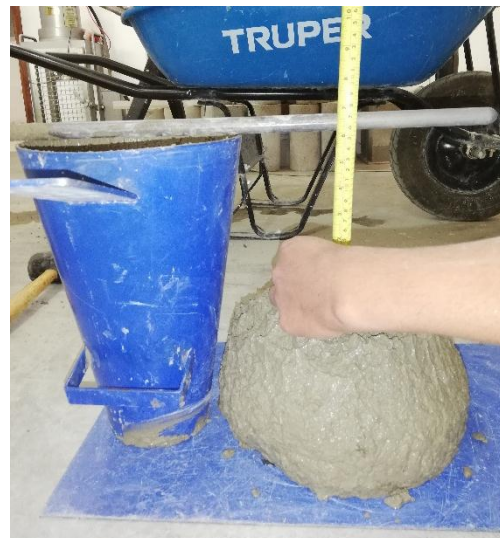
Figura 49. Medición del asentamiento
