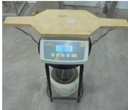
Figura 23. Determinación del peso bajo el agua
