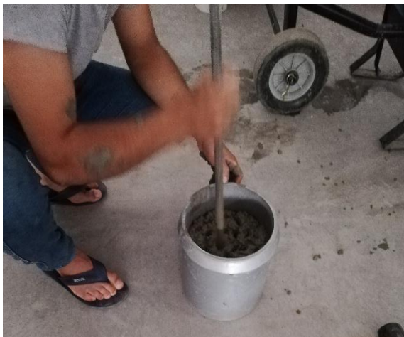
Figura 54. Llenado de la Olla de Washington
