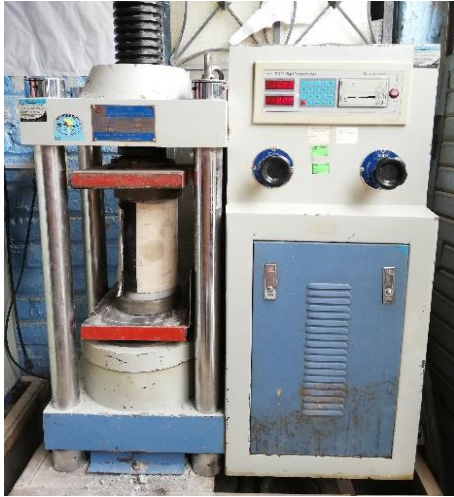
Figura 67. Rotura de testigos cilíndricos
