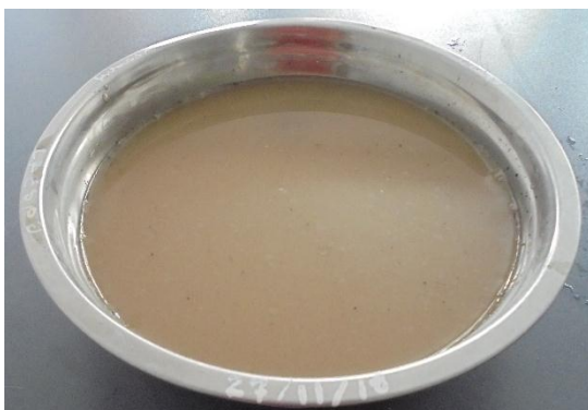
Figura 27. A.F. sumergido en agua
