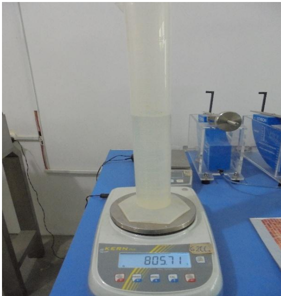
Figura 31. Pesar 500ml de agua en el frasco
