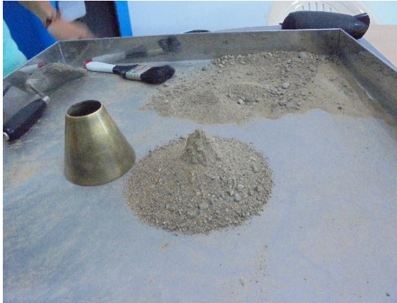
Figura 29. Prueba de humedad superficial
