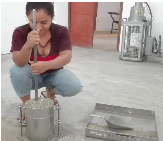
Figura 36. Apisonado del agregado por capas
