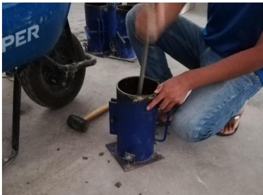
Figura 58. Llenado y varillado de testigos
