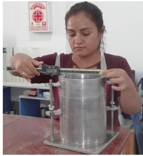
Figura 44. Determinar las dimensiones del recipiente
