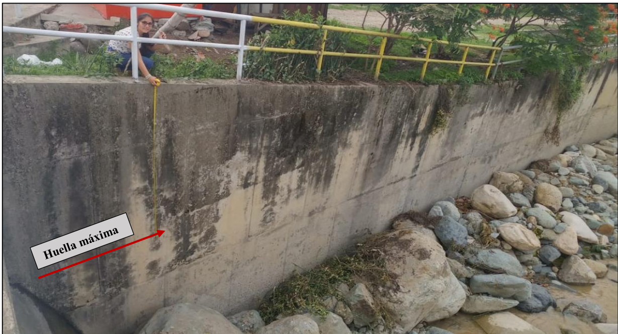
Figura 54. Medición en campo de la huella de agua de la máxima avenida.
