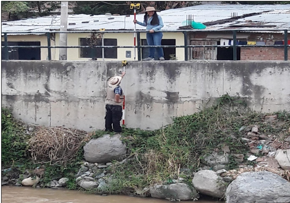
Trabajo en campo de topografía con estación total, toma de detalles de los muros de contención del río Amojú.
