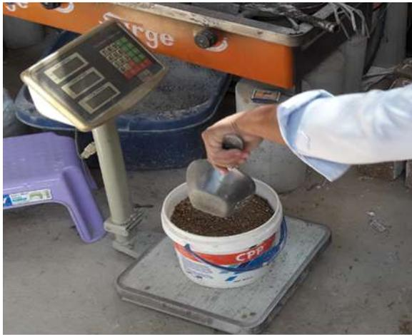
Figura 38. Pesaje de suelo seco en la balanza analítica.
