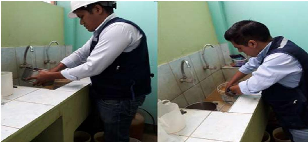
*Figura 5. Realizando ensayo de granulometría por método de lavado.*
