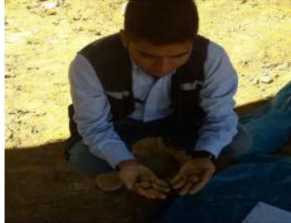
Figura 27. Prueba “Presencia de arcilla” o “Resistencia seca”.
