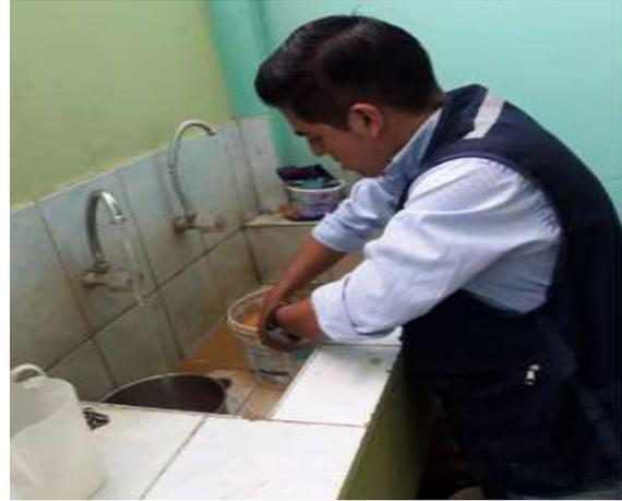
Figura 33. Lavado de la muestra que paso el tamiz N° 4.
