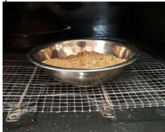
Figura 31. Secado de la muestra.
