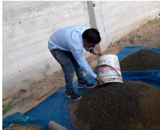
Figura 41. Adición de confitillo a cada muestra de suelo.
