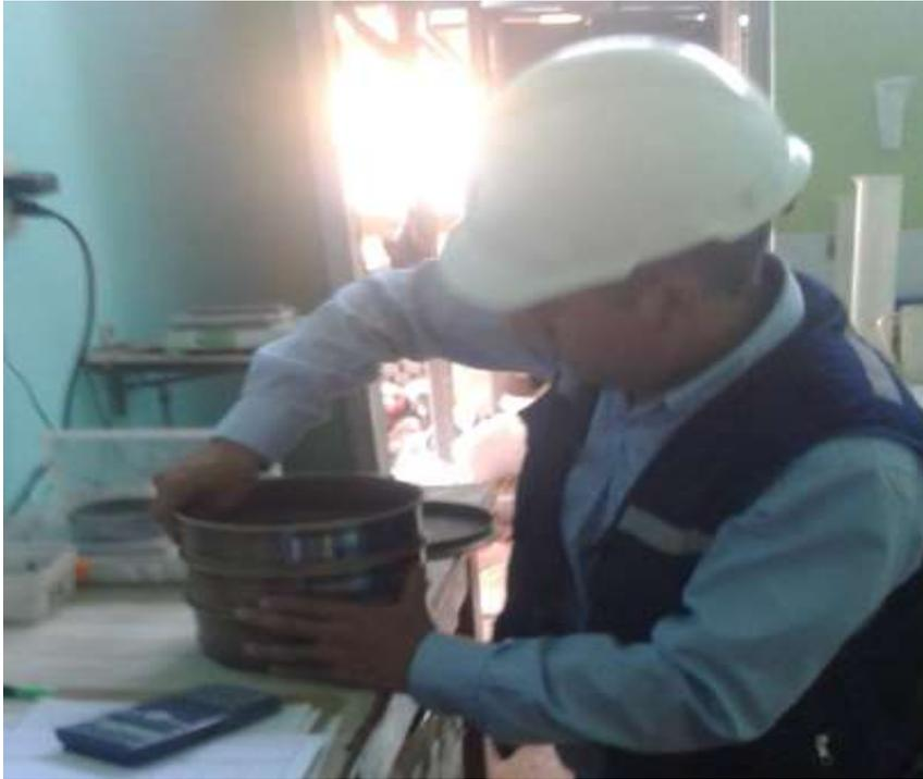
*Figura 7. Realizando la granulometría del material lavado, después de secarse en estufa.*
