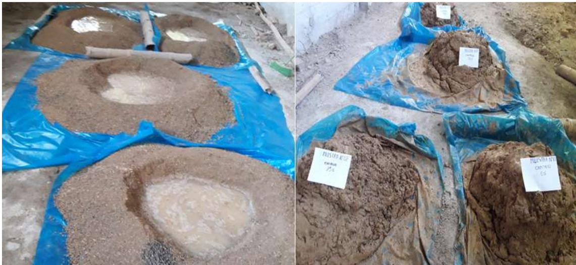
**Figura 13. Dormido de la mezcla durante 48 horas.**
