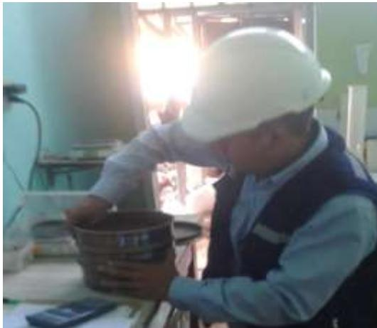
Figura 34. Tamizado después de ser secado la muestra en estufa.
