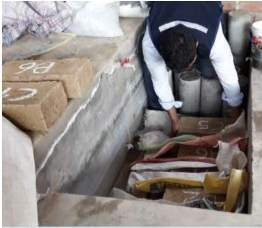
Figura 58. Colocado de adobes para ser sometido al ensayo de absorción.
