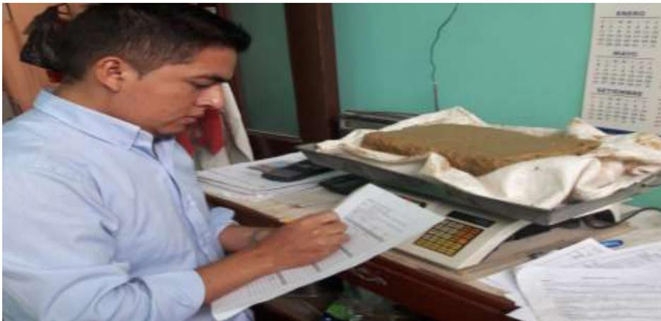
***Figura 18. Pesado de adobe después de estar sumergido 24 horas en agua.***
