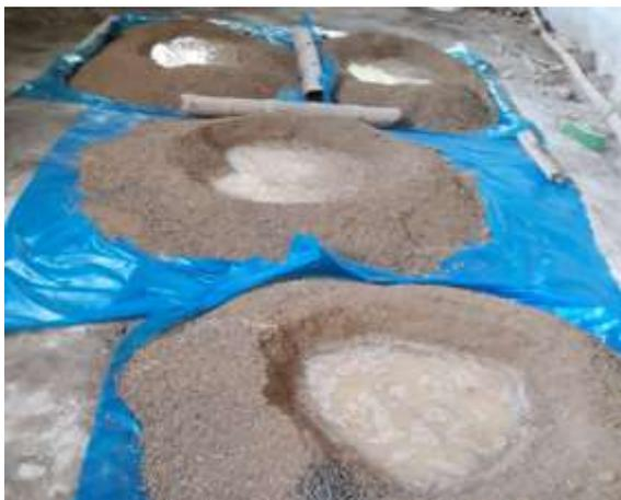
Figura 42. Mezcla homogénea de confitillo, suelo seco y agua.
