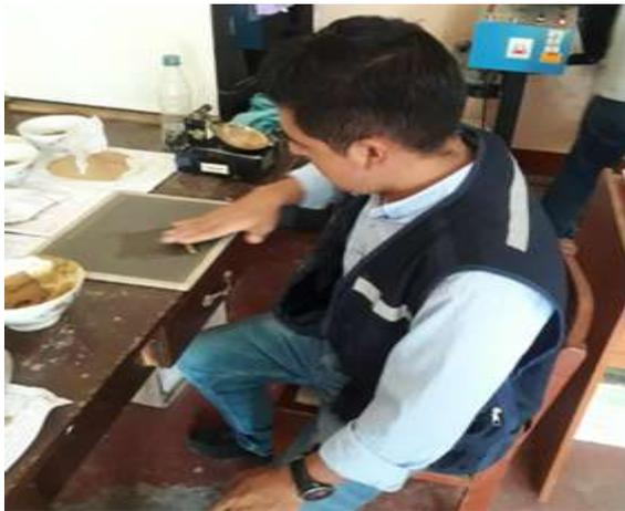
Figura 36. Muestra en proceso de cálculo del Limite Plástico.
