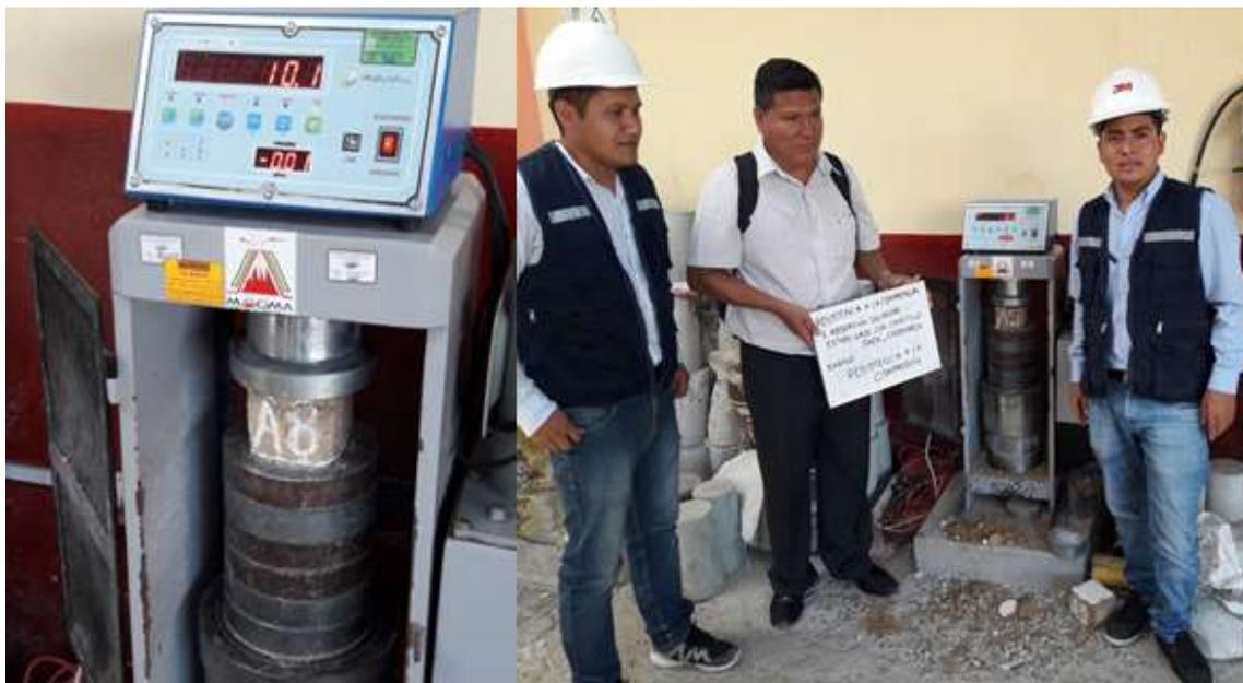
*Figura 16. Resistencia a compresión de las unidades de adobe.*
