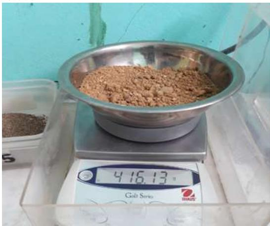
Figura 30. Pesado de la muestra para determinar contenido de humedad.
