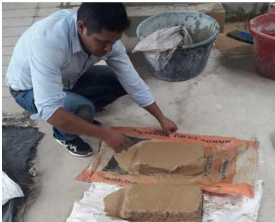
Figura 60. Adobes con 0% de confitillo sumergido en agua durante 24 horas si resiste al agua.
