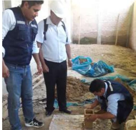
Figura 45. Tesistas y asesor en proceso de fabricación de los adobes para ensayo de resistencia a la compresión.
