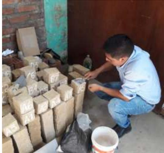
Figura 51. Enrazamiento de la cara superior con yeso de las unidades de adobe (cubos).
