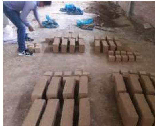
Figura 47. Volteo de adobes después de las cuatro días de secado.
