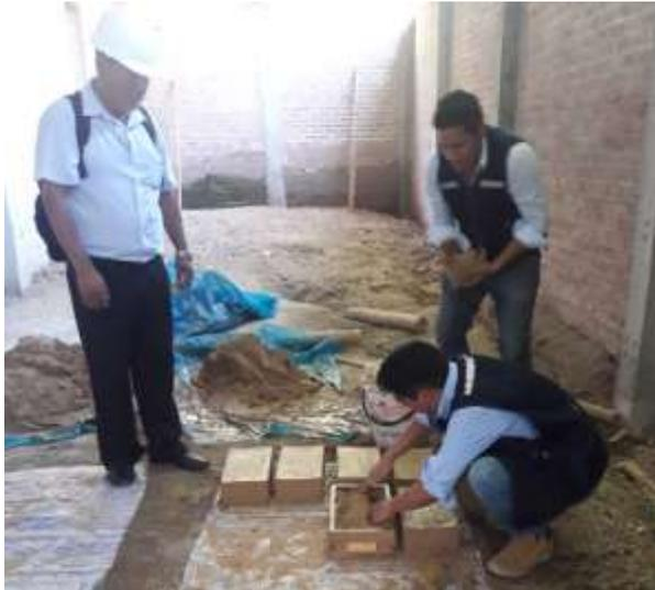
Figura 44. Tesistas y asesor en proceso de fabricación de los adobes para ensayo de absorción.
