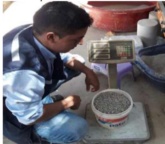
Figura 37. Pesaje de confitillo en la balanza analítica.
