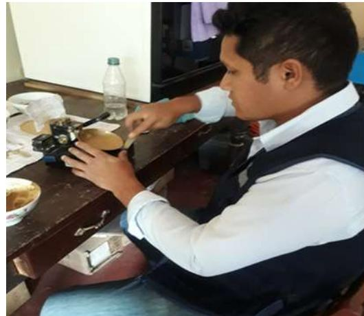
Figura 35. Muestra en proceso de cálculo del Limite Liquido.
