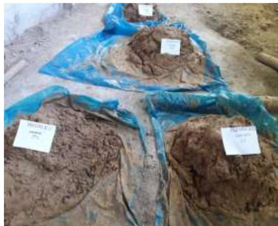
Figura 43. Dormido de la mezcla durante 48 horas.
