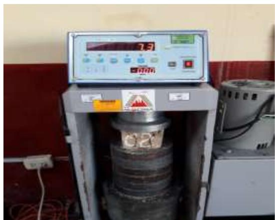
Figura N° 55. Ensayo de resistencia a compresión con 30% de confitillo.
