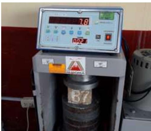
Figura 54. Ensayo de resistencia a compresión con 25% de confitillo.
