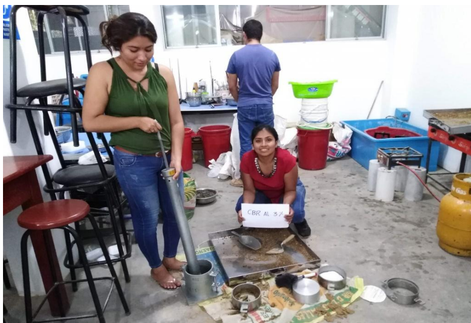
Figura 58. Realizando CBR con ceniza al 3%
