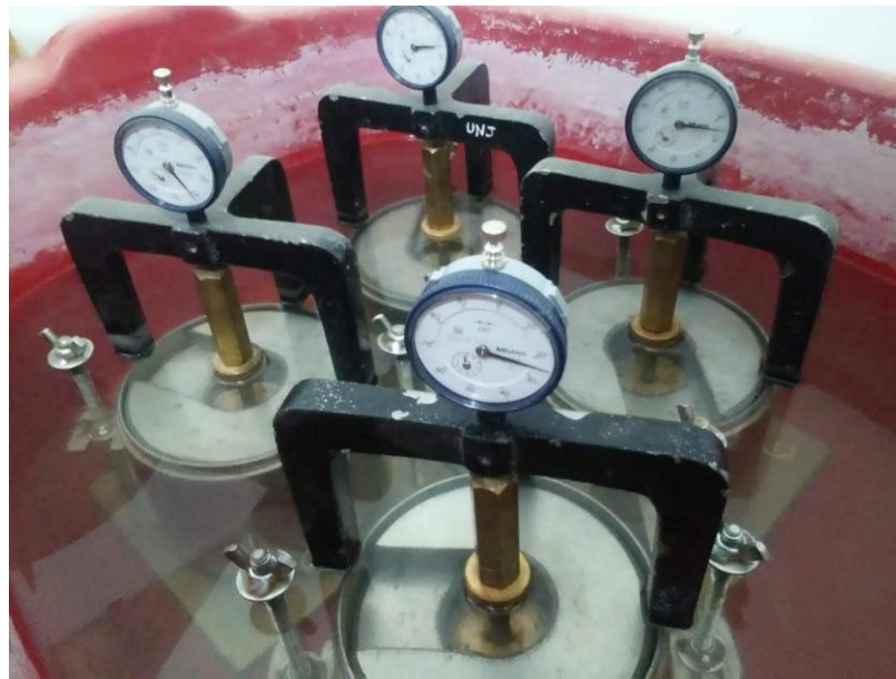
Figura 61. Moldes sumergidos en agua para medir la expansión
