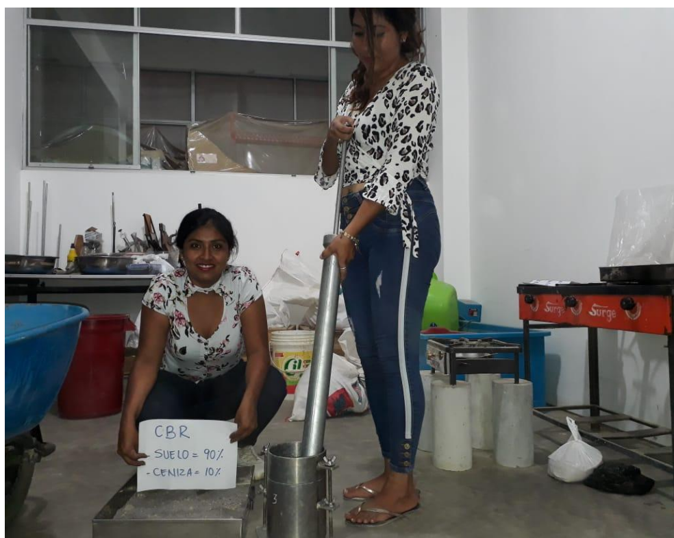
Figura 59. Realizando CBR con ceniza al 10%
