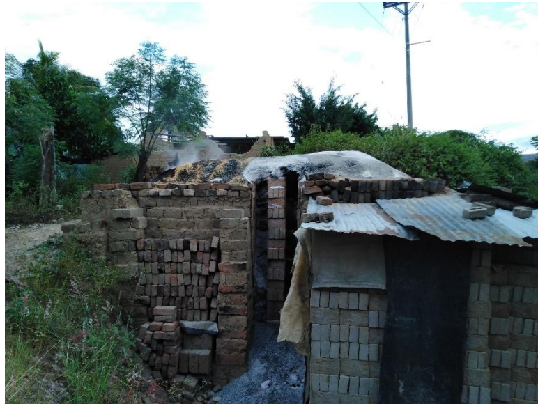
Figura 4. Quemado de la cáscara de arroz para la obtención de la ceniza
