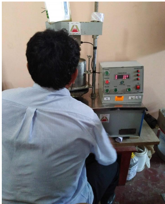
Figura 63. Realizando el ensayo de penetración
