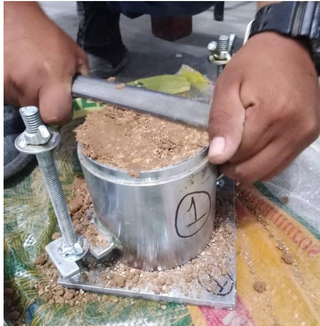
Figura 53. Realizando el enrasamiento al molde
