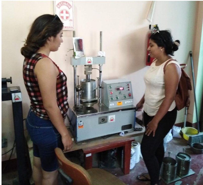
Figura 62. Colocando el molde para hacer el ensayo de penetración
