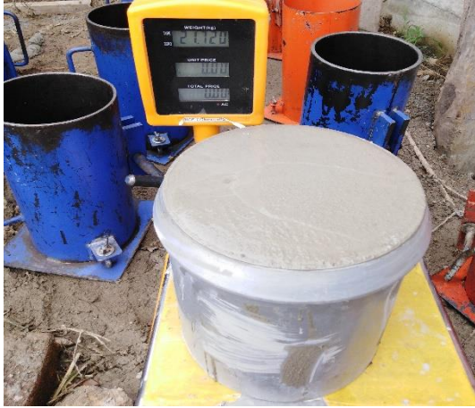
Figura 132. Peso del concreto + molde = 21720 gr. Figura 133. Contenido de aire = 1.7%
