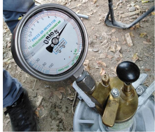
Figura 72. Peso del concreto + molde = 22180 gr. Figura 73. Contenido de aire = 1.6 %
