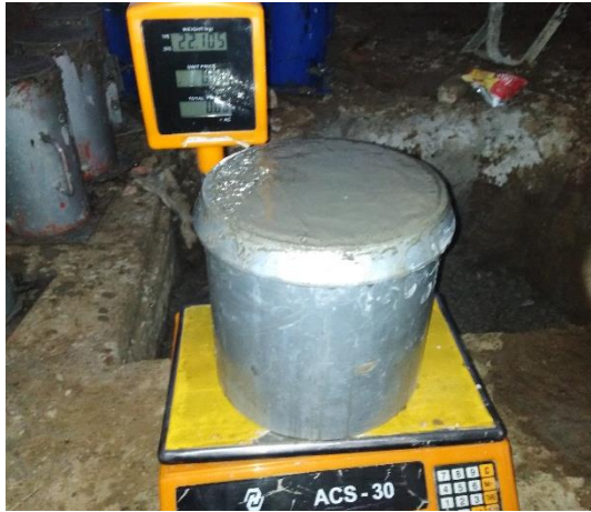
Figura 96. Peso del concreto + molde = 22105 gr. Figura 97. Contenido de aire = 1.7%
