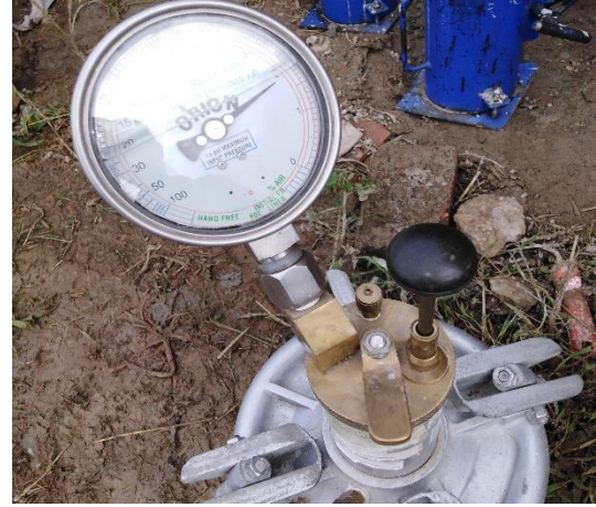
Figura 156. Peso del concreto + molde = 22735 gr. Figura 157. Contenido de aire = 1.8%
