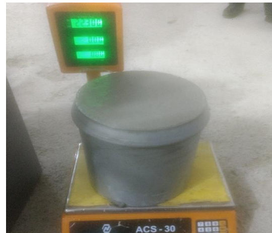
Figura 41. Pesado del concreto = 22300gr.
