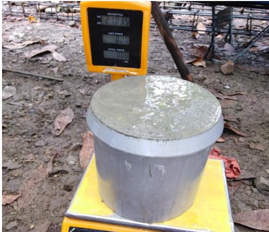
Figura 84. Peso del concreto + molde = 21835 gr. Figura 85. Contenido de aire = 1.7%
