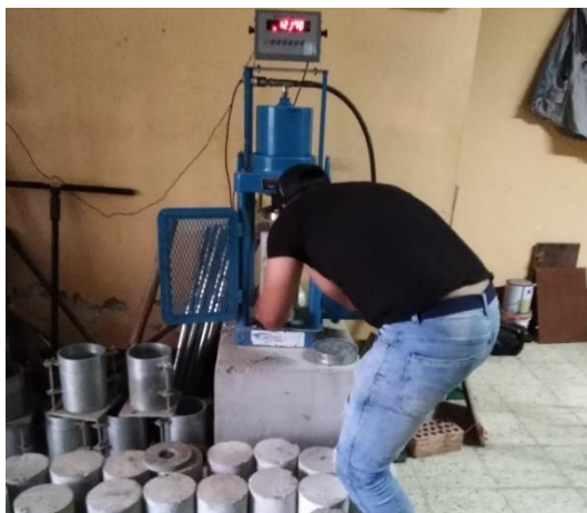
Figura 28. Figura 29. Rotura de testigos de concreto a los 7 días.
