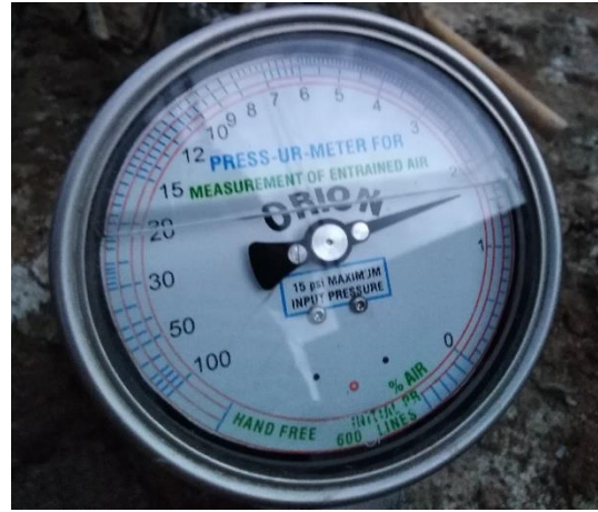
Figura 96. Peso del concreto + molde = 22105 gr. Figura 97. Contenido de aire = 1.7%
