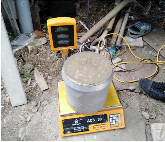
Figura 72. Peso del concreto + molde = 22180 gr. Figura 73. Contenido de aire = 1.6 %
