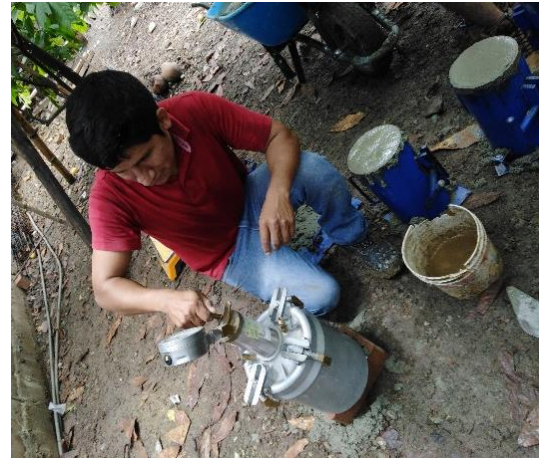
Figura 84. Peso del concreto + molde = 21835 gr. Figura 85. Contenido de aire = 1.7%
