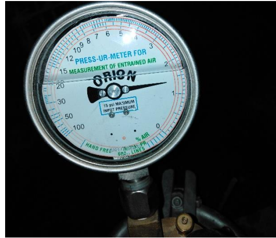
Figura 108. Peso del concreto + molde = 22075 gr. Figura 109. Contenido de aire = 1.4%
