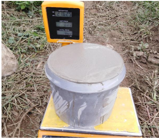
Figura 156. Peso del concreto + molde = 22735 gr. Figura 157. Contenido de aire = 1.8%
