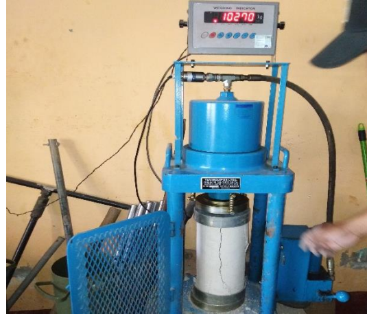
Figura 30. Figura 31. Rotura de testigos de concreto a los 14 días.
