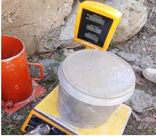
Figura 180. Peso del concreto + molde = 21175 gr. Figura 181. Contenido de aire = 2.4%
