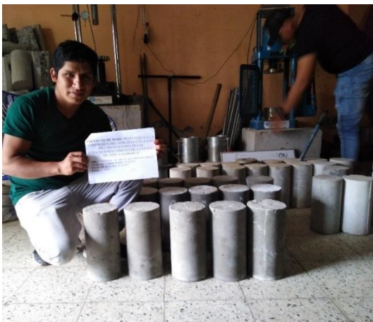
Figura 32. Figura 33. Rotura de testigos de concreto a los 28 días.
