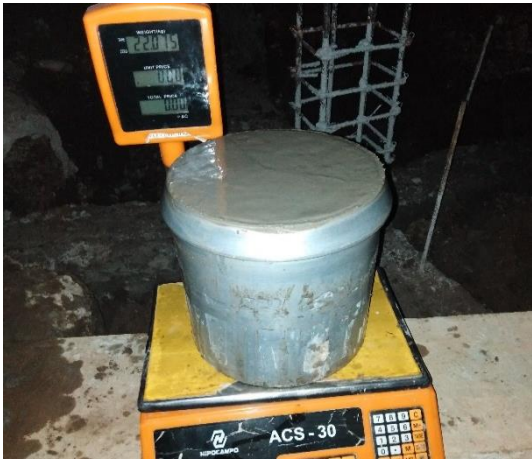
Figura 108. Peso del concreto + molde = 22075 gr. Figura 109. Contenido de aire = 1.4%
