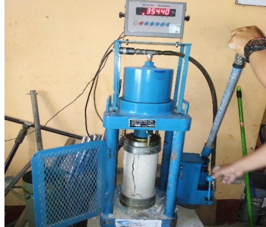
Figura 32. Figura 33. Rotura de testigos de concreto a los 28 días.
