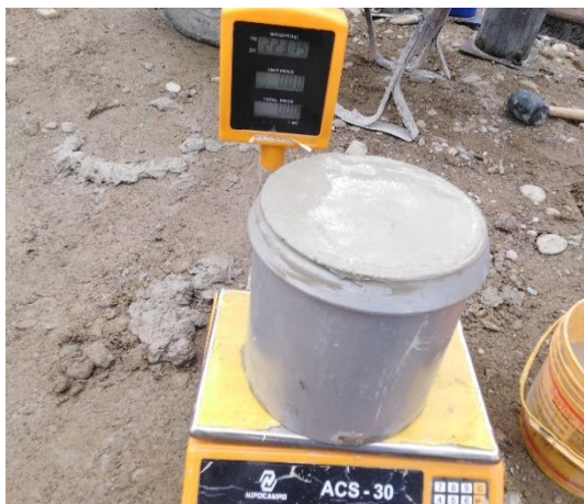
Figura 144. Peso del concreto + molde = 22735 gr. Figura 145. Contenido de aire = 1.4%
