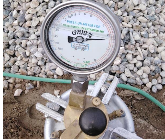
Figura 132. Peso del concreto + molde = 21720 gr. Figura 133. Contenido de aire = 1.7%
