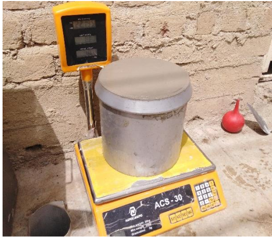
Figura 168. Peso del concreto + molde = 22195 gr. Figura 169. Contenido de aire = 1.1%
