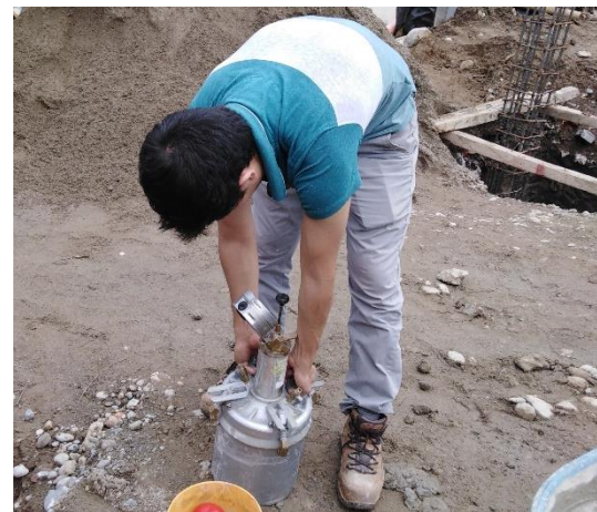
Figura 20. Figura 21. Ensayo para medir al contenido de aire del concreto.
