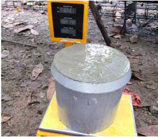
Figura 18. Figura 19. Pesado del concreto para calcular el peso unitario del concreto.
