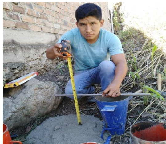
Figura 16. Figura 17. Ensayo para medir el asentamiento del concreto (Slump).
