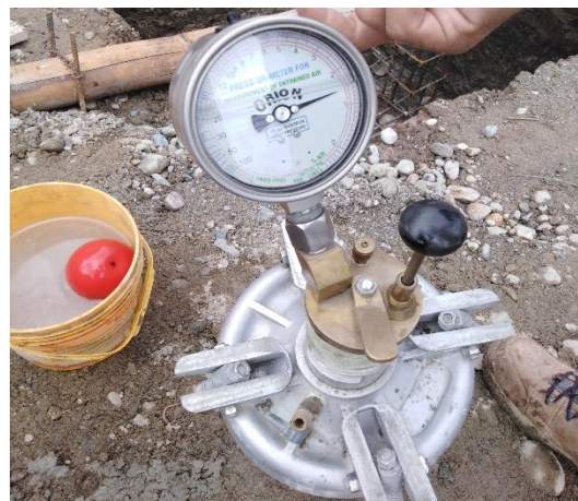
Figura 144. Peso del concreto + molde = 22735 gr. Figura 145. Contenido de aire = 1.4%
