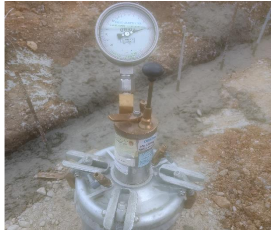
Figura 120. Peso del concreto + molde = 22360 gr. Figura 121. Contenido de aire = 2.1%
