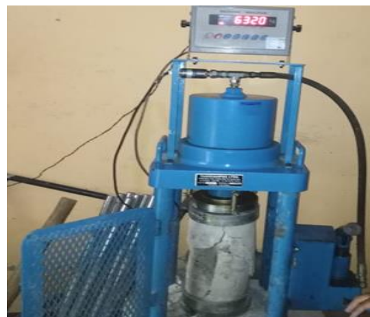
Figura 28. Figura 29. Rotura de testigos de concreto a los 7 días.
