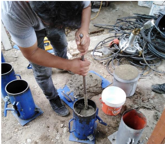
Figura 74. Elaboración de testigos de concreto. Figura 75. Curado de testigos de concreto.
