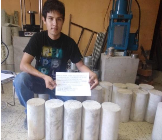
Figura 30. Figura 31. Rotura de testigos de concreto a los 14 días.
