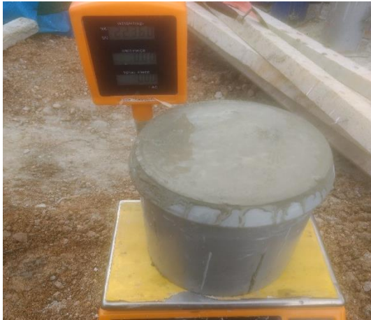
Figura 120. Peso del concreto + molde = 22360 gr. Figura 121. Contenido de aire = 2.1%
