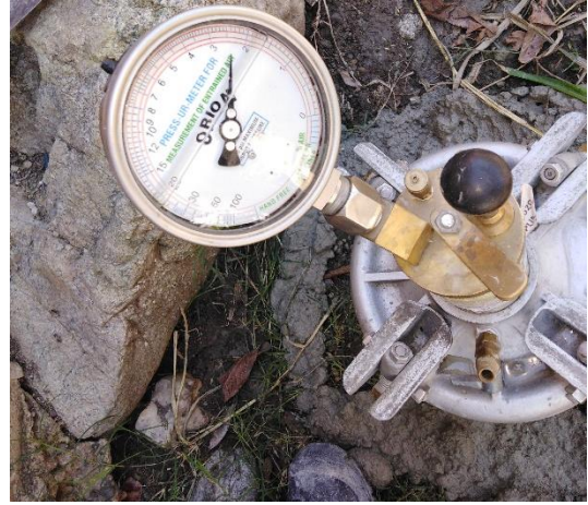
Figura 180. Peso del concreto + molde = 21175 gr. Figura 181. Contenido de aire = 2.4%
