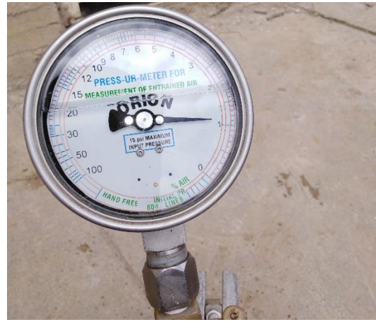
Figura 168. Peso del concreto + molde = 22195 gr. Figura 169. Contenido de aire = 1.1%
