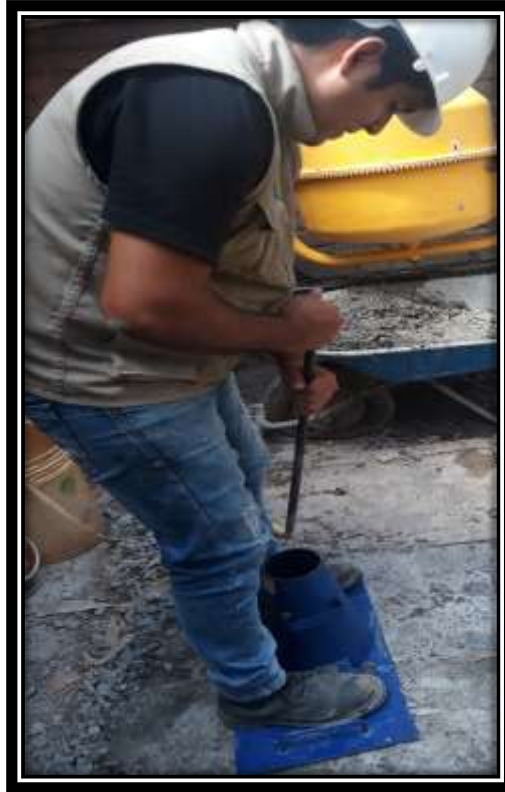
Ilustración 13: Ensayo para la medición del Slump
