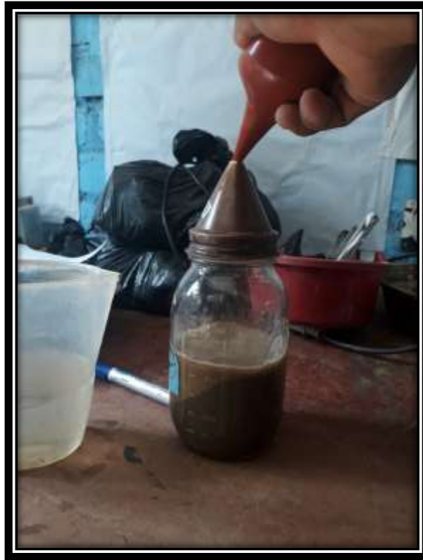
Ilustración 7: Picnómetro utilizado para ensayo de peso específico y absorción de los agregados mediante método gravimétrico
