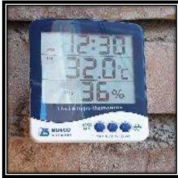
Ilustración 11: Toma de lectura de temperatura ambiental durante la fabricación del concreto
