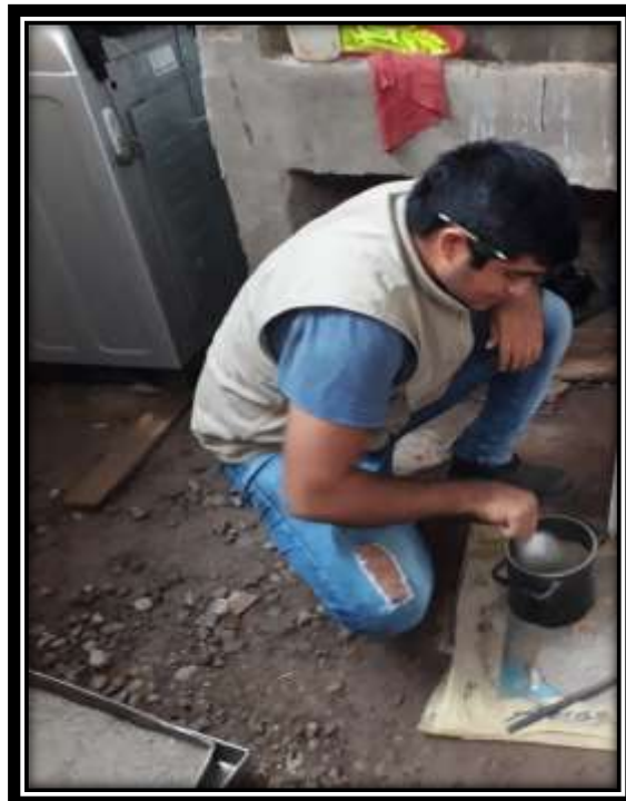
Ilustración 8: Ensayo de peso unitario suelto del agregado fino
