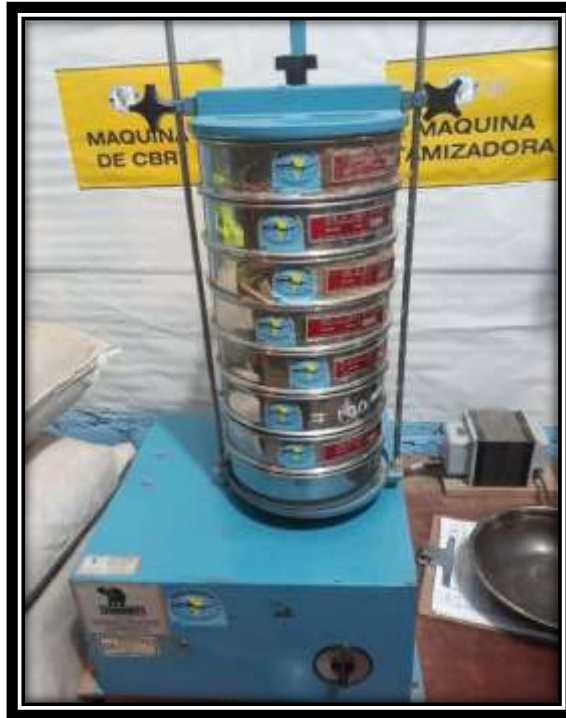
Ilustración 5: Análisis granulométrico del agregado fino
