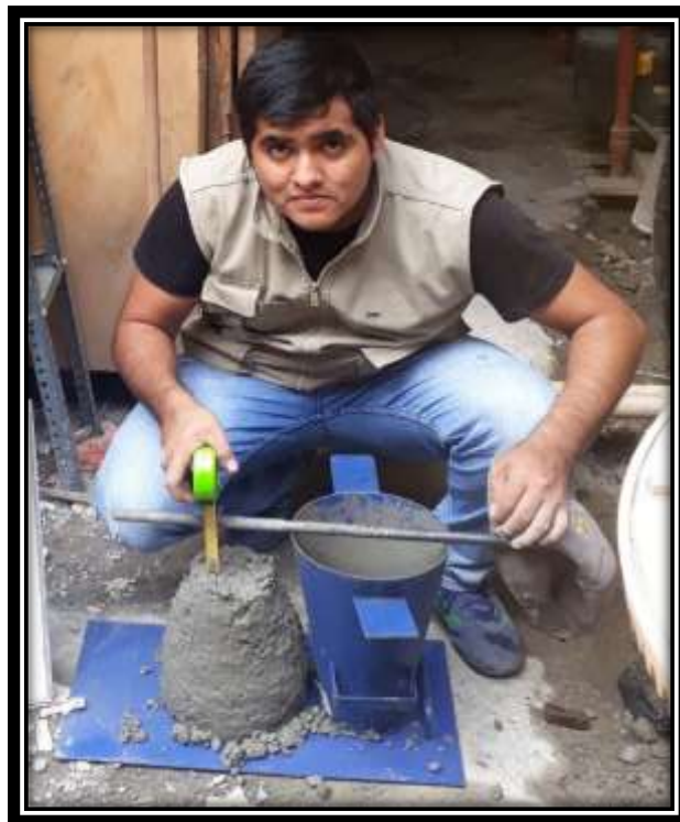
Ilustración 14: Medición de Asentamiento del concreto o Slump
