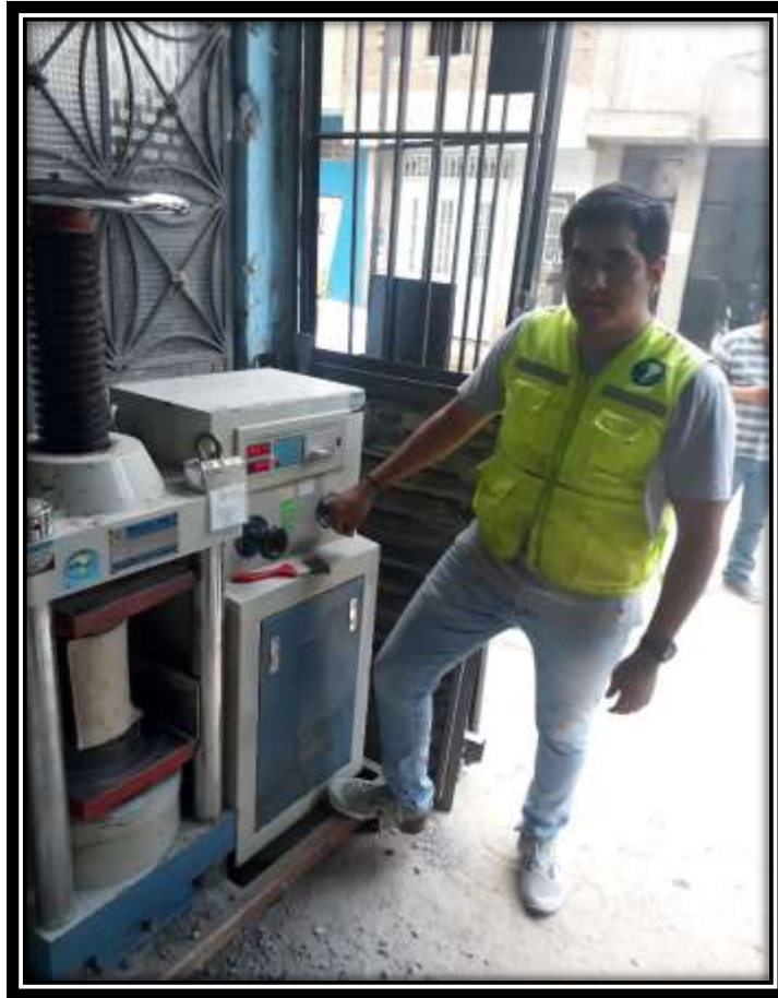
Ilustración 17: Rotura de los especímenes de concreto
