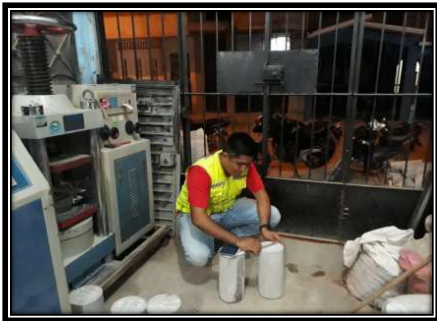
Ilustración 16: Medición de las dimensiones de los especímenes de concreto
