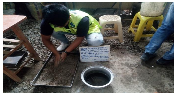
Mezclado de agua, extracto de tallo de plátano y suelo
