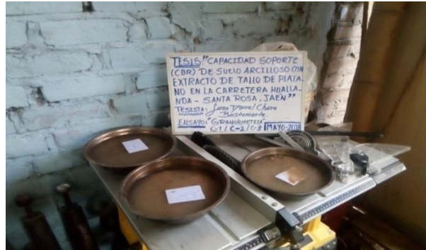
Remojado de muestra de suelo
