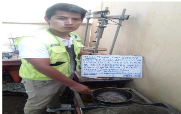
Secado de muestra de suelo
