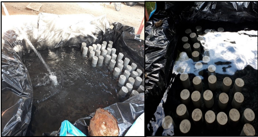
Figura 29. Curado normal de testigos cilíndricos de concreto.
