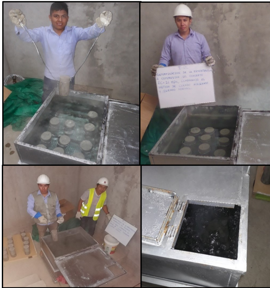
Figura 32. Colocado de testigos en el tanque de curado acelerado.
