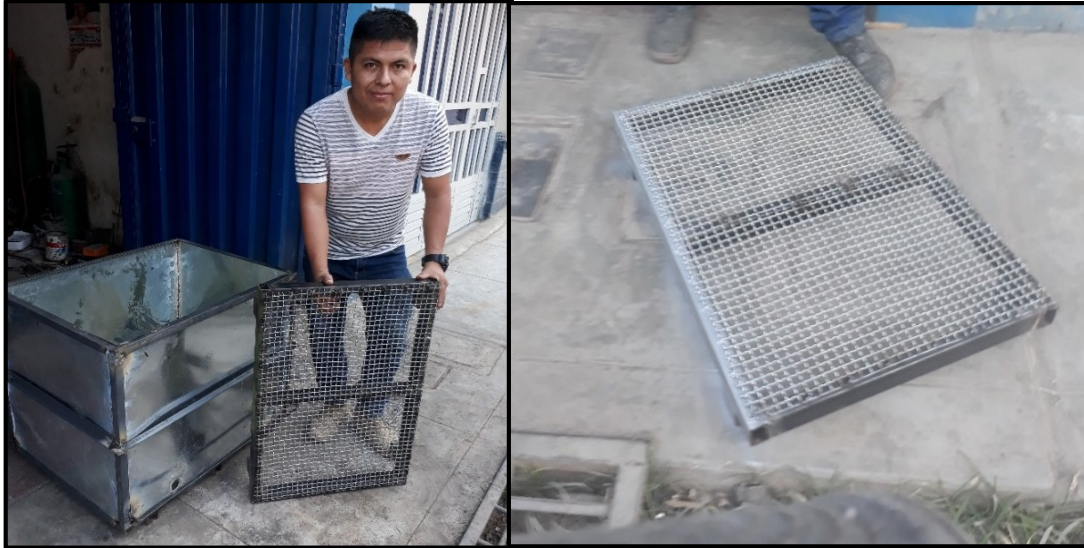
Figura 5. Construcción de parrilla para soporte de los testigos de concreto.
