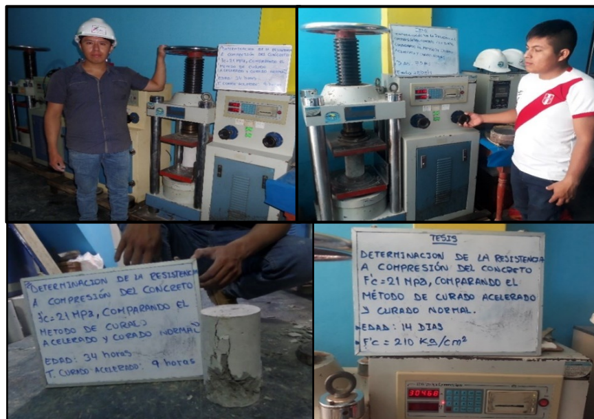
Figura 34. Ensayo a compresión de testigos cilíndricos.
