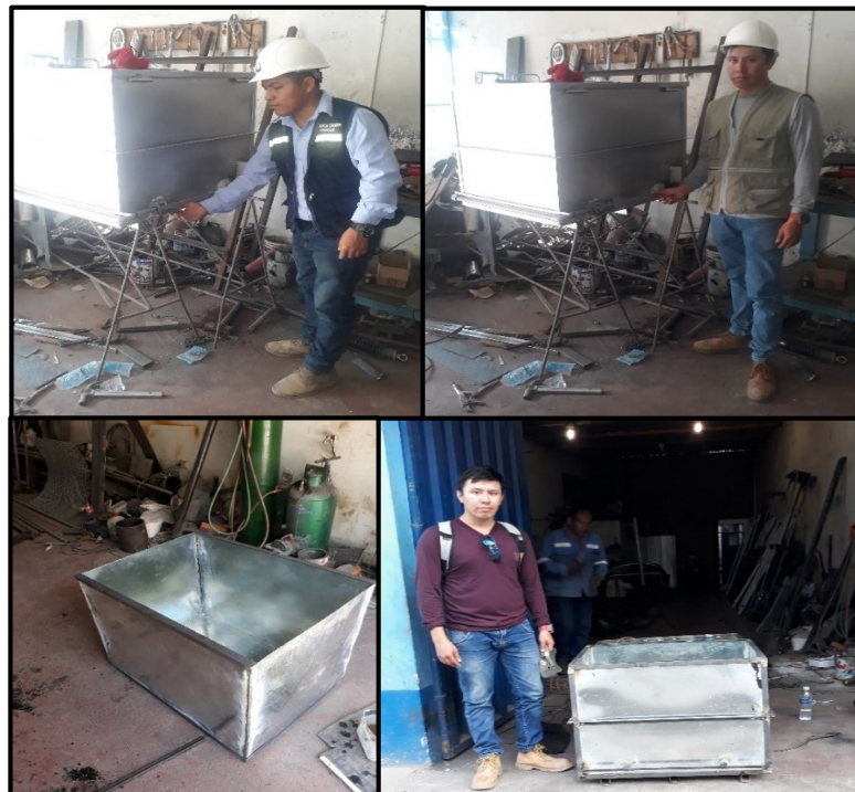
Figura 4. Construcción del tanque de curado acelerado.
