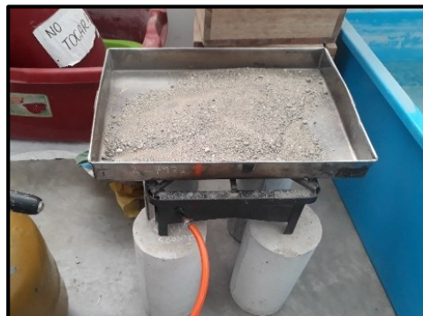
Figura 18. Secado a estufa para determinar el contenido de humedad del agregado fino.
