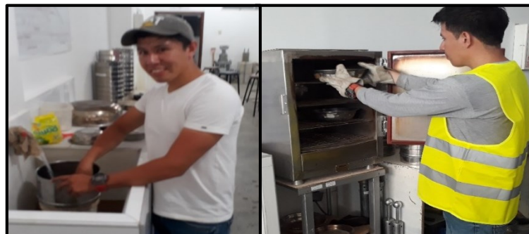
Figura 14. Cantidad de material fino que pasa el tamiz N° 200
