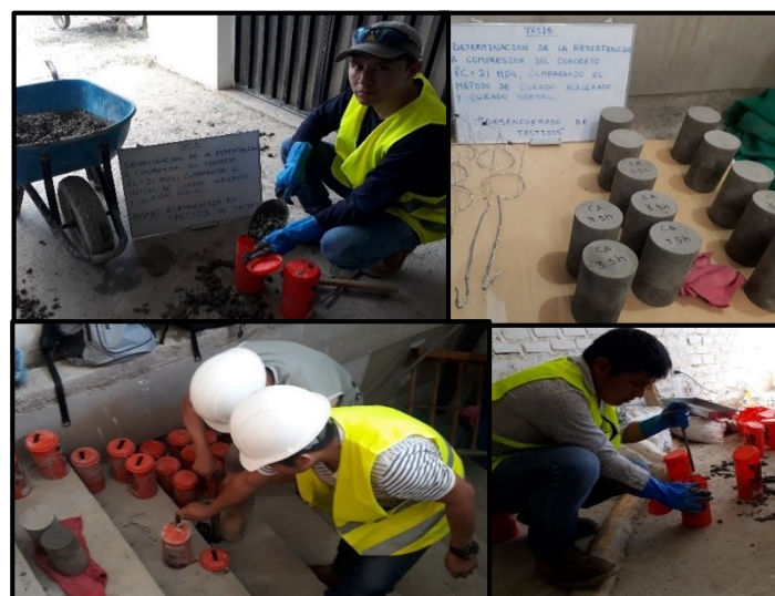
Figura 28. Elaboración de testigos de concreto.
