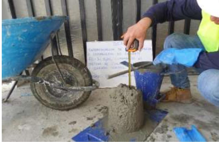
*Figura 47. Ensayo de trabajabilidad del concreto fresco – Slump.*
