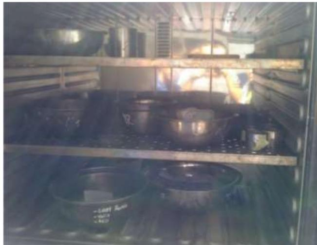
*Figura 44. Secado de muestras en el horno del agregado grueso.*
