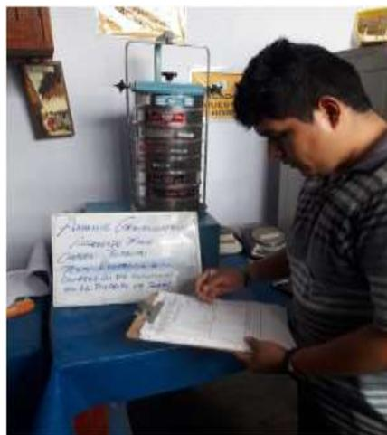
Figura 32. Análisis granulométrico
