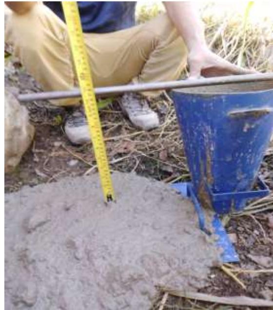
*Figura 17. Medición de slump      Figura 18. Ensayo para medir el asentamiento del concreto (Slump)*
