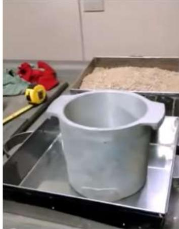
*Figura 33. Peso unitario y vacío de los agregados finos N° 200*
