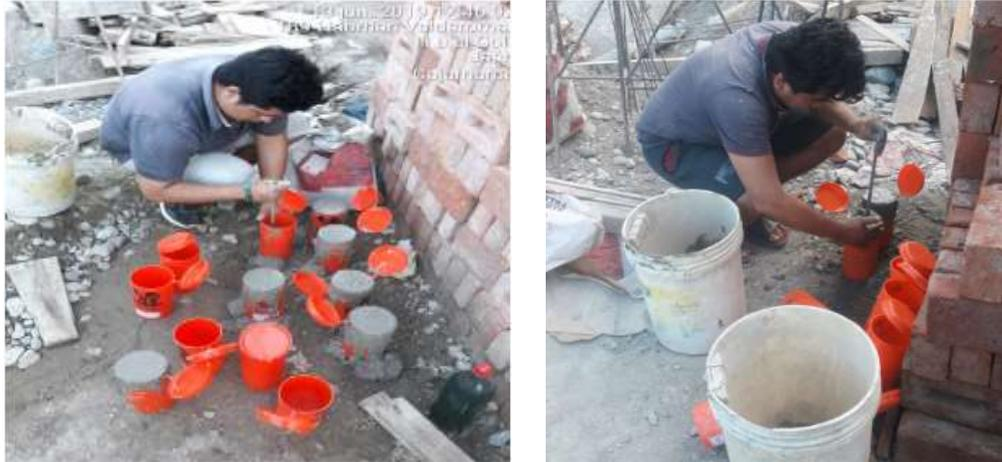
*Figura 20. llenado de moldes      Figura 19. Elaboración de especímenes de concreto*
