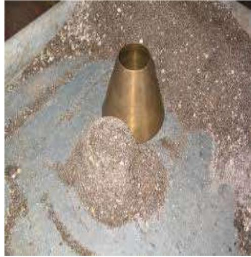
Figura 35. Absorción de los agregados finos    Figura 34. Gravedad específica
