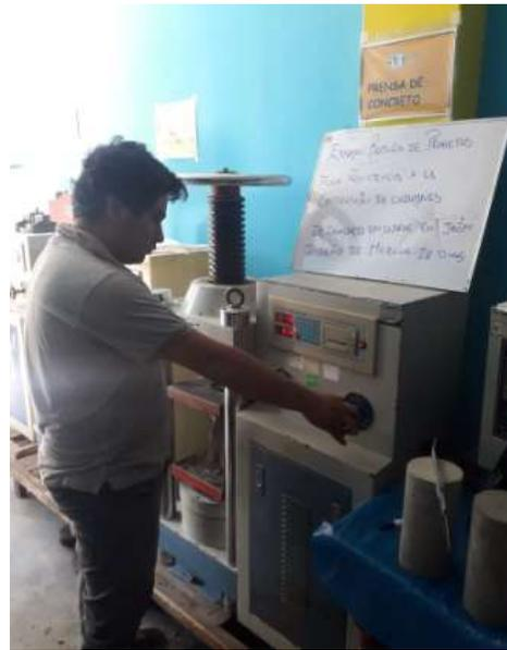
Figura 48. rutura de testigos. Figura 49. Ensayo a compresión de testigos cilíndricos con diseño de mezcla.
