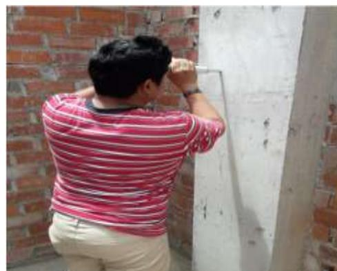
Figura 25. Esclerometría      Figura 26. Ensayo para determinar la resistencia del concreto endurecido.
