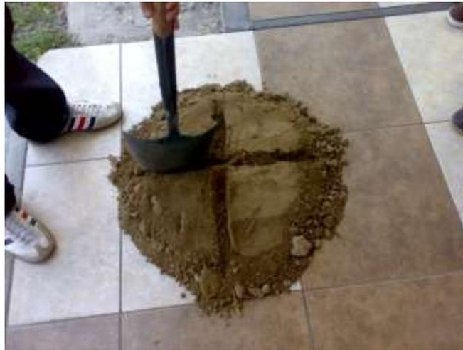
Figura 30. Cuarteo de agregado fino.
