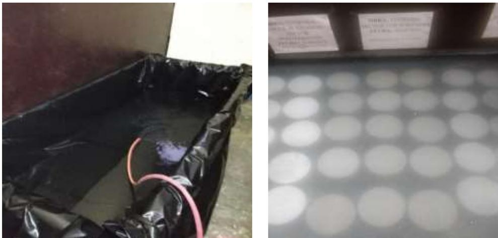
*Figura 21. llenado dl estanque      Figura 22. Elaboración de especímenes de concreto*
